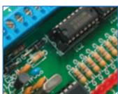
Cette commande à distance est pourvue de dix sorties à collecteurs ouverts. Le récepteur et l'émetteur communiquent entre eux à travers une paire (type téléphone) par laquelle passe également l'alimentation du TX. Grâce à l'utilisation d'un système à boucle de courant, le dispositif est assez insensible aux perturbations, ce qui permet ne portée de plus de 50 mètres.
