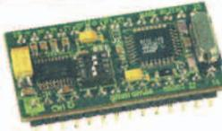
3 PWM; 8 A/N 10/8 bits; SPI; Chien de garde Temporisateur; 23 lignes d' E/S TTL; RS 232 ou TTL; 1 LED d'état; Commutateur DIP de configuration; etc. Alimentation de 2,7V à 5,5V.
