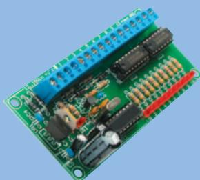
Cette commande à distance est pourvue de dix sorties à collecteurs ouverts. Le récepteur et l'émetteur communiquent entre eux à travers une paire (type téléphone) par laquelle passe également l'alimentation du TX. Grâce à l'utilisation d'un système à boucle de courant, le dispositif est assez insensible aux perturbations, ce qui permet une portée de plus de 50 mètres. Le kit comprend l'émetteur et le récepteur.
