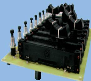
C'est un contrôleur au standard DMX à huit canaux (8 potentiomètres à glissière) en mesure de contrôler l'intensité lumineuse de huit variateurs de puissance. De nombreux effets lumineux préprogrammés peuvent en outre être appelés au moyen de neuf poussoirs. Une procédure simple de programmation permet de donner aux huit canaux une adresse DMX comprise entre 1 et 512.
