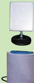
Cette antenne directive patch offre un gain de 8,5 dB. Elle s'utilise en réception aussi bien qu'en émission et permet d'augmenter considérablement la portée des dispositifs RTX travaillant sur des fréquences. Ouverture angulaire: 70° (horizontale), 65° (verticale). Gain: 8,5 dB. Câble de connexion: RG58. Connecteur: SMA. Impédance: 50 Ω. Dim.: 54 x 120 x 123 mm. Poids: 260 g.
