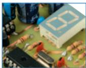
Ce circuit fort simple mémorise et reproduit jusqu'à neuf mélodies au format des sonneries pour téléphones mobiles que l'on peut télécharger sur l'Internet sous forme de fichier de texte. L'appareil communique avec votre ordinateur par le port série et, grâce à un petit logiciel pour Windows, il est possible de gérer la reproduction comme la mémorisation des mélodies.
