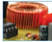
Ce variateur de lumière électronique permet de régler l'intensité lumineuse d'une ampoule à incandescence simplement en effleurant deux plaques métalliques qui se substituent au traditionnel potentiomètre. L'intensité lumineuse choisie est mémorisée puis rappelée à chaque allumage. Grâce à une fonction particulière (fonction «soft»), le circuit est également en mesure d'allumer ou d'éteindre graduellement l'ampoule.
