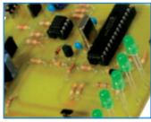
Ce variateur, contrôlable par protocole DMX, dispose d'une sortie 0 à 10 Vcc pour le couplage aux systèmes de puissance, mais il peut en outre héberger un module spécial pour le contrôle direct de charges alimentées par le secteur 230 V. Une barre de LED indique la valeur prise par la sortie et l'adresse peut être facilement choisie, parmi les 512 que le DMX propose, à l'aide d'un dip-switch.
