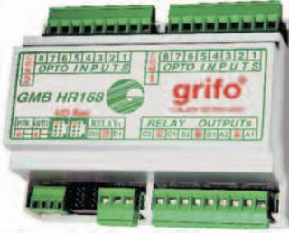
Le **GMB HR168** est fondamentalement un module à Barre DIN en mesure d'accueillir une CPU **grifo® Mini-Module** de type **GMM à 40 broches**. Elle dispose de 16 entrées Galvaniquement isolées pour les signaux **NPN** ou **PNP**; 8 Relais de 5
