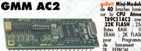
**grifo® Mini-Module** de 40 broches basée sur la **CPU Atmel T89C51AC2** avec **32K FLASH**; 256 Bytes RAM; 1K ERAM; 2K FLASH pour Programme de lancement; 2K EEPROM; 3 Temporisateurs Compteurs et 5 sections de Temporisateur Compteur à haute fonctionnalité (PWM, chien de garde, comparaison); 32 lignes d'E/S TTL; 8 A/N 10 bits; RS 232 ou TTL; 2 LEDs d'état; Commutateur DIP de configuration; etc.
