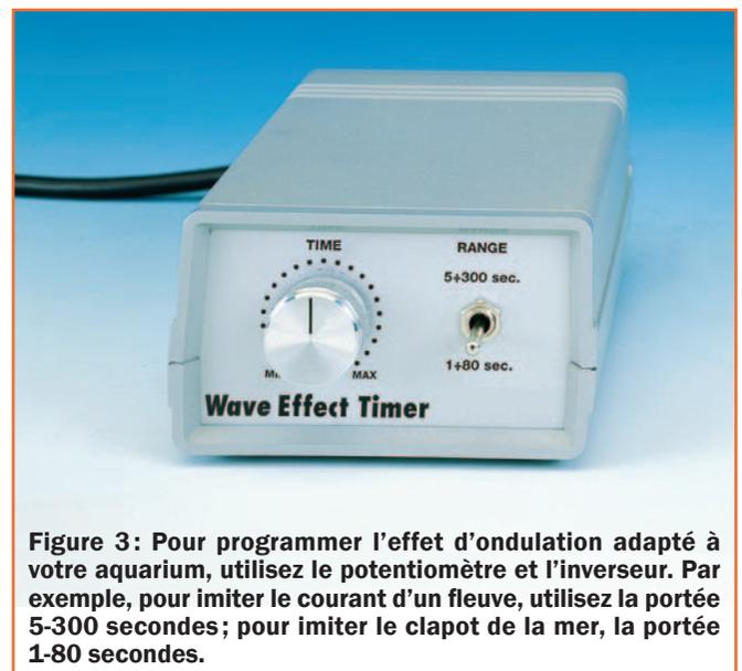
**Figure 3:** Pour programmer l'effet d'ondulation adapté à votre aquarium, utilisez le potentiomètre et l'inverseur. Par exemple, pour imiter le courant d'un fleuve, utilisez la portée 5-300 secondes ; pour imiter le clapot de la mer, la portée 1-80 secondes.
