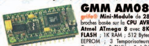
**grifo® Mini-Module** de 28 broches basée sur la **CPU AVR Atmel ATmega 8** avec **8K FLASH**; 1K RAM; 512 Bytes EEPROM; 3 Temporisateurs Compteurs, 3 PWM; 8 A/N 10/8 bits; SPI; Chien de garde Temporisateur; 23 lignes d'E/S TTL; RS 232 ou TTL; 1 LED d'état; Commutateur DIP de configuration; etc. Alimentation de 2,7V à 5,5V.
