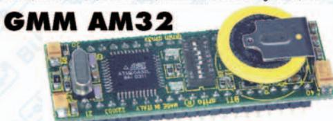
**grifo® Mini-Module** de 40 broches basée sur la **CPU AVR Atmel ATmega 32L** avec **32K FLASH**; 2K RAM; 1K EEPROM; JTAG; 3 Temporisateurs Compteurs; 4 PWM, 8 A/N 10 bits; SPI; Chien de garde Temporisateur; 32 lignes d'E/S TTL; RS 232 ou TTL; 1 LED d'état; Commutateur DIP de configuration; etc. Alimentation de 2,7V à 5,5V.
