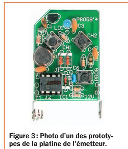
Figure 3: Photo d'un des prototypes de la platine de l'émetteur.
