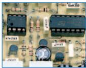
Il manque peut-être à votre station centrale météorologique un dispositif capable d'activer une sortie à relais quand le vent dépasse une certaine vitesse programmable : nous l'avons appelé «anémostat» essentiellement pour le distinguer de notre autre anémomètre EN1606 publié dans notre numéro 72.
