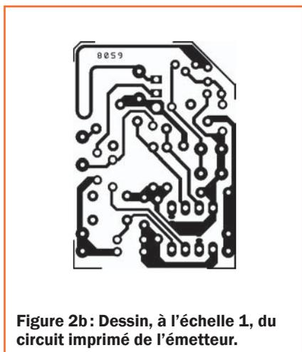
Figure 2b: Dessin, à l'échelle 1, du circuit imprimé de l'émetteur.
