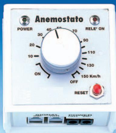
Figure 7: Photo d'un des prototypes de l'anémostat installé dans son boîtier plastique. Le couvercle ou face avant comporte le potentiomètre R9 permettant de paramétrer le seuil d'intervention du relais de sortie, ainsi que le poussoir de "reset" et les deux LED de signalisation.
