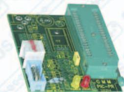
**D9** pour la connexion à la **RJ12** pour **MPLAB**; connecteur à 10 broches pour la connexion au **Programmeur MP PIK+**; connecteur pour la section alimentateur; 2 LEDs; etc.
