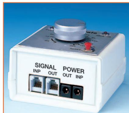
Figure 9: Photo d'un des prototypes de l'anémostat installé dans son boîtier plastique fermé. Les E / S, sur le côté, sont directement montées sur le circuit imprimé (RJ45 et jacks).
