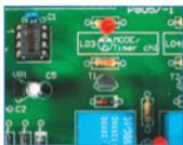
La commande à distance se fait ici par radio sur 433,92 MHz pour une sécurité maximale. Le récepteur peut gérer jusqu'à 31 émetteurs et il comporte deux sorties indépendantes pouvant fonctionner en mode bistable ou en impulsif. Le couplage du TX et du RX suit une procédure simple d'auto-apprentissage des codes.
