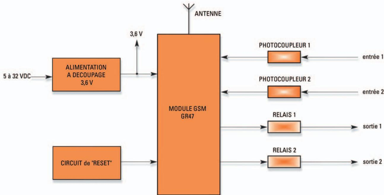
Le système se compose d'un module GSM / GPRS à microcontrôleur interne, d'une alimentation à découpage avec tension d'entrée de 5 à 32 VDC, d'un circuit de "reset" et de deux E / S.
