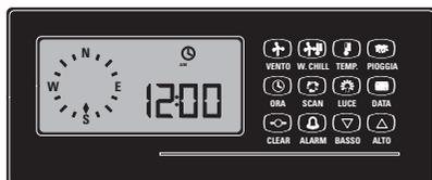
Figure 10: A la mise sous tension de la centrale, la rose des vents apparaît à l'écran (elle indique les points cardinaux Nord, Sud, Est et (W) Ouest), ainsi que le symbole de l'horloge (avec l'indication AM: matin ou avant midi) et l'heure au format anglo-saxon (ici il est 12:00 AM, soit midi, avec PM ce serait minuit).
