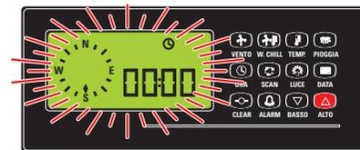
Figure 18: Pour régler l'heure exacte, pressez la touche ALTO et maintenez-la pressée jusqu'à ce que l'afficheur cesse de clignoter. Vous pouvez alors modifier les nombres avec les touches ALTO et BASSO.
