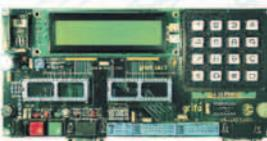
connecteurs rectangulaires D9 pour la connexion à la ligne sérielle en RS 232; connecteurs 10 broches pour la connexion à la AVR **ISP**; clavier à 16 touches; écran LCD rétroéclairé, de 20 caractères pour 2 lignes; Buzzer; connecteurs et sections d'alimentation; touches et LED pour la gestion des E/S numériques; etc.
