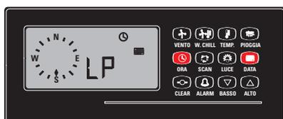
Figure 11: Pour régler l'année, pressez ensemble les touches ORA (HEURE) et DATA (DONÉE). A l'écran, les symboles de l'horloge et du calendrier, ainsi que les lettres LP apparaissent (LP sera remplacé par un nombre indiquant l'année courante).
