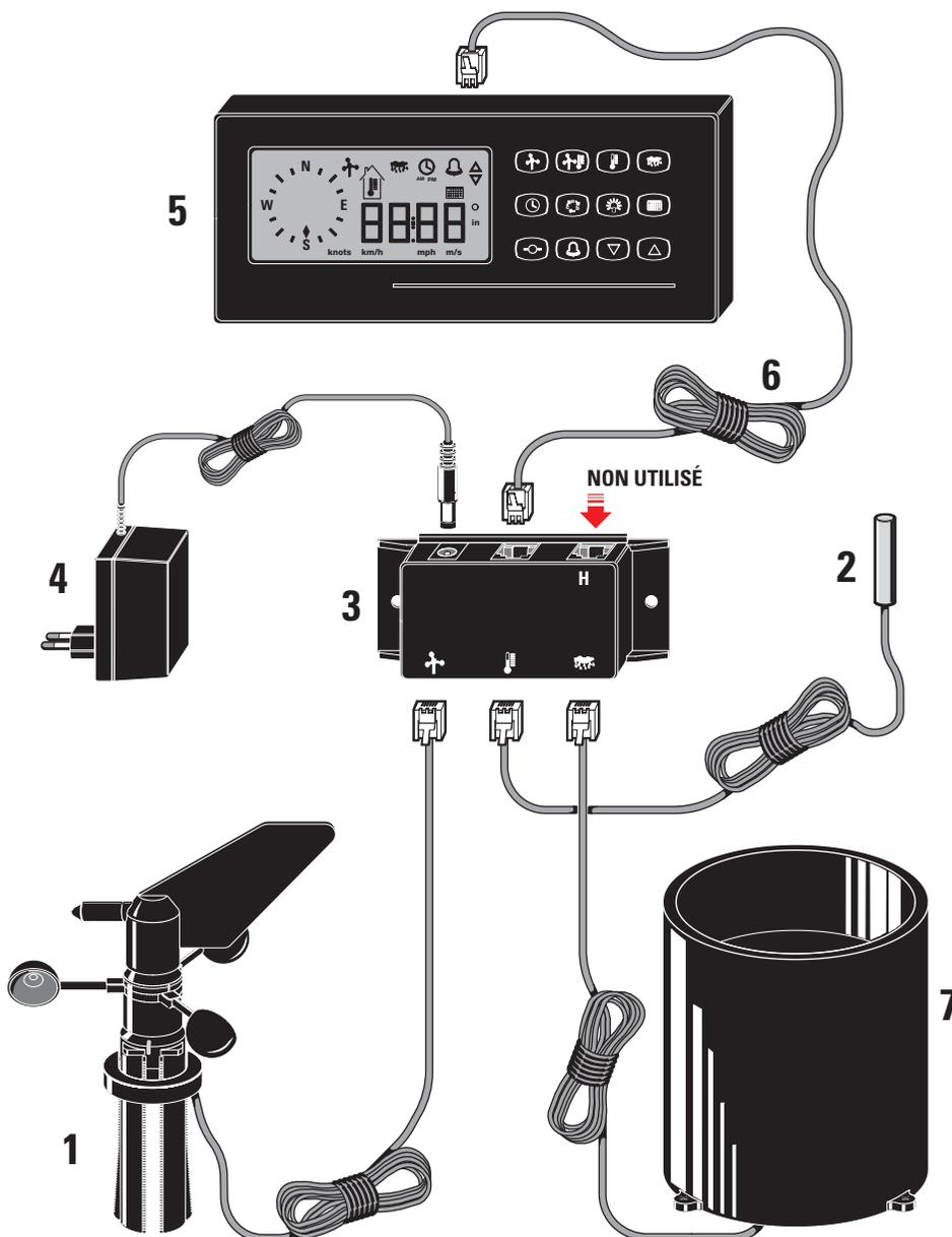
**Figure 8: La centrale (5) avec les éléments périphériques dont le capteur de température (2), de direction et de vitesse du vent (anémomètre 1) et de pluie (pluviomètre 7); on repère aussi le boîtier central d'interconnexion (3), son câble de liaison à la centrale (6) et l'alimentation bloc secteur 230 V (4). Attention, ne pas utiliser le port H pour le moment.**
