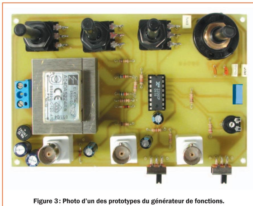
Figure 3: Photo d'un des prototypes du générateur de fonctions.
