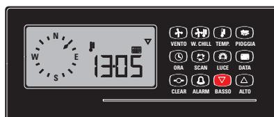
**Figure 45:** Puis pressez et relâchez la touche BASSO. L'écran affiche la date courante, le symbole du calendrier et un triangle tourné vers le bas (indication de température minimale)
