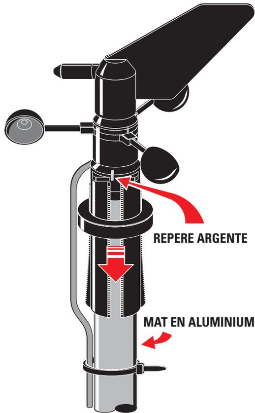
Figure 37 : Au moment de fixer l'anémomètre sur le mât en aluminium, ayez soin d'orienter la marque argentée présente sur le capteur exactement vers le Nord (utilisez une boussole ou un GPS).
