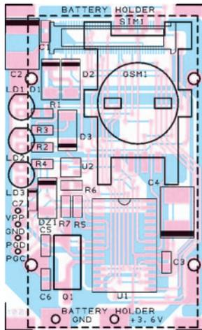
Figure 6a: Schéma d'implantation des composants du localiseur à distance GPS / GSM.
