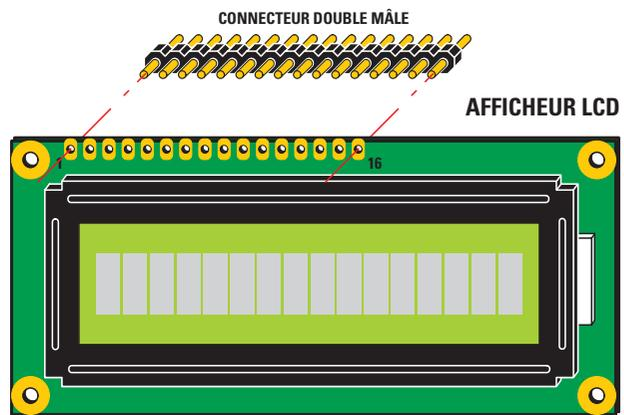
Figure 16: Le LCD est monté sur la platine afficheur EN1601 à l'aide d'un connecteur double mâle.
