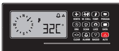
Figure 58: Pour entrer une nouvelle valeur d'alarme, pressez et maintenez la touche ALTO jusqu'à ce que l'afficheur cesse de clignoter. Vous pouvez alors modifier la valeur avec ALTO ou BASSO.
