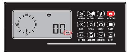
Figure 30: Si vous répétez cette opération, apparaît 0.0 mm (mm clignote). Cela signifie que la lecture des précipitations est en mm avec un pas de 0,1 mm.
