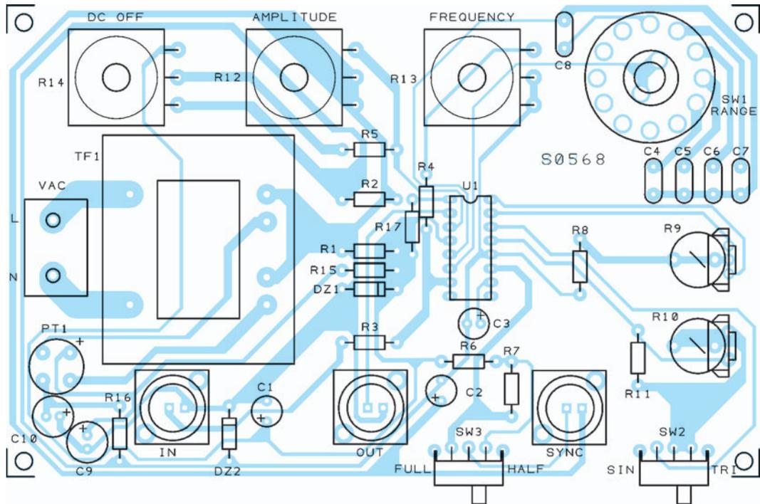
Figure 2a: Schéma d'implantation des composants du générateur de fonctions.
