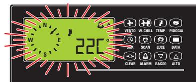
**Figure 52:** Si une alarme a été sélectionnée, quand la valeur actuelle dépasse la valeur paramétrée, la valeur actuelle et le symbole de l'alarme s'affichent en clignotant et le buzzer se fait entendre.
