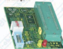
connecteur D9 pour la connexion à la AVR **ISP**; connecteur à 10 broches pour la connexion au Programmeur **MP PIK+**; connecteur pour la section alimentateur; 2 LEDs; ect..
