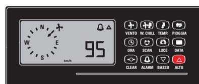
**Figure 55:** Pour introduire une nouvelle valeur d'alarme, pressez et maintenez la touche ALTO jusqu'à ce que l'afficheur cesse de clignoter. Pour modifier la valeur, pressez la touche ALTO ou BASSO.
