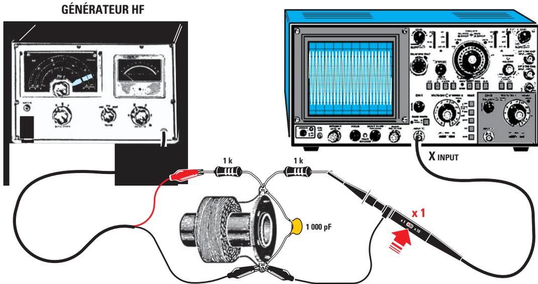
Figure 13: Pour connaître la fréquence d'accord  $F$  d'un bobinage (ici une self "nid d'abeille"), la meilleure solution consiste à utiliser le procédé des deux résistances de 1 k (voir figure 7); sans oublier de monter un condensateur  $C$  de 1 000 pF en parallèle. Pour trouver l'inductance  $L$  en  $\mu\text{H}$  ou en  $\text{mH}$ , utilisez la formule du tableau noir, figure 16.
