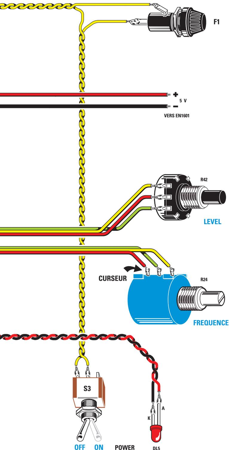
Figure 9a: Schéma d'implantation des composants de la platine principale EN1600 de l'audio-mètre. Étant donné que le commutateur rotatif S1 est un 3 voies 3 positions, prenez bien garde de ne pas vous tromper dans l'identification de la broche centrale C. Quant au potentiomètre multitour, le curseur correspond à la broche désignée par la flèche.
