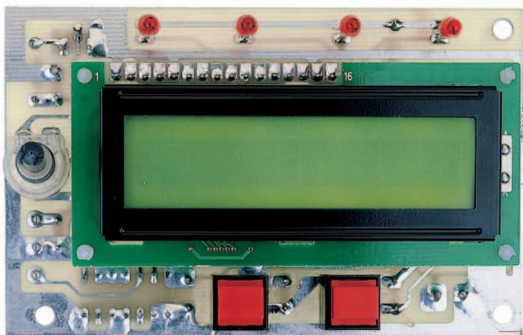
Figure 13: Photo d'un des prototypes de la platine afficheur EN1601, côté "soudures" sur lequel on a installé, grâce aux connecteurs mâles/femelles, le LCD.
