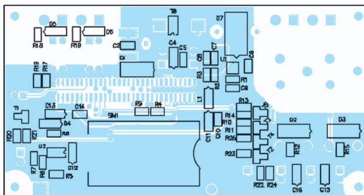
**Figure 3a-2: Schéma d'implantation des composants du contrôle à distance bidirectionnel GSM, côté soudures, où sont montés les CMS dont le porte-SIM.**
