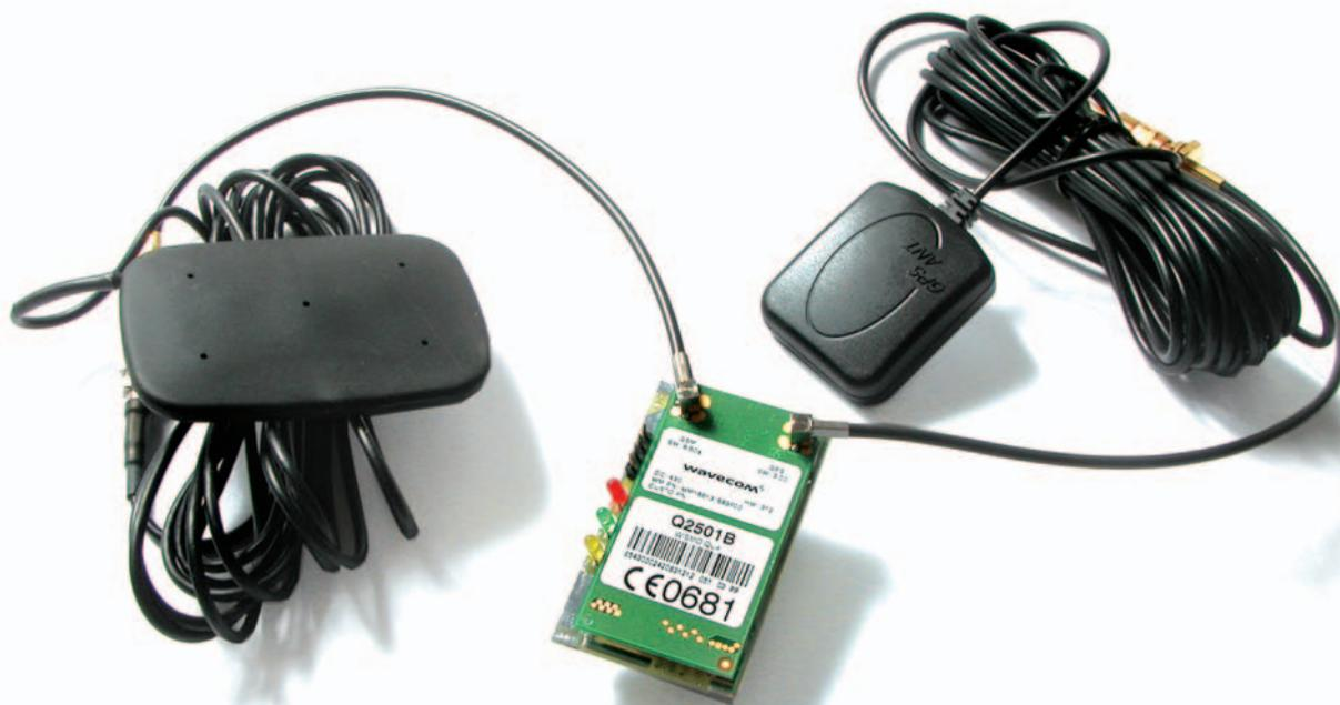
**Figure 3 : Le localiseur est disponible tout monté (si on choisit cette solution, on n'aura qu'à le coupler à ses deux antennes GPS et GSM).**
