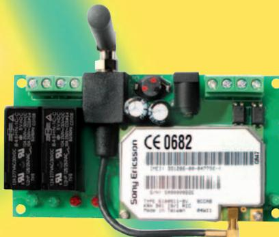
Universel, ce système de contrôle à distance comporte deux relais de sortie activables par SMS et de deux entrées photo-isolées utilisées pour envoyer des messages d'alarme, toujours par SMS, à n'importe quel téléphone mobile GSM. Il peut même servir d'ouvre-porte commandable par une simple sonnerie d'un -ou de plusieurs- téléphones mobiles préalablement habilités.
