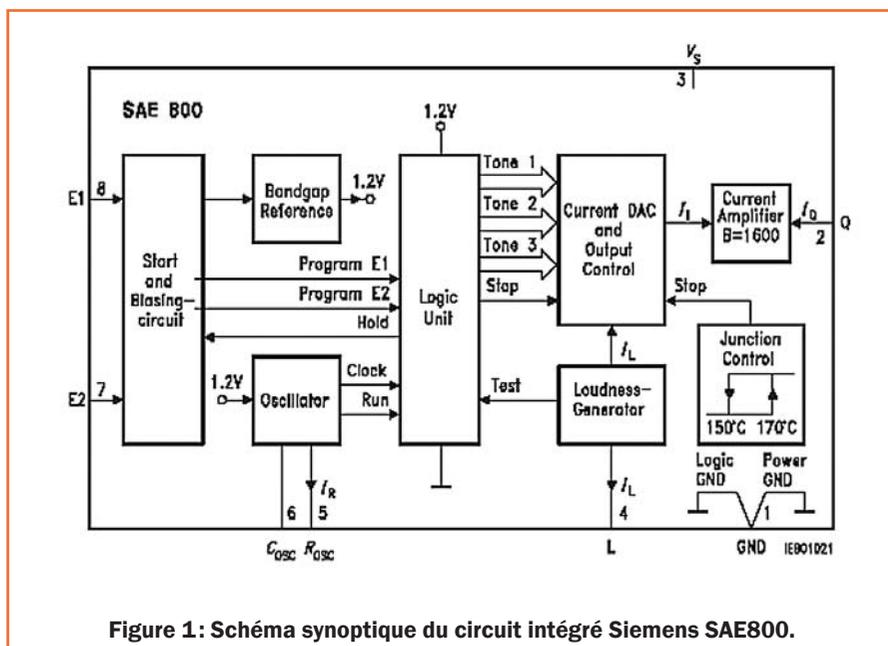
Figure 1: Schéma synoptique du circuit intégré Siemens SAE800.
