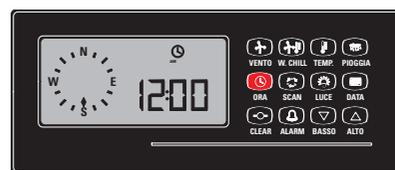
Figure 16: Pour régler l'heure, pressez la touche ORA et relâchez-la. Le symbole de l'horloge avec AM (ant-meridian, soit matin) ou PM (post-meridian, soit après-midi) du format anglo-saxon apparaissent.
