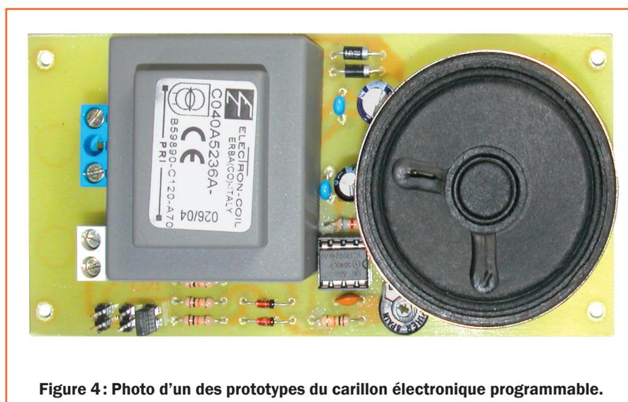
Figure 4: Photo d'un des prototypes du carillon électronique programmable.
