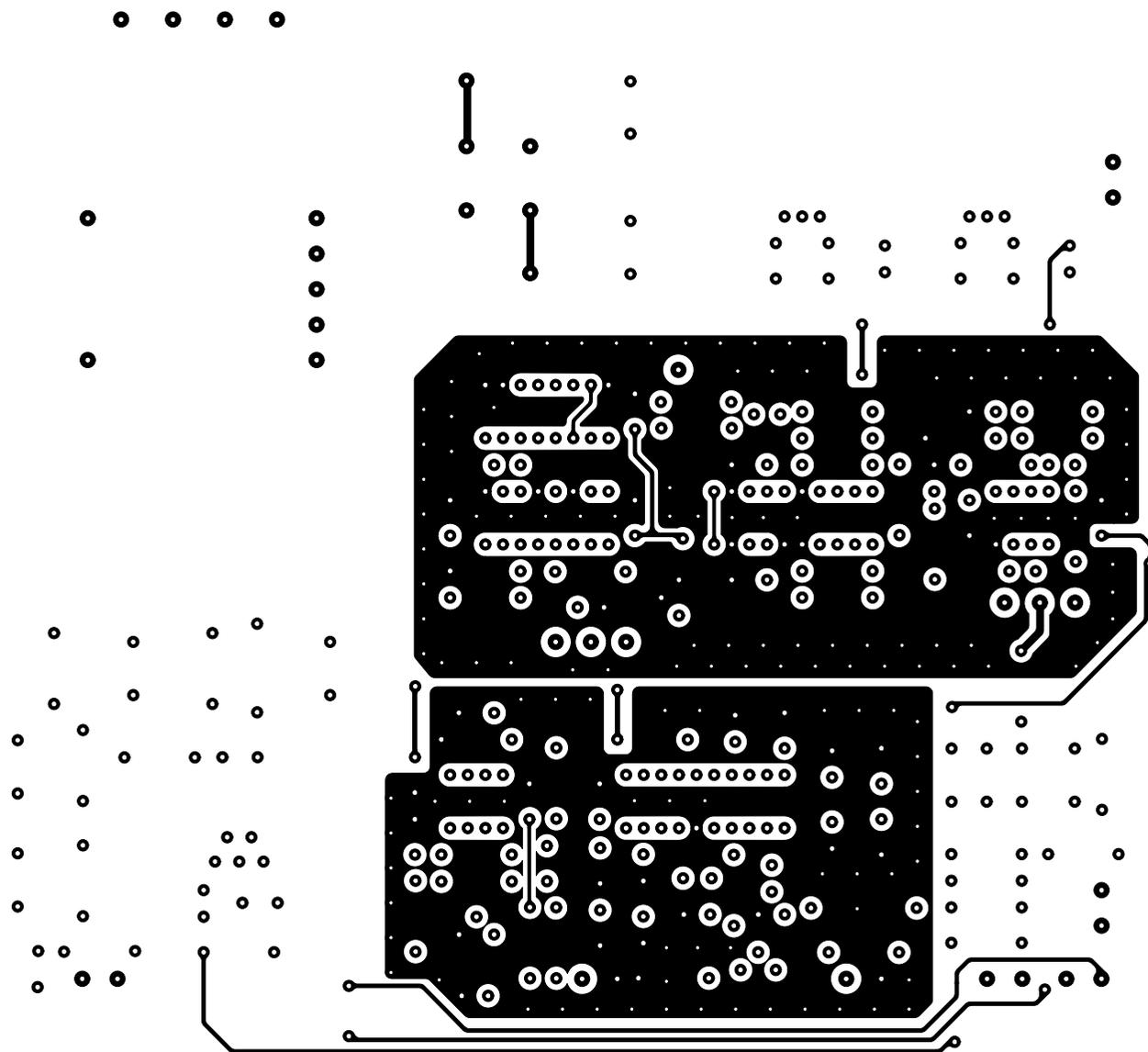
Figure 9b-2: Dessin, à l'échelles 1, du circuit imprimé double face à trous métallisés de la platine principale EN1600 de l'audiomètre, côté composants.
