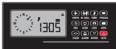
**Figure 41:** Puis pressez et relâchez la touche ALTO. L'écran affiche la date courante, le symbole du calendrier et un triangle tourné vers le haut (indication de température maximale)
