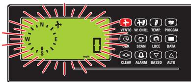
Figure 24: Pour changer l'unité de mesure de vitesse du vent, pressez la touche VENTO et maintenez-la pressée environ trois secondes jusqu'à ce que l'afficheur cesse de clignoter.
