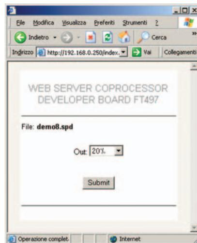
Figure 1: Démo 8 (exemple de gestion d'une sortie analogique : à travers un menu de choix, on sélectionne la tension désirée).
