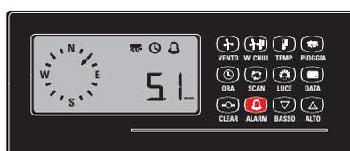
Figure 60: Pressez et relâchez maintenant la touche ALARM. Les symboles de l'alarme, de l'horloge et la valeur d'alarme actuelle s'affichent, ou alors la mention OFF apparaît (si aucune alarme n'a été programmée).
