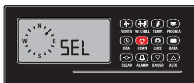
**Figure 51:** Pour activer le défilement, pressez la touche SCAN et maintenez-la jusqu'à ce que SEL cesse de clignoter. Pressez alors la touche de chacun des paramètres que vous voulez sélectionner.
