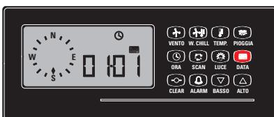
Figure 13: Si vous voulez introduire la date, pressez la touche DATA. A l'écran apparaissent le symbole du calendrier et les nombres 01-01 pour Janvier 1 (au format anglo-saxon M-J).
