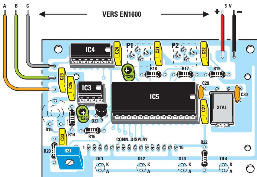
Figure 10a-2: Schéma d'implantation des composants de la platine afficheur EN1601 de l'audio-mètre, côté " composants" où la plupart des composants sont montés. Comme le montrent ces dessins, les composants sont montés des deux côtés de la platine (sur les deux faces du circuit imprimé)
