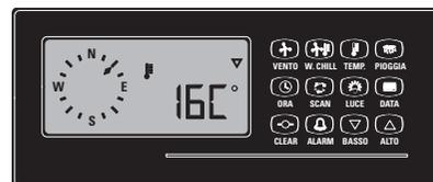
**Figure 46:** Après quelques secondes la date courante et le symbole du calendrier s'effacent pour laisser place à la valeur de température minimale enregistrée depuis minuit.
