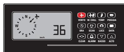
**Figure 53:** Si vous voulez sélectionner l'alarme de haute vitesse du vent, pressez et relâchez la touche VENTO et la valeur actuelle de vitesse du vent s'affiche (dans l'unité présélectionnée).
