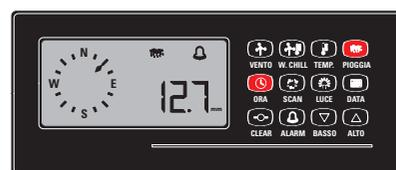
Figure 62: Pour activer l'alarme du niveau des précipitations, pressez ensemble les touches PIOGGIA et ORA. Le symbole de l'alarme et la valeur d'alarme précédemment programmée s'affichent.
