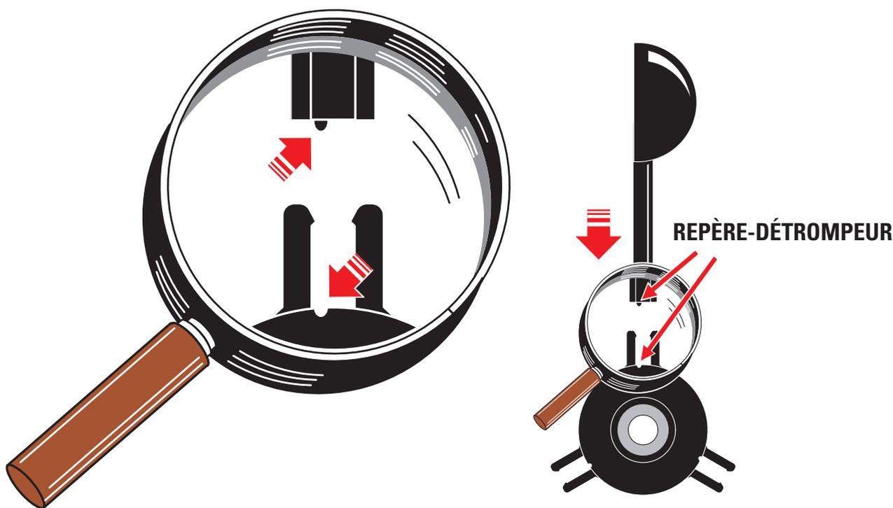
Figure 4: Pour insérer correctement les pales à coupelles du capteur anémométrique de vitesse du vent, considérez que les repère-détrompeurs situés sur le rotor (trois petits évidements demi circulaires) doivent correspondre à la languette située sur le pied de chaque pale.
