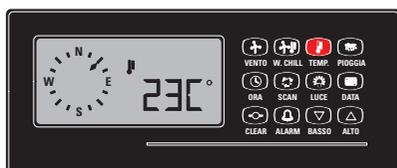
**Figure 40:** Pour visualiser la température maximale de la journée courante, enregistrée à partir de minuit, pressez d'abord la touche TEMP, ce qui affiche la température actuelle.
