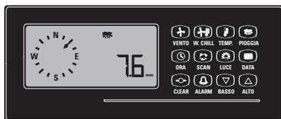
**Figure 50:** Après quelques secondes, la date d'hier et le symbole du calendrier disparaissent pour laisser place à la valeur des précipitations d'hier. Cette valeur et la date s'affichent alternativement.
