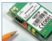
Grâce au minuscule module GPS / GSM Wavecom nous allons réaliser un localiseur à distance alimenté par une batterie rechargeable ; il est tellement petit qu'on pourra le mettre dans la poche et pas seulement à bord d'un véhicule (pour ce dernier cas cependant nous vous proposons un adaptateur d'alimentation à découpage ET601). Avec Internet et la cartographie disponible, une utilisation en réseau permet de visualiser la position du localiseur sur une carte.
