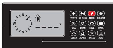
**Figure 36:** Si vous la pressez une seconde fois, le symbole du thermomètre dans une maison apparaît avec quatre traits horizontaux (cette fonction de mesure de température n'est pas utilisée).
