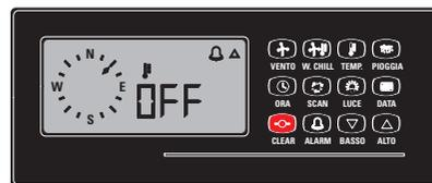
Figure 64: Si l'alarme est déjà en fonction, pour la désactiver définitivement il suffit de presser la touche CLEAR et de la maintenir jusqu'à l'affichage de l'indication OFF.
