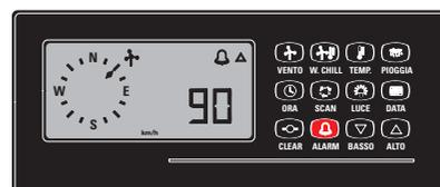
**Figure 54:** Pressez alors la touche ALARM et l'écran affiche le symbole de l'alarme avec la valeur de l'alarme actuelle, ou bien la mention OFF (si aucune alarme n'a été paramétrée).
