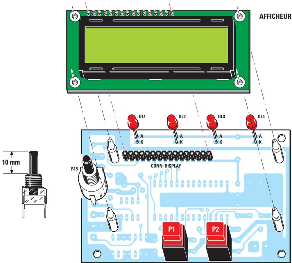
Figure 10a-1: Schéma d'implantation des composants de la platine afficheur EN1601 de l'audio-mètre, côté "soudures" où le LCD et des composants sont montés.
