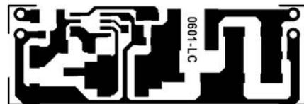
Figure 8c: Dessin, à l'échelle 1, du circuit imprimé de l'adaptateur d'alimentation à découpage ET601.
