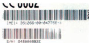
Pour pouvoir être exécutés par le circuit, les messages de commandes doivent commencer par le mot de passe: il s'agit des quatre derniers chiffres de l'IMEI –voir photo en médaillon– sauf bien sûr s'il a été modifié avec le SMS PN:xxxx (nouveau mot de passe; les x correspondant aux chiffres du nouveau
