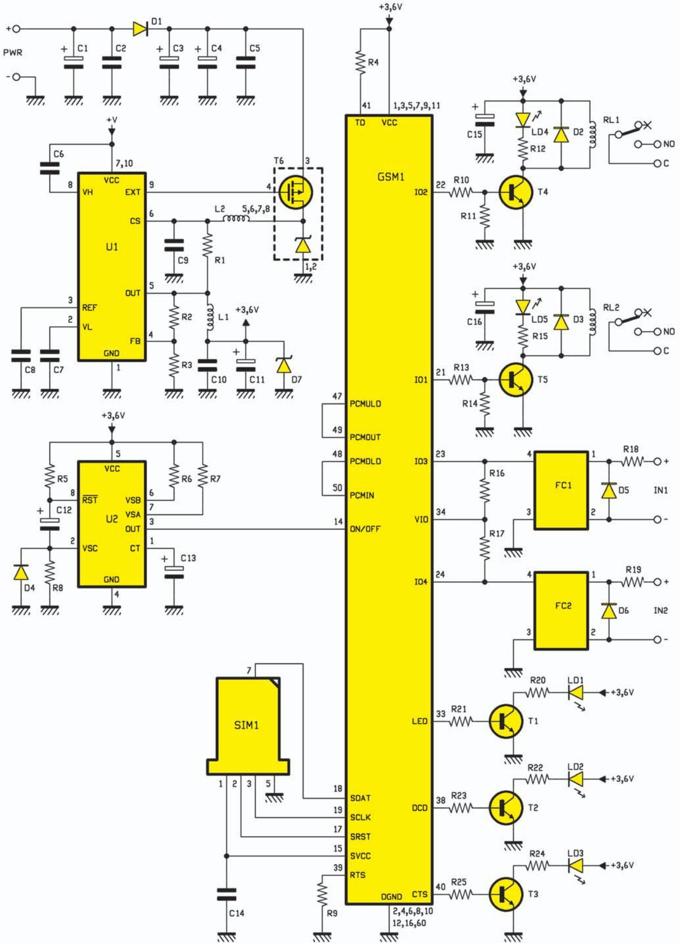
Figure 2: Schéma électrique du contrôle à distance bidirectionnel GSM.
