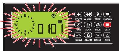
Figure 14: Pour modifier le format de la date (et passer au format européen J-M), pressez la touche DATA et maintenez-la jusqu'à ce que l'afficheur cesse de clignoter. 01-01 signifie alors 1 Janvier.
