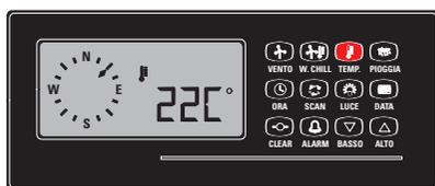
Figure 56: Si vous voulez insérer l'alarme de température élevée, pressez la touche TEMP. Ainsi, la valeur actuelle mesurée par le capteur s'affiche.
