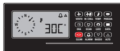
Figure 63: Pour désactiver temporairement le son d'une alarme, il suffit de presser et relâcher la touche CLEAR. Ainsi, le buzzer est désactivé et le son cesse.
