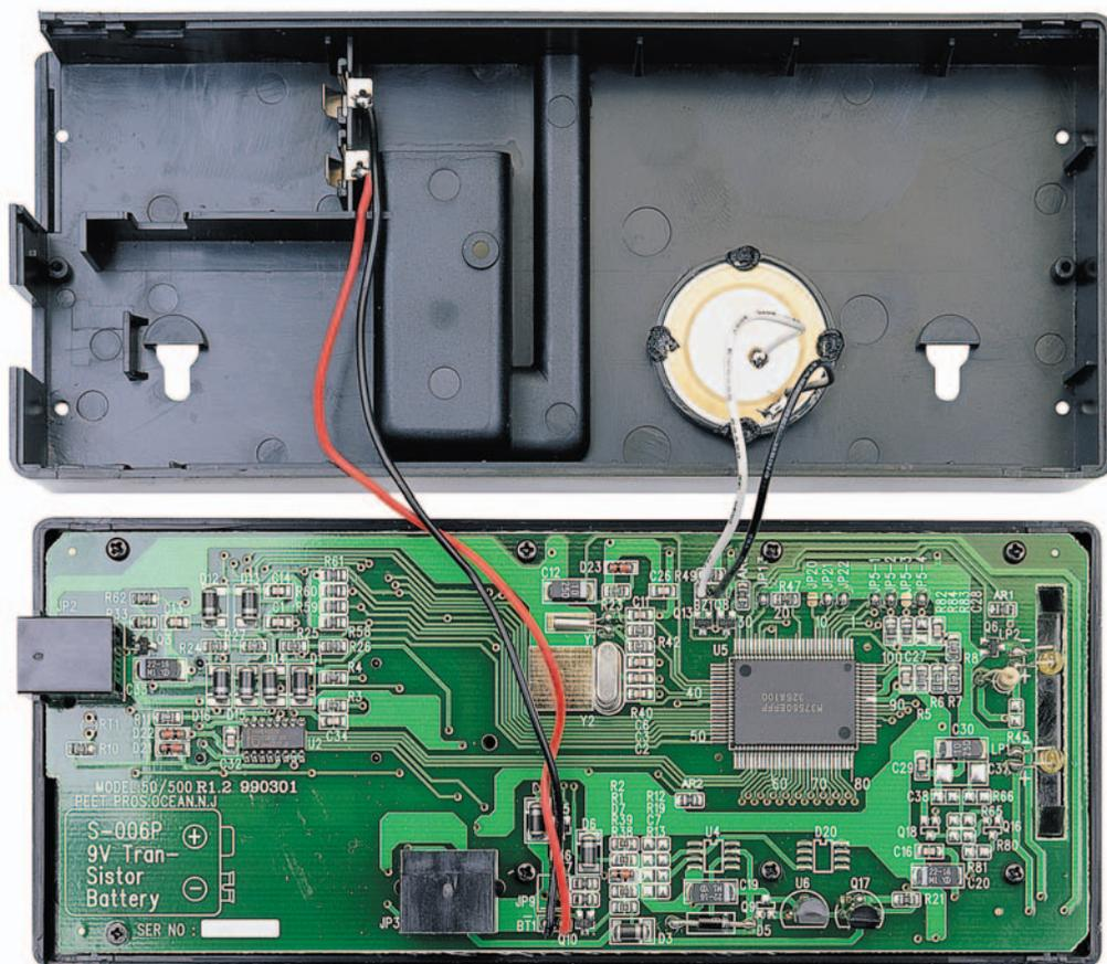
**Figure 65:** Photo d'un des prototypes de la centrale montée dans son boîtier plastique (ouvert pour laisser apparaître le buzzer d'alarme et le compartiment de la pile de 9V de "back-up" ou sauvegarde des données en cas de coupure du courant)
