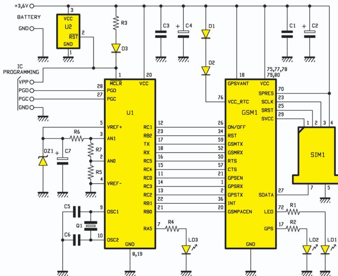
Figure 5: Schéma électrique du localiseur à distance GPS / GSM.
