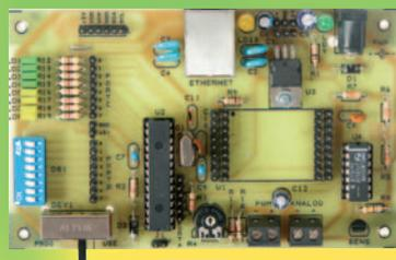
Associé à sa documentation, cette platine d'expérimentation pour module SP1 vous permet de mettre au point vos programmes pour votre serveur web SP1. Dim : 75 x 130 mm - Alimentation 12 VDC. Une documentation complète avec des exemples de programmes est livrée avec notre programmeur.
