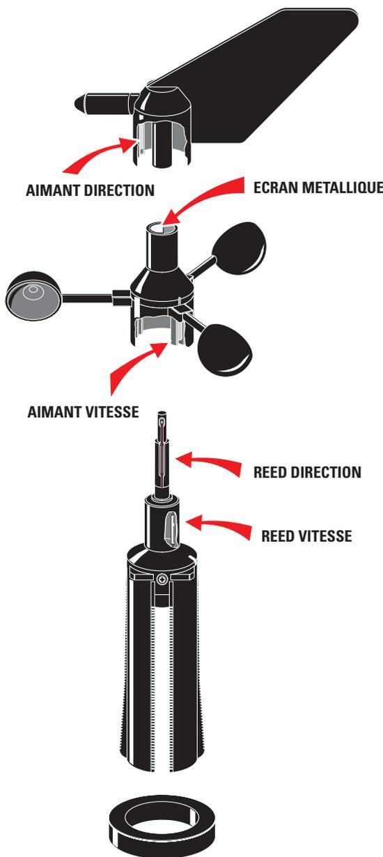
Figure 6: Ces dessins mettent en évidence les deux interrupteurs "reed" et les deux aimants qui les font se fermer, ainsi que l'écran métallique (l'ensemble permet en une seule rotation de l'arbre de déterminer la direction et la vitesse du vent).
