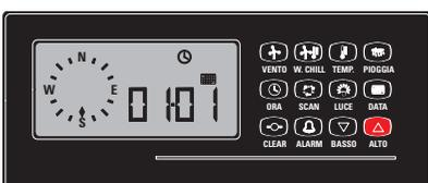
Figure 15: Pour régler la date, il faut presser la touche ALTO et la maintenir jusqu'à ce que l'afficheur cesse de clignoter. Par pression sur les touches ALTO et BASSO on peut modifier les nombres de la date.
