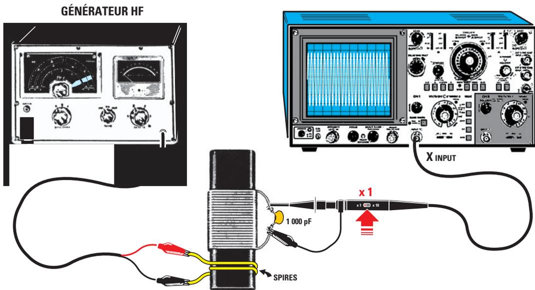
Figure 12 : Pour connaître la fréquence d'accord  $F$  d'un bobinage sur noyau ferrocube également, reliez à ses extrémités un condensateur  $C$  de 1 000 pF céramique et appliquez le signal venant du générateur sur 1 ou 2 spires provisoirement enroulées sur ce noyau. La fréquence d'accord  $F$  peut être trouvée aussi avec le procédé des deux résistances de 1 k, comme le montrent les figures 7 et 13.
