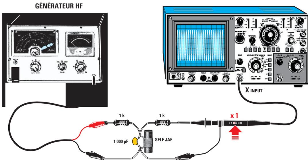
Figure 5: Pour mesurer l'inductance  $L$  en  $\mu\text{H}$  ou en  $\text{mH}$  d'une self, il faut monter entre la sortie du générateur HF et la sonde de l'oscilloscope deux résistances de  $1\text{ k } 1/4\text{ W}$  en série. Tournez alors le bouton HF ou RF OUTPUT (amplitude du signal de sortie) du générateur de façon à obtenir à l'écran une bande de signal couvrant verticalement 6 à 7 carreaux (voir figure 9).
