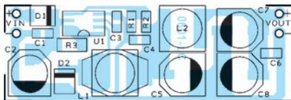
Figure 8b: Schéma d'implantation des composants de l'adaptateur d'alimentation à découpage ET601.
