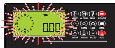
**Figure 32:** On peut insérer une hauteur de pluie tombée avant l'installation de la station météo; pour cela, pressez ensemble les touches **PIOGGIA** et **ALTO** jusqu'à ce que l'afficheur cesse de clignoter.
