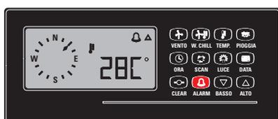
Figure 57: Pressez et relâchez maintenant la touche ALARM. Le symbole de l'alarme et la valeur d'alarme actuelle s'affichent, ou alors la mention OFF apparaît (si aucune alarme n'a été programmée).
