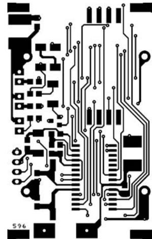
Figure 6b-2: Dessin, à l'échelle 1, du circuit imprimé double face à trous métallisés du localiseur à distance GPS / GSM, côté composants.
