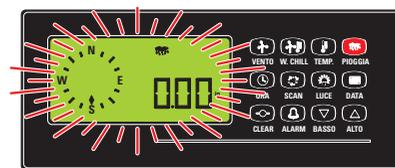
Figure 27: Les unités de mesure des précipitations (pluie en hauteur d'eau recueillie dans un laps de temps donné) peuvent être en pouce in ou en millimètre mm. Pour changer d'unité, pressez la touche (PLUIE) PIOGGIA et maintenez-la pressée jusqu'à ce que l'afficheur cesse de clignoter.
