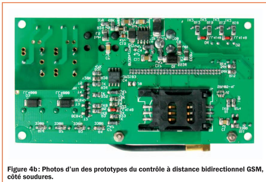
**Figure 4b :** Photos d'un des prototypes du contrôle à distance bidirectionnel GSM, côté soudures.
