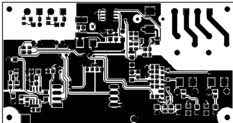
Figure 3b-1: Dessin, à l'échelle 1, du circuit imprimé double face à trous métallisés du contrôle à distance bidirectionnel GSM, côté composants.
