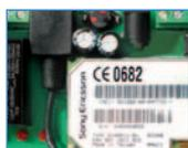
Universel, ce système de contrôle à distance comporte deux relais de sortie activables par SMS et de deux entrées photo-isolées utilisées pour envoyer des messages d'alarme, toujours par SMS, à n'importe quel téléphone mobile GSM. Il peut même servir d'ouvre-porte commandable par une simple sonnerie d'un -ou de plusieurs- téléphones mobiles préalablement habilités.
