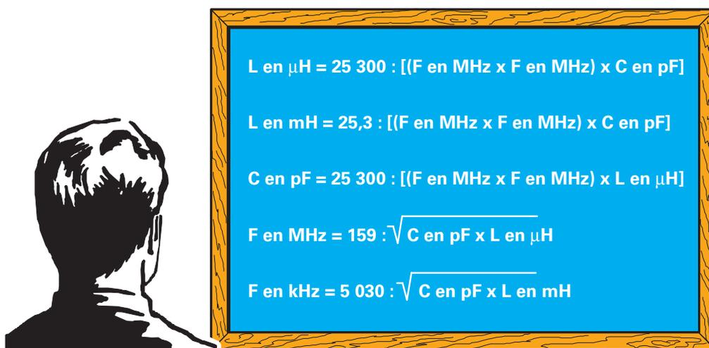
**Figure 16 :** Sur ce “tableau noir” nous récapitulons toutes les formules pouvant être utilisées pour trouver les inductances **L** de selfs inconnues en  $\mu\text{H}$  ou  $\text{mH}$  quand on connaît la fréquence d'accord **F**. Si on connaît la valeur de la capacité **C** en  $\text{pF}$  du condensateur utilisé et l'inductance **L** de la self en  $\mu\text{H}$  ou  $\text{mH}$ , on peut calculer la fréquence d'accord **F** du parallèle **L/C** (circuit oscillant).
