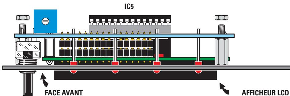
Figure 19: Avant de souder les pattes des LED sur la platine afficheur, vérifiez bien leur polarité (la patte la plus longue, l'anode, est à insérer dans le trou A).
