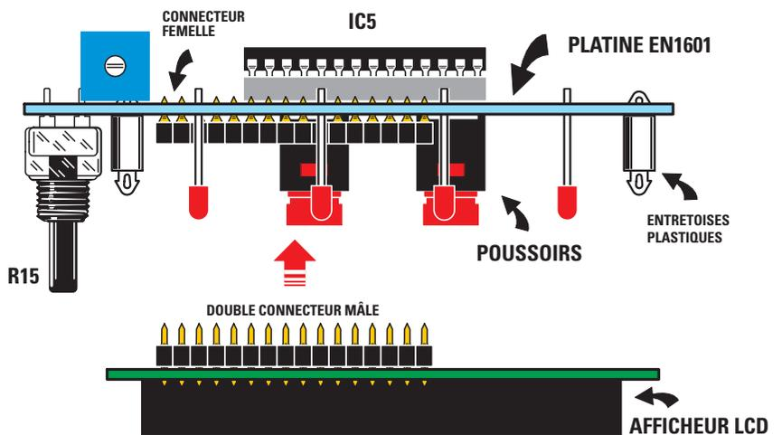
Figure 17: Après avoir soudé le double connecteur mâle au LCD (voir figure 16), enfoncez les broches mâles opposées dans le connecteur femelle préalablement soudé à la platine afficheur EN1601.
