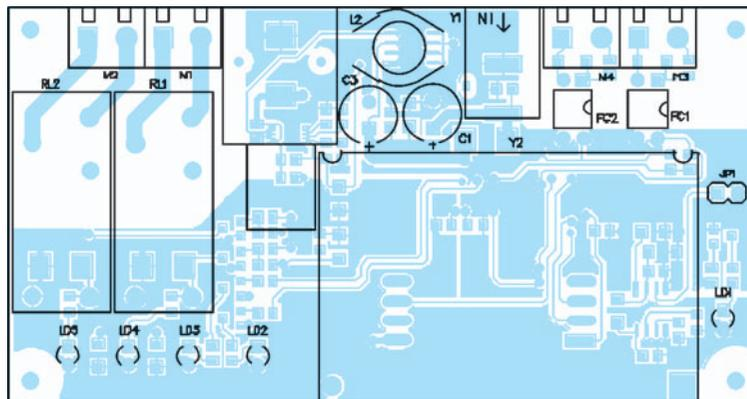
**Figure 3a-1: Schéma d'implantation des composants du contrôle à distance bidirectionnel GSM, côté composants, où est monté entre autres le module.**
