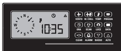
**Figure 43:** Ensuite, la valeur de température maximale disparaît aussi pour laisser place à l'heure de la journée à laquelle cette température maximale a été enregistrée.
