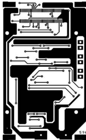
Figure 6b-1: Dessin, à l'échelle 1, du circuit imprimé double face à trous métallisés du localiseur à distance GPS / GSM, côté soudures.
