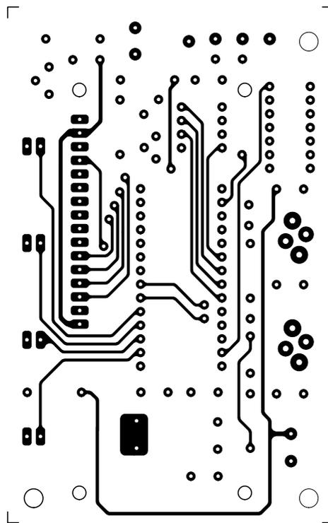
Figure 10b-2: Dessin, à l'échelle 1, du circuit imprimé double face à trous métallisés de la platine afficheur EN1601 de l'audio-mètre, côté composants.
