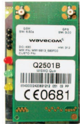
Figure 7b: Photo d'un des prototypes du localiseur à distance GPS / GSM (la platine côté composants classiques surmontée du module Q2501).
