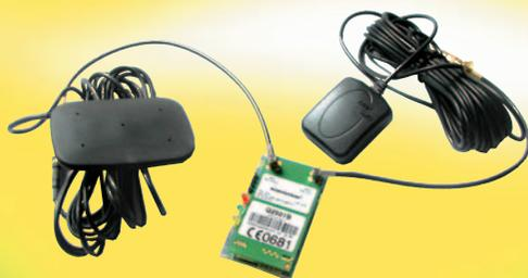
Grâce au minuscule module GPS / GSM Wavecom nous allons réaliser un localisateur à distance alimenté par une batterie rechargeable ; il est tellement minuscule (58 x 32 x 6 mm) qu'on pourra le
