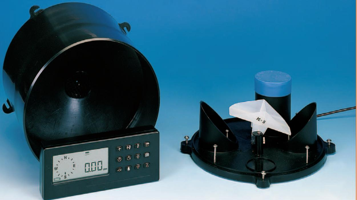
Figure 39 : Photo d'un pluviomètre où vous pouvez observer la cuve cylindrique et sa base dotée d'un réceptacle basculant sur laquelle on voit les vis de fixation à la plateforme.
