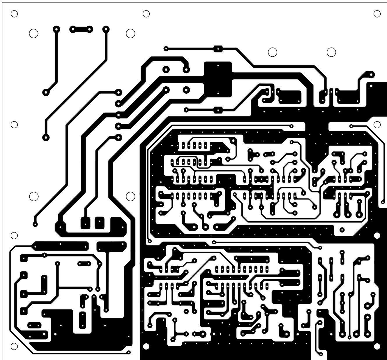
Figure 9b-1: Dessin, à l'échelle 1, du circuit imprimé double face à trous métallisés de la platine principale EN1600 de l'audio-mètre, côté soudures.
