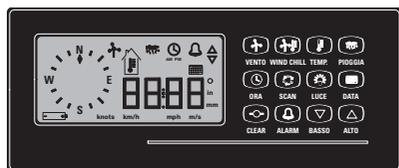
Figure 9: Vue de la face avant de la centrale avec, à droite, ses douze poussoirs permettant de sélectionner (entre autre) le paramètre météorologique qui nous intéresse et, à gauche, le grand afficheur sur lequel nous avons fait figurer tous les symboles possibles ensemble (alors qu'ils apparaissent au fur et à mesure et en fonction du paramètre affiché). L'écran s'illumine quand on presse le poussoir LUCE (LUMIÈRE).
