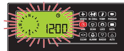
Figure 17: Pour afficher l'heure au format européen (0 à 24 h), pressez à nouveau la touche ORA et maintenez-la pressée jusqu'à ce que l'afficheur cesse de clignoter pour visualiser l'heure au nouveau format 24 h.
