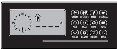
Figure 21: Le symbole du thermomètre dans une maison et quatre traits horizontaux remplaçant la température s'affichent alors.
