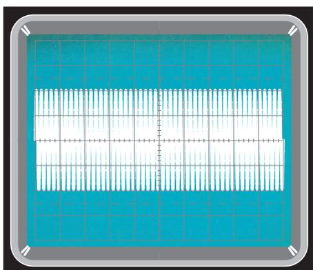
Figure 10: L'amplitude maximale correspond à la fréquence d'accord F du circuit L/C; en effet, si vous augmentez encore la fréquence, la bande de signal redevient plus étroite (vous avez alors dépassé la fréquence d'accord F).
