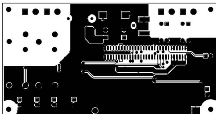
Figure 3b-2: Dessin, à l'échelle 1, du circuit imprimé double face à trous métallisés du contrôle à distance bidirectionnel GSM, côté soudures.
