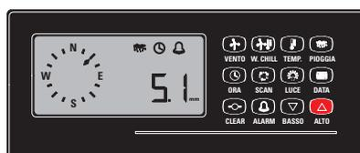
Figure 61: Pour entrer une nouvelle valeur d'alarme, pressez et maintenez la touche ALTO jusqu'à ce que l'afficheur cesse de clignoter. Vous pouvez alors modifier la valeur avec ALTO ou BASSO.
