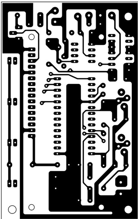
Figure 10b-1: Dessin, à l'échelle 1, du circuit imprimé double face à trous métallisés de la platine afficheur EN1601 de l'audio-mètre, côté "soudures" où sont montés les LED, le connecteur pour le LCD, le potentiomètre et les poussoirs.
