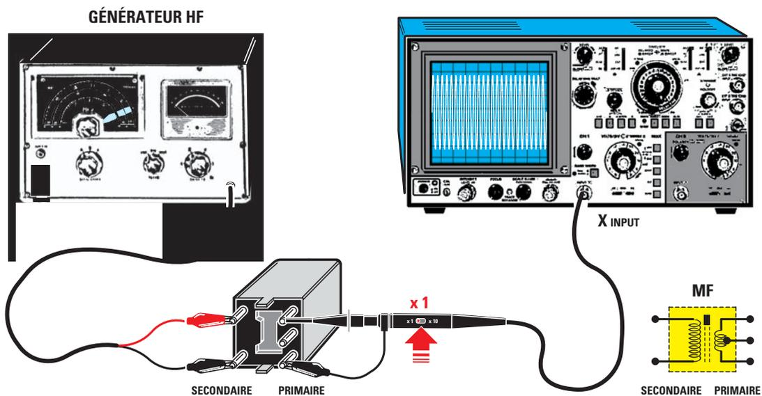
Figure 14: Pour connaître la fréquence de travail  $F$  d'une MF, il suffit d'identifier les sorties du socle isolant. Le secondaire sur lequel appliquer le signal du générateur est à 2 broches (toutes deux du même côté) et le primaire à relier à l'oscilloscope est à 3 broches (toujours toutes trois du même côté). Aucun condensateur n'est à monter (il est déjà présent à l'intérieur du boîtier de blindage).
