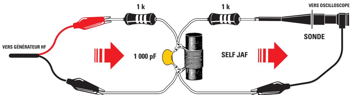
Figure 7: La self, ou tout autre bobinage, de valeur inductive  $L_x$  inconnue et dont vous voulez connaître l'inductance  $L$  en  $\mu\text{H}$  ou en  $\text{mH}$ , est à monter entre la jonction de deux résistances de  $1\text{ k}$  et la masse; sans oublier de monter en parallèle avec la self un condensateur de capacité  $C = 1\ 000\ \text{pF}$ , si possible au polyester. Le "tableau noir" de la figure 16 récapitule toutes les formules utiles pour trouver les différentes valeurs.
