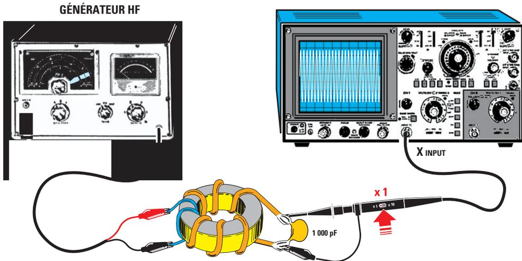
Figure 11 : Pour connaître la fréquence d'accord  $F$  d'un bobinage sur noyau torique, reliez à ses extrémités un condensateur  $C$  de 1 000 pF, bobinez (provisoirement) 1 ou 2 spires de fil isolé plastique (il vous servira à appliquer le signal venant du générateur HF).
