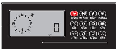
Figure 23: Si vous pressez et relâchez la touche VENTO (VENT), le symbole de l'anémomètre s'affiche et la centrale visualise la première fois la vitesse du vent dans l'unité anglosaxonne mph (mille per hour).
