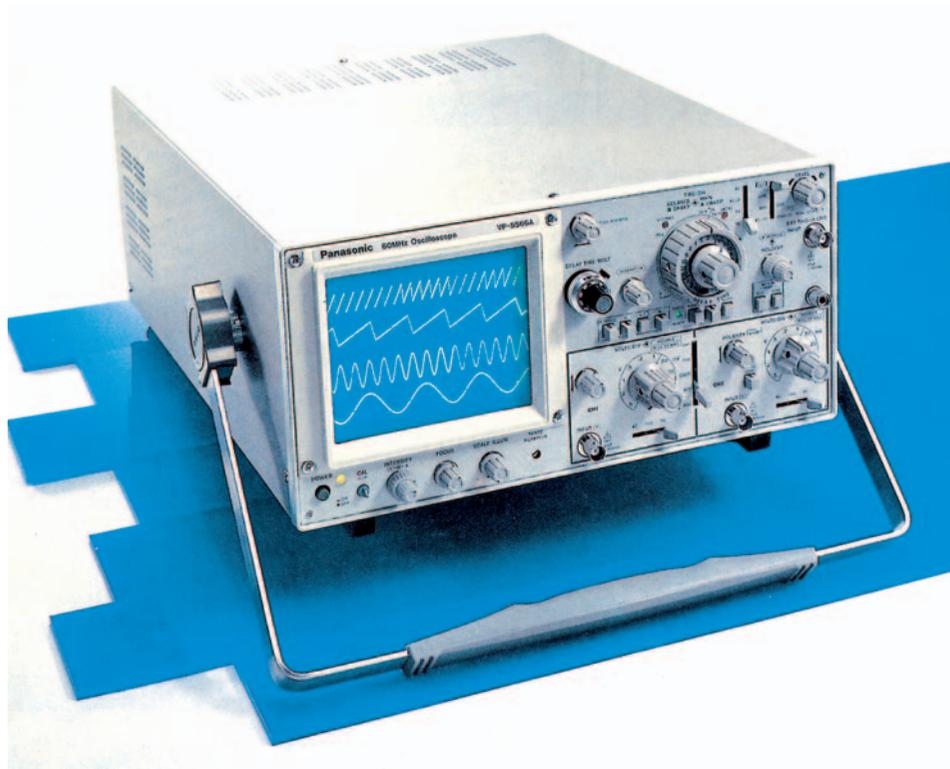
**P**eu d'électroniciens, débutants en tout cas, se doutent qu'il est possible avec un oscilloscope de déterminer la valeur en microhenry ou en millihenry d'une self ou d'un bobinage quelconque, puisqu'on pense généralement que cet appareil ne sert qu'à visualiser la forme et l'amplitude d'un signal électrique et, à la rigueur, d'en évaluer la fréquence.
