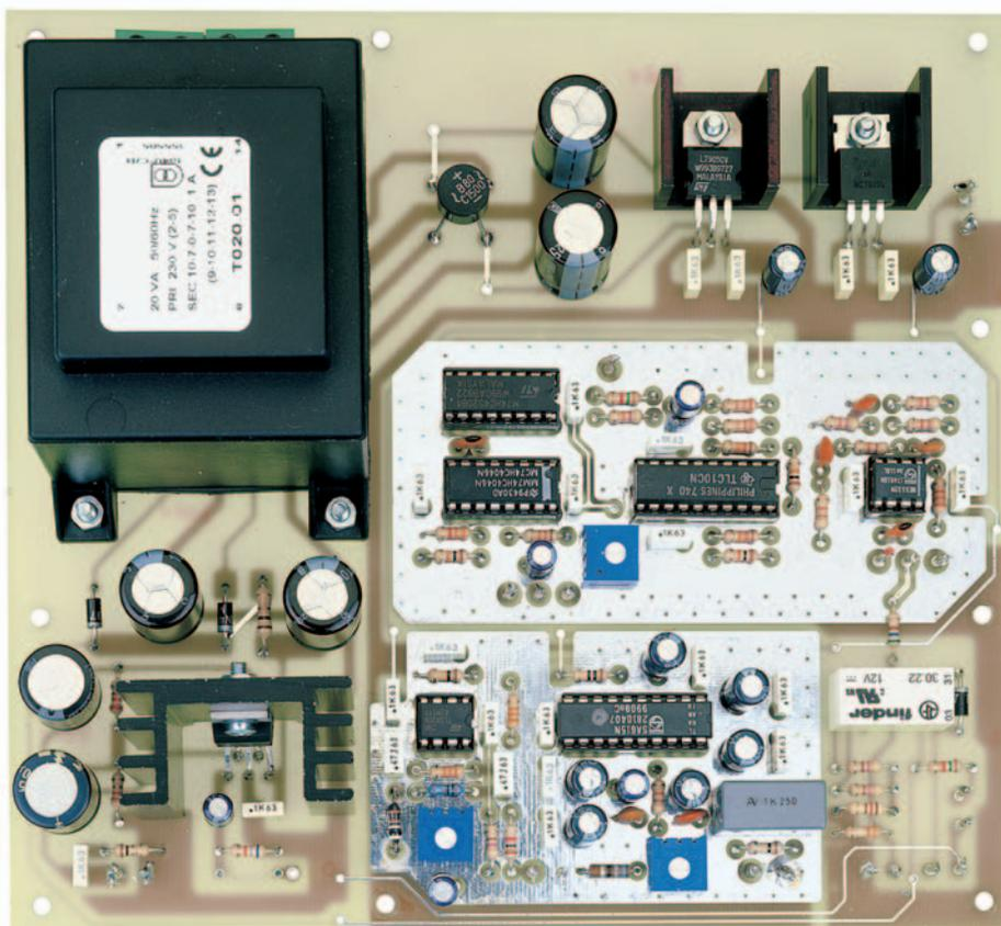
Figure 11: Photo d'un des prototypes de la platine principale EN1601 de l'audio-mètre.
