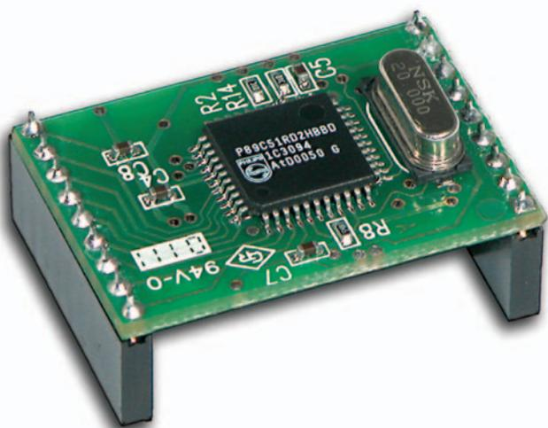
Dans cette série d'articles, nous vous apprenons à programmer et à utiliser le module SitePlayer SP1. Ce circuit intégré réalise un véritable serveur pour la Toile ("Web Server"), c'est-à-dire qu'il permet d'interagir avec n'importe quel dispositif électronique à travers une page Internet normale. Nous apprenons à nous servir de ce module pour réaliser des applications nous permettant de faire communiquer sur le réseau des appareils distants en tout genre.
