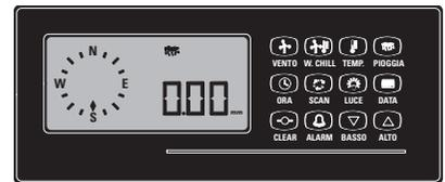
Figure 28: L'écran affiche alors la hauteur des précipitations recueillies depuis minuit en mm. 0,00 mm indique un pas de 0,25 mm.
