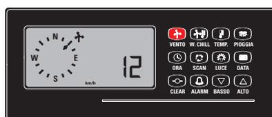
**Figure 34:** Quand vous aurez mis en fonction l'anémomètre, vous verrez s'afficher à l'écran le symbole de l'anémomètre et la rose des vents indiquera la direction d'où vient le vent et sa vitesse en km/h.
