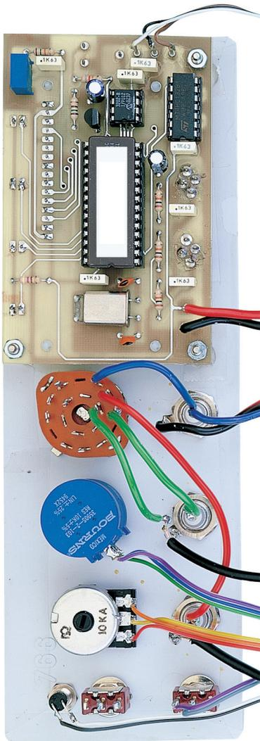
Figure 15: Photo d'un des prototypes de la platine afficheur EN1601, vue côté composants, montée derrière la face avant à l'aide de quatre entretoises.
