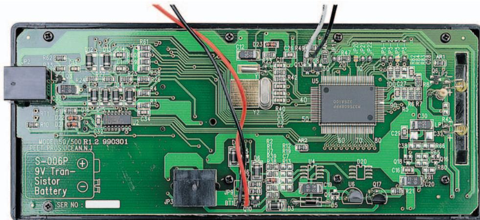
Figure 2: Photo d'un des prototypes de la centrale météo. A haute intégration, grâce à l'utilisation de composants à montage de surface (CMS), elle est disponible déjà montée et prête à être raccordée à son alimentation secteur 230 V et à ses capteurs périphériques.
