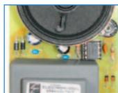
Fatigué d'une unique sonnerie au dessus de votre porte ? Eh bien ça va changer : avec ce carillon électronique, quand vous aurez assez d'entendre un air, il vous suffira de le modifier, car il est programmable (trois possibilités) ! Le montage est pourtant simple et sa réalisation rapide, grâce à un seul petit circuit intégré Siemens.
