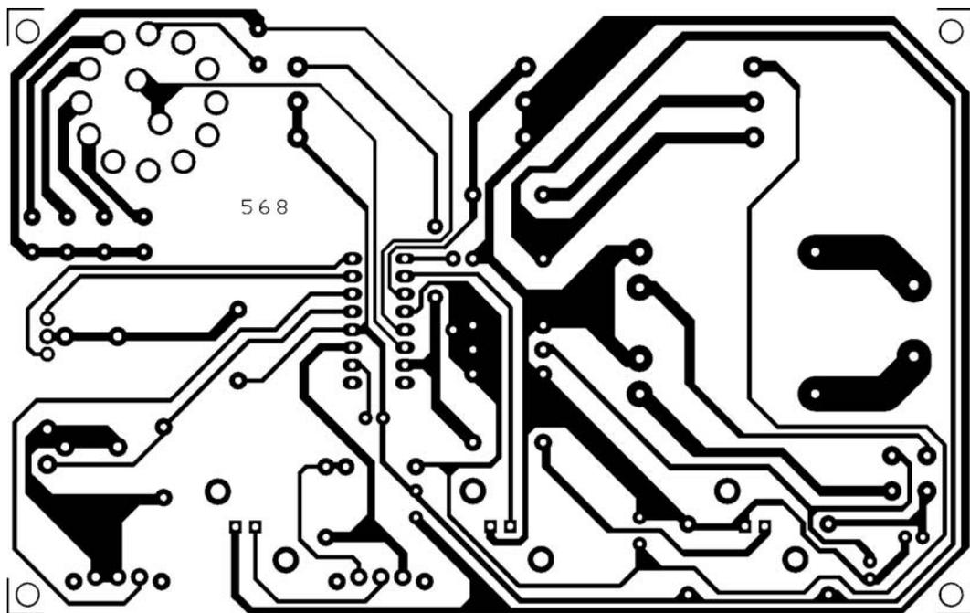
Figure 2b: Dessin, à l'échelle 1, du circuit imprimé du générateur de fonctions.
