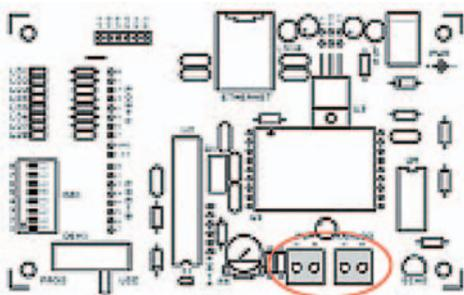
**Figure 5: Démo 9 (exemple de gestion d'une sortie analogique: une tension de sortie est produite et sa valeur est paramétrée par un bouton).**
