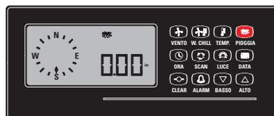
Figure 26: Si on presse la touche PIOGGIA (PLUIE), la centrale affiche en premier la quantité de pluie tombée (et recueillie dans le pluviomètre) à partir de minuit en in (pouce ou "inch"). 0.00 indique un pas de 0,01 in.
