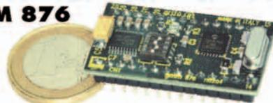
**grifo<sup>®</sup> Mini-Module** à 28 broches basée sur la CPU Microchip **PIC 16F876A** avec **14,3K FLASH**; 368 Bytes RAM; 256 Bytes EEPROM; 2 Temporisateurs Compteurs et 2 sections de Temporisateur Compteur à haute fonctionnalité (PWM, comparaison); 2 Comparateurs; 5 A/D; 12C BUS; Master/Slave SPI; 22 lignes d'E/S TTL; RS 232 ou TTL; 1 LED d'état; etc.
