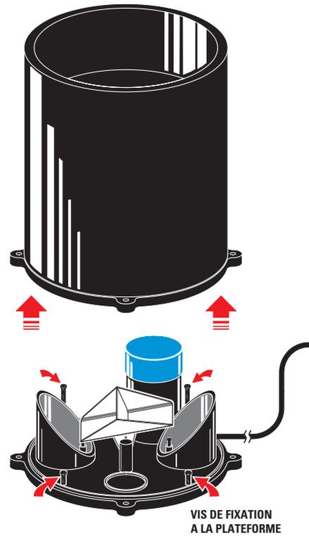
Figure 38 : Le pluviomètre est censé indiquer (par exemple en mm) la hauteur d'eau de pluie tombée dans un certain laps de temps (par exemple on dira qu'il n'est tombé que 150 mm à Marseille en 2005). Le pluviomètre est formé d'une cuve basculante divisée en deux sections et recueillant une quantité précise de liquide puis la vidant quand son poids atteint la valeur prédéterminée.
