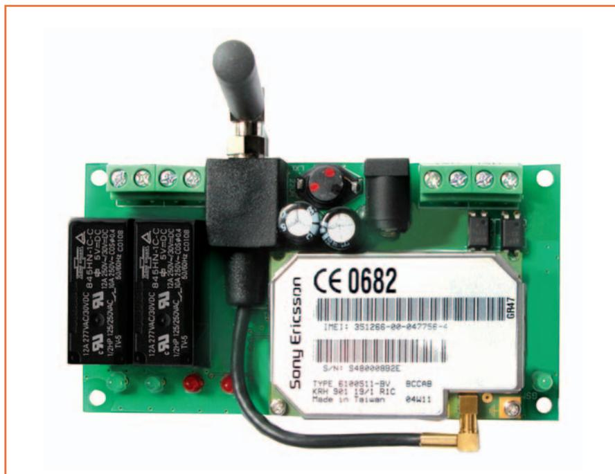
**Figure 4a :** Photos d'un des prototypes du contrôle à distance bidirectionnel GSM, côté composants.
