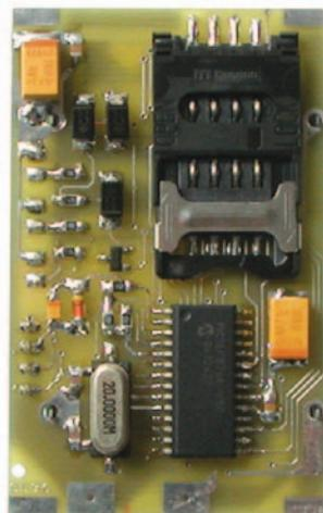
Figure 7a: Photo d'un des prototypes du localiseur à distance GPS / GSM (la platine côté soudures avec les CMS).
