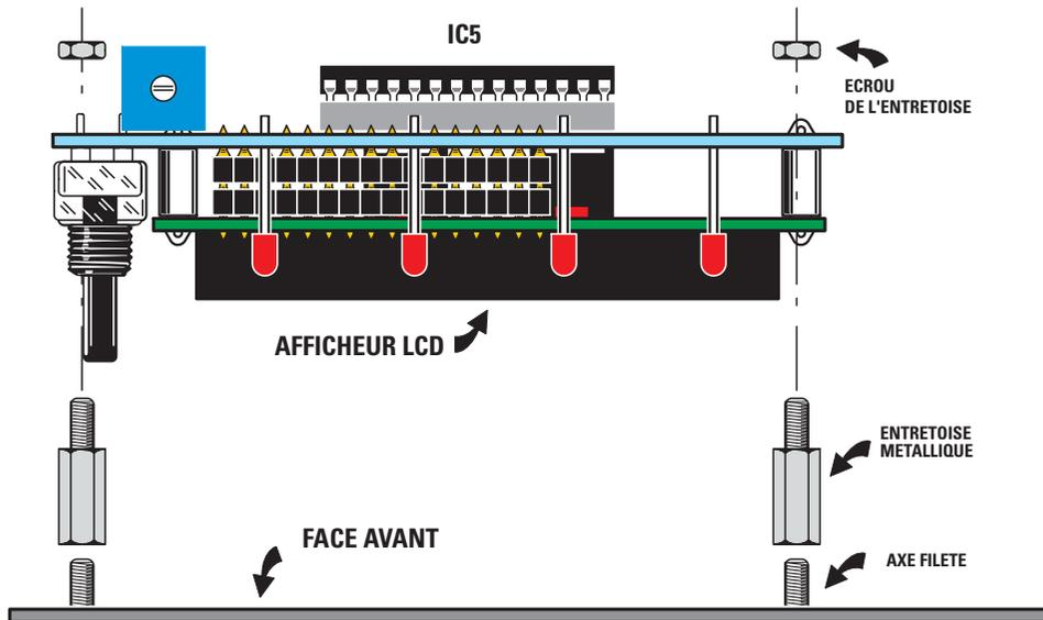
Figure 18: Après avoir enfoncé les LCD dans le connecteur femelle de la platine afficheur, montez les quatre entretoises servant à poser cette platine afficheur et son LCD derrière la face avant.
