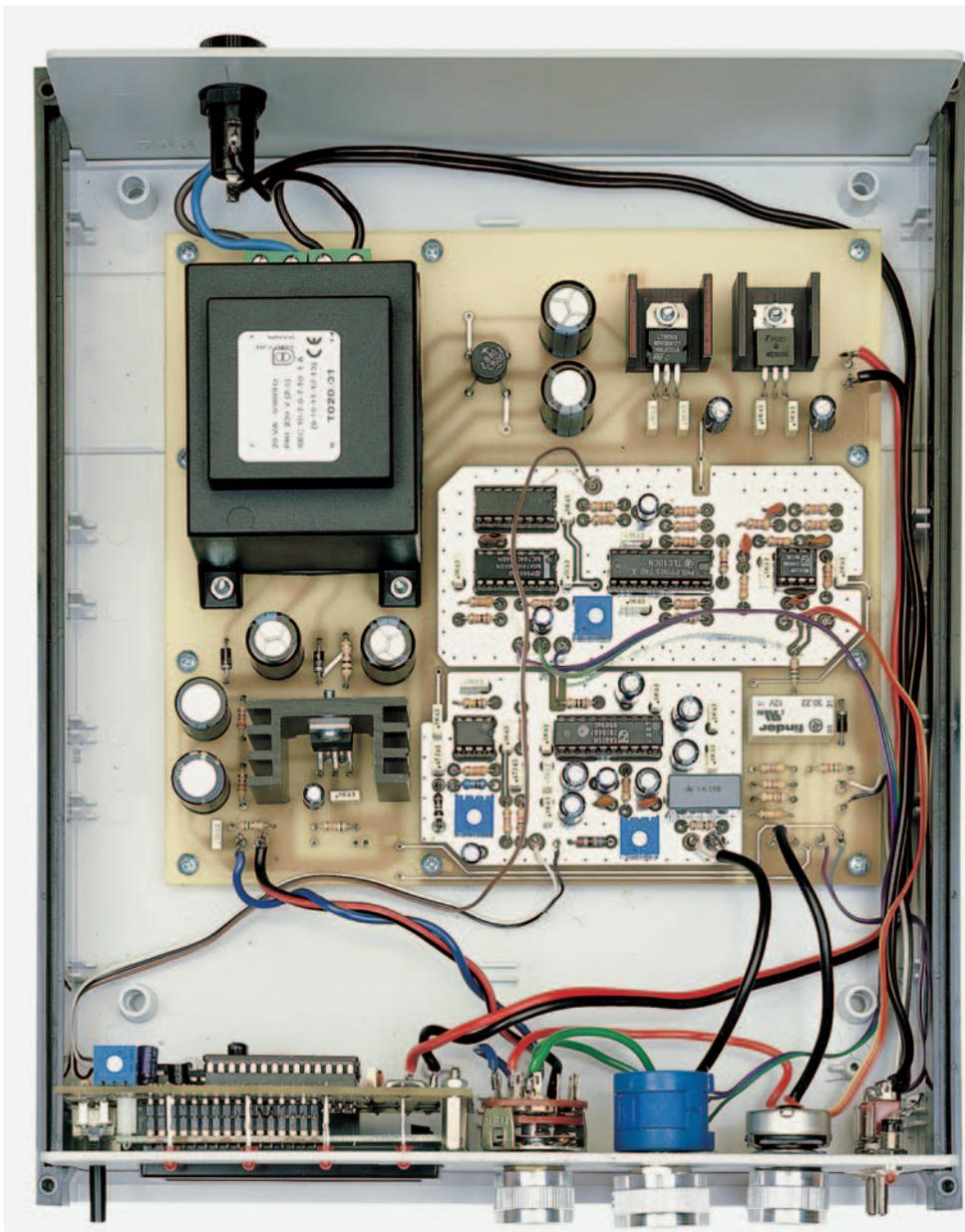
Figure 12: Photo d'un des prototypes de la platine de l'appareil dans son boîtier, couvercle déposé, montrant les deux platines interconnectées et le panneau arrière d'où sort le cordon secteur et où l'on monte le porte-fusible.
