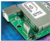
Comment réaliser une connexion de données en temps réel en modifiant le programme résident de notre localiseur miniature GPS/GSM (ET596) décrit dans les numéros 78, 79 et 81 d'ELM. Nous profitons de l'occasion pour vous présenter le projet d'un modem GSM USB à utiliser pour cette même application ET596 mais aussi pour bien d'autres.
