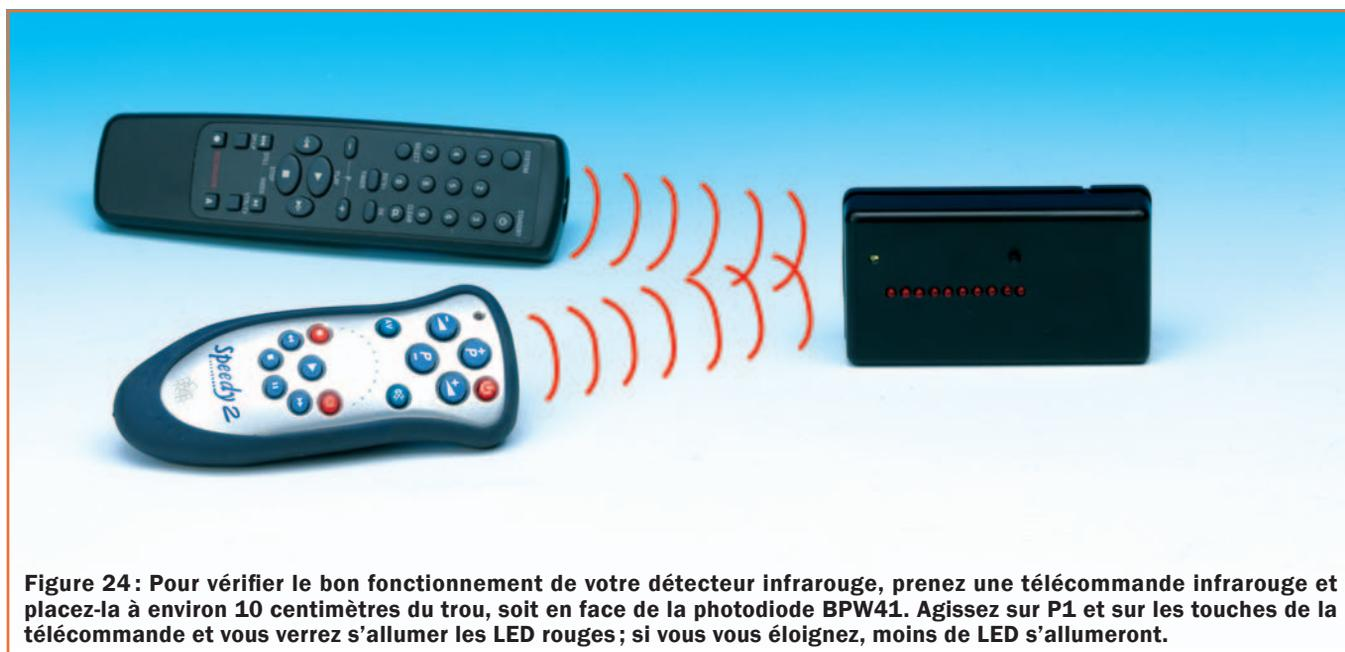
**Figure 24 :** Pour vérifier le bon fonctionnement de votre détecteur infrarouge, prenez une télécommande infrarouge et placez-la à environ 10 centimètres du trou, soit en face de la photodiode BPW41. Agissez sur P1 et sur les touches de la télécommande et vous verrez s'allumer les LED rouges ; si vous vous éloignez, moins de LED s'allumeront.
