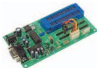
Programmeur de PIC avec support ZIF. Kit à souder. (nécessite alim 15Vcc/300mA)
