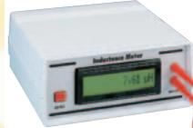
Cet appareil de classe professionnelle est un instrument de mesure de l'inductance des selfs. Il est équipé d'un afficheur LCD à dix chiffres et son échelle de mesure s'étend jusqu'à 300 000 µH soit 300 mH.
