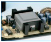
Avec le circuit intégré SG3524 nous avons conçu et réalisé une alimentation à découpage DC DC à sortie double symétrique; elle transforme la tension d'une batterie 12 V (voiture, fourgon, camping-car, etc.) en une tension réglable entre +/-5 V et +/-32 V pour un courant de 2 A par branche. Il est également possible, moyennant une petite modification, d'obtenir une sortie simple positive réglable entre +5 V et +32 V pour un courant de 2 A.
