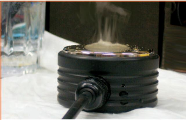
**Figure 26 :** Photo d'un des diffuseurs. Avec notre ancien générateur à 1 MHz, en posant une goutte d'eau à la surface du transducteur, on obtient un effet de vaporisation bien visible.
