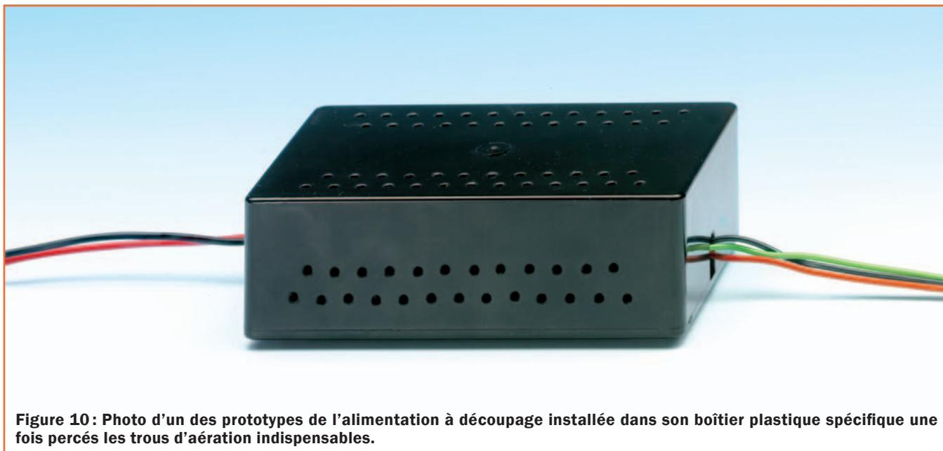
Figure 10 : Photo d'un des prototypes de l'alimentation à découpage installée dans son boîtier plastique spécifique une fois percés les trous d'aération indispensables.
