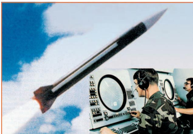
**Figure 17:** Dans les ogives de tous les missiles air-air ou sol-air se trouvent des capteurs infrarouges capables de piloter les missiles vers la chaleur produite par les réacteurs d'un avion militaire ennemi. Pour les éviter, on a étudié des parades efficaces, telles les "boules de feu" ou "infrared flares".
