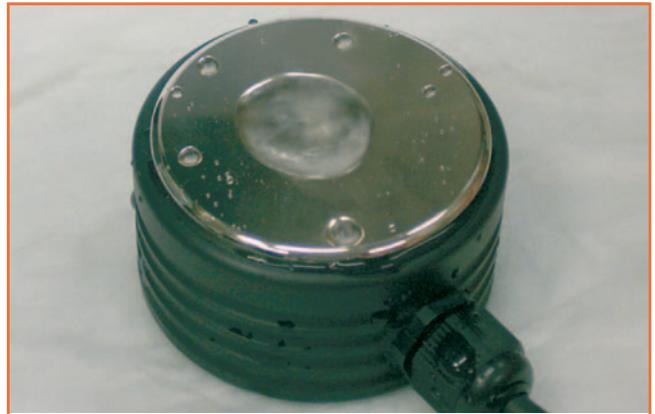
**Figure 27 :** Avec le générateur à 3 MHz, l'eau n'est plus vaporisée mais concentrée vers le centre du transducteur.
