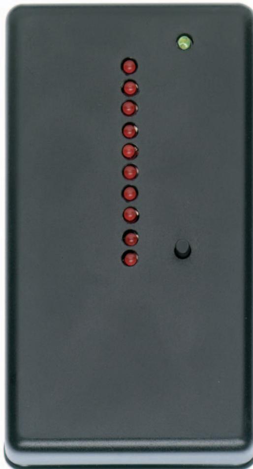
Figure 23: Quand le boîtier plastique est fermé et retourné, les LED sont visibles (ajustez bien la longueur de leurs pattes avant de les souder, afin qu'elles affleurent à la surface plastique de la boîte).
