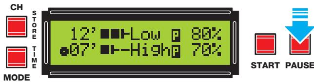
Une pression sur START et le générateur d'ultrasons reprend la séance là où il l'a arrêtée. Quand le décompte de la durée sélectionnée pour un canal est achevé (arrivé à 0), le buzzer émet un bip de deux secondes pour indiquer que la session est terminée pour ce canal et l'astérisque clignotant disparaît :
