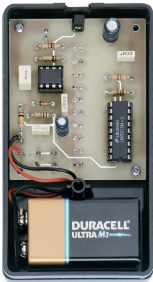
Figure 22: Pour installer la platine au fond du boîtier plastique, utilisez deux vis autotaraudeuses; la pile de 9 V prend place dans son logement (attention à la polarité au moment de souder les fils de la prise de pile à la platine).
