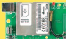
Modem très compact utilisable dans toutes les applications ou il est nécessaire d'effectuer des transmissions de données en utilisant le réseau GSM. Il est doté d'un port USB pour s'interfacer à n'importe quel PC
