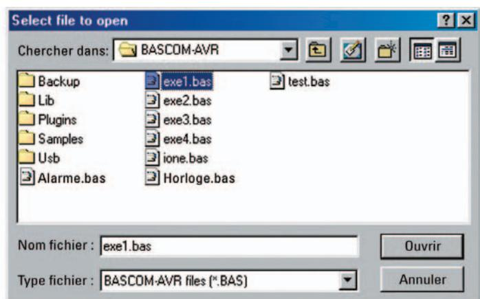
Figure 26: Pour ouvrir un des programmes installés automatiquement avec le logiciel BASCOM-AVR, sélectionnez dans le menu **File** la commande **Open** et, quand la fenêtre de droite s'ouvre, choisissez entre les sources **.bas** écrites en **Basic**. L'article analyse le "listing" du fichier **exe1.bas**, mais sur le CD vous trouverez de nombreuses explications sur tous les fichiers.
