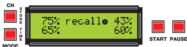
L'astérisque qui suit l'indication RECALL se positionne sur CH1 pour indiquer que nous devons régler la puissance de ce canal avec le potentiomètre correspondant. On n'a qu'à tourner le bouton POWER de CH1 jusqu'à faire coïncider la valeur actuelle et la valeur fixée. Dès que les deux valeurs de puissance affichées sont identiques, le buzzer sonne pour nous avertir que le réglage est fait.
