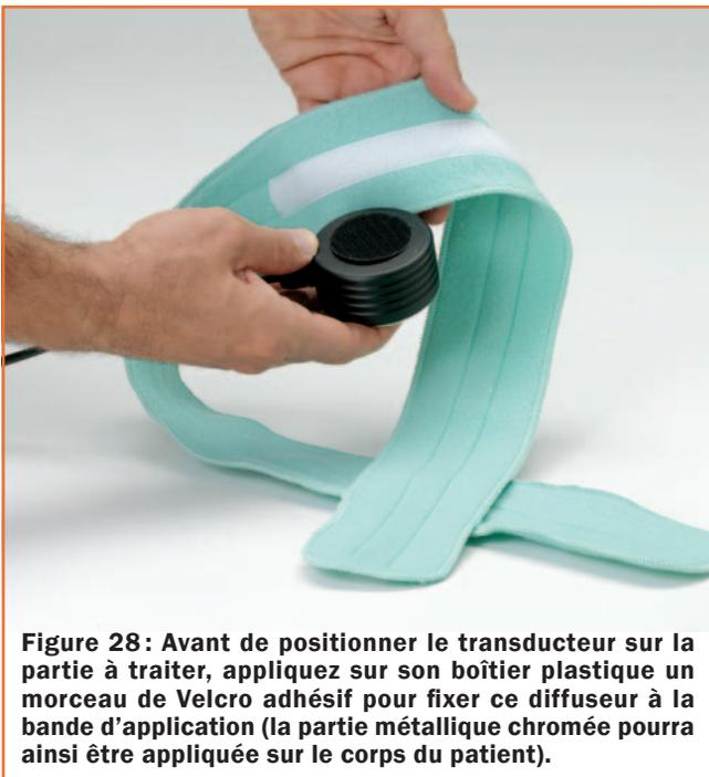
**Figure 28 :** Avant de positionner le transducteur sur la partie à traiter, appliquez sur son boîtier plastique un morceau de Velcro adhésif pour fixer ce diffuseur à la bande d'application (la partie métallique chromée pourra ainsi être appliquée sur le corps du patient).
