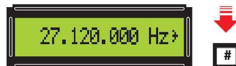
Figure 19 : Après avoir tapé le nombre, pressez la touche # et tout de suite vous verrez s'afficher à droite de Hz le symbole de confirmation signalant qu'on a à la sortie la fréquence demandée.
