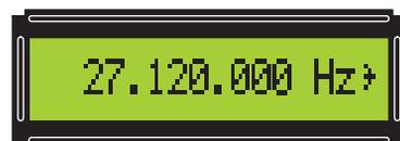
Figure 29 : Après avoir tapé ce nombre, pressez la touche # et tout de suite vous verrez s'afficher à droite de Hz le symbole > de confirmation signalant qu'on a à la sortie la fréquence tapée.
