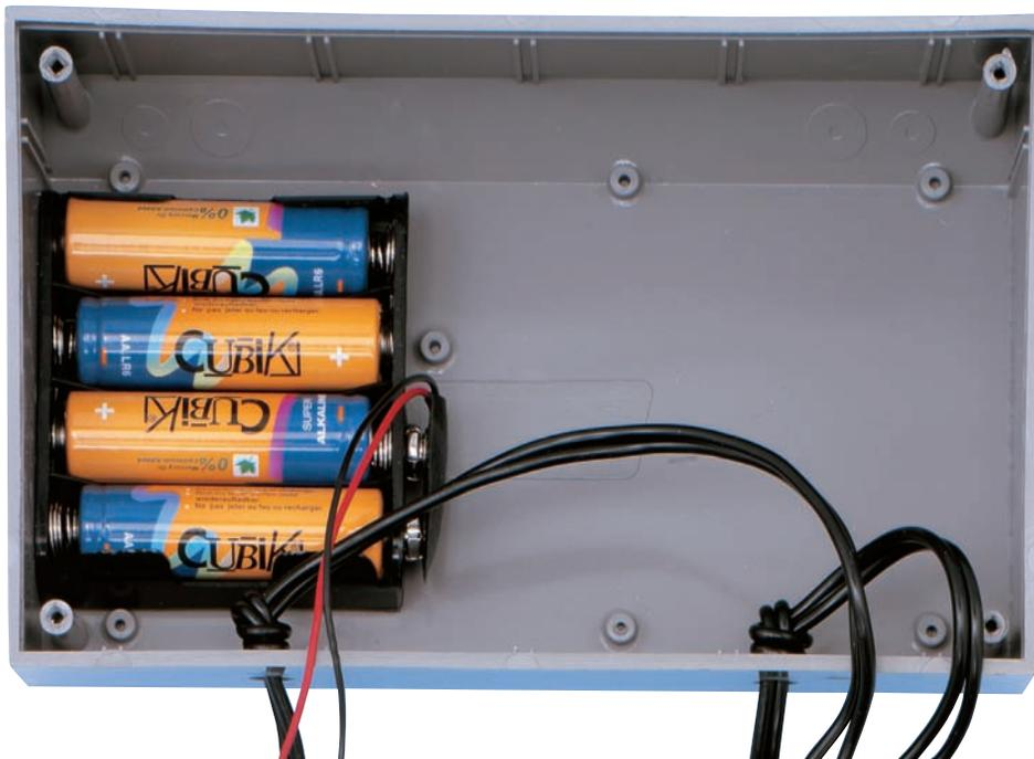
Figure 11 : Sur le fond du boîtier plastique, fixez avec une goutte de colle le boîtier porte-piles. Quand vous insèrerez dans leur logement les 4 piles « bâtons » de 1,5 V, contrôlez bien la polarité et faites en sorte que le pôle positif soit tourné vers le signe +.
