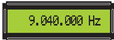
Figure 13 : Comme la fréquence fondamentale d'un quartz de 27 120 000 Hz en troisième harmonique est de 9 040 000 Hz, vous devez taper ce nombre au clavier.
