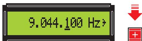
Figure 17 : Quand le nombre 9.044.000 est obtenu, pour avoir une précision supérieure il est nécessaire de modifier les centaines de Hz, en effet l'accord exact est sur 9.044.100 Hz.
