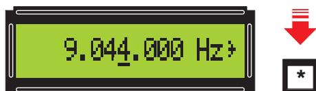
Figure 16 : Comme le montre le Tableau 2, puisque vous devez modifier les milliers de Hz, pressez la touche \* jusqu'à positionner le signe - sous le quatrième chiffre.
