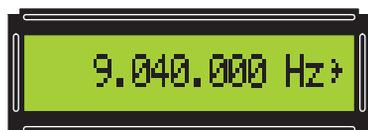
Figure 24 : Après avoir tapé le nombre 9 040 000, pressez la touche # et tout de suite vous verrez s'afficher à droite de Hz le symbole de confirmation > signalant qu'on a cette fréquence sur la BNC.
