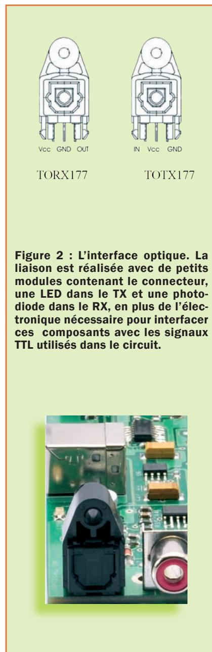
**Figure 2 : L'interface optique. La liaison est réalisée avec de petits modules contenant le connecteur, une LED dans le TX et une photodiode dans le RX, en plus de l'électronique nécessaire pour interfacier ces composants avec les signaux TTL utilisés dans le circuit.**
