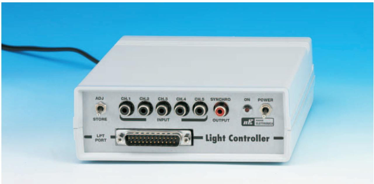
Figure 1 : Photo d'un des prototypes du Light Controller EN1613, la platine ayant été installée dans son boîtier plastique avec face avant et panneau arrière en aluminium anodisé. On voit en face avant le connecteur mâle à relier par câble au port parallèle de l'ordinateur et les six prises RCA de la platine des Entrées EN1614.
