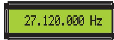
Figure 18 : Comme la fréquence overtone d'un quartz de 27 120 000 Hz en troisième harmonique est exactement cette valeur, vous devez taper sur le clavier le nombre 27.120.000.
