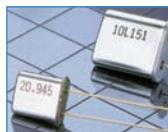
Si on fait osciller un quartz en résonance série ou parallèle, on obtient deux fréquences différentes. Avec le circuit que nous vous présentons dans cette Leçon et à l'aide de notre générateur DDS EN1645, vous découvrirez très facilement les valeurs de ces deux fréquences.
