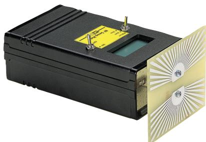
ou comment mesurer la pollution électromagnétique. Cet appareil mesure l'intensité des champs électromagnétiques HF, rayonnés par les émetteurs FM, les relais de télévision et autres relais téléphoniques. Gamme de mesure: de 1MHz à 3 GHz. Résolution: 0.1 V/m. Alimentation :9V
