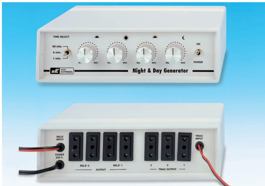
Outre ces trois sorties capables d'allumer seulement des ampoules à filament, il y en a **quatre** autres (voir photo du panneau arrière, en bas) qui, pilotées par deux relais, peuvent alimenter en continu ou en alternatif n'importe quel type d'ampoules, à filament ou bien au néon, en **230 V** ou bien en **12-24 V**, de même que des ventilateurs et de petits moteurs électriques.
