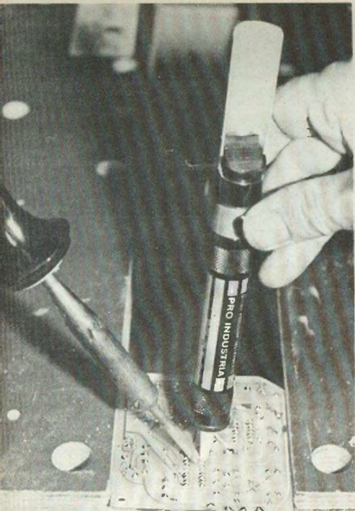
Photo 6. – Une pompe à dessouder aspire l'étain refondu soudure après soudure. Un CI DIL à 18 broches peut ainsi être récupéré sans dommages. Le circuit imprimé doit être solidement fixé pendant l'opération (ici dans un « work-mate »).
