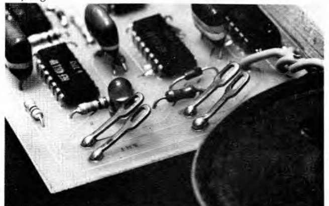
Photo 2. - Touches de départ et d'arrêt sensibles et constituées de cosses « poignard ».
