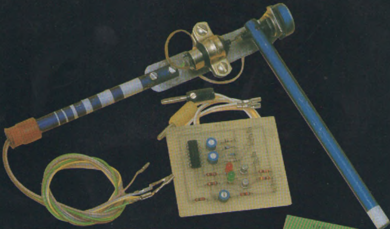
Un aspect du servomécanisme pour robot, avec ici le bras articulé. On aperçoit le micromoteur qui entraîne l'axe du potentiomètre. De saison, cette étonnante marguerite électronique.
