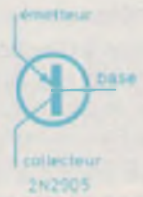
Brochage des transistors 2N2222 et 2N2905
