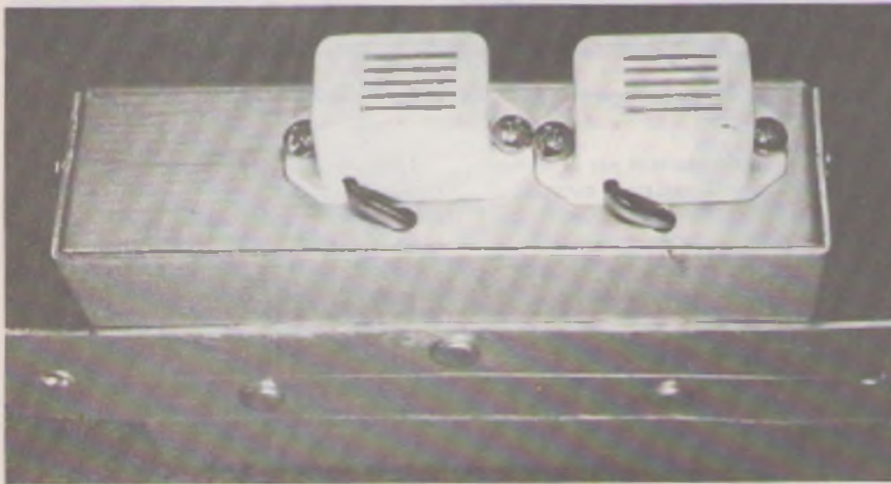
Photo 4. – Les deux petits buzzers sont fixés au boîtier par des petites vis Parker.
