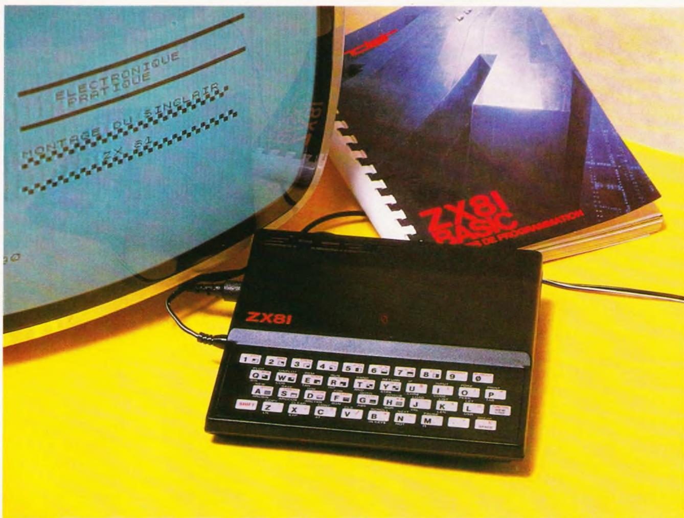
**L**e bloc d'alimentation est prêt à être utilisé, le clavier est un sandwich de feuilles isolantes et conductrices se terminant par deux « queues » destinées à assurer les contacts nécessaires... Attention, fragile !
