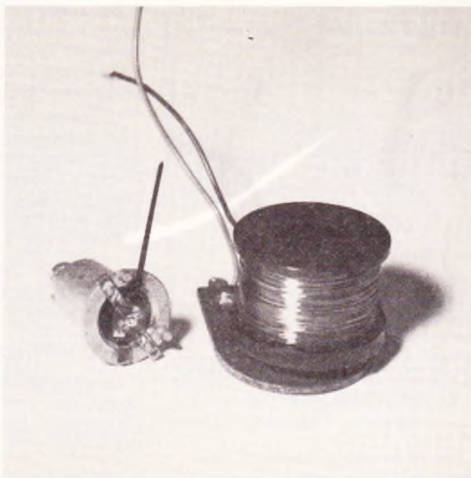
Photo D. — A l'intérieur de la bobine, un cylindre en matériau non magnétique supporte l'axe de la pièce mobile, avec son ressort de rappel et l'aiguille.
