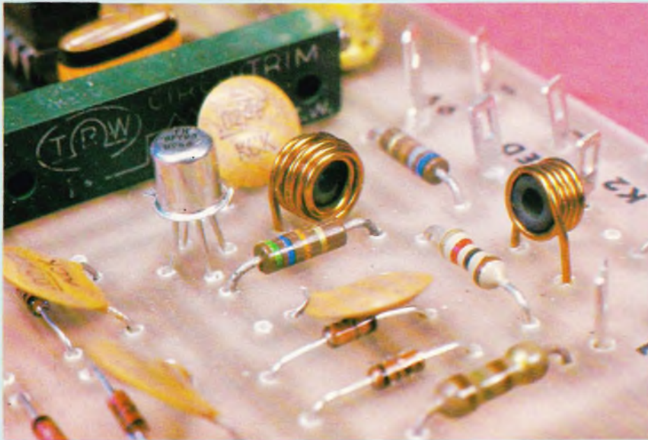
Photo 2. – Détails de réalisation des selfs.
