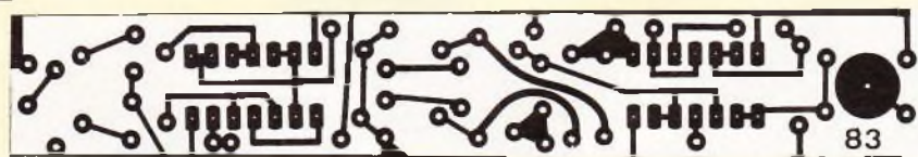
Le tracé du circuit imprimé se reproduira facilement à l'aide d'éléments de transfert direct Mecanorma. Au niveau de l'implantation des éléments, des résistances se monteront côté cuivre.
