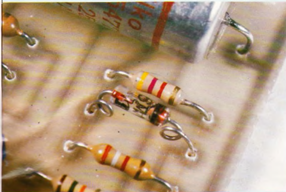
Photo 2. – On respectera un parcours thermique par la diode.
