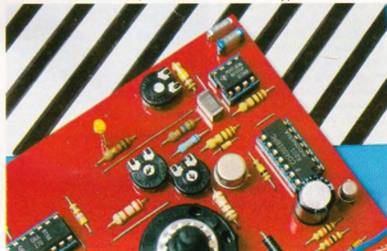
Photo 3. - Les circuits intégrés seront montés sur des supports.
