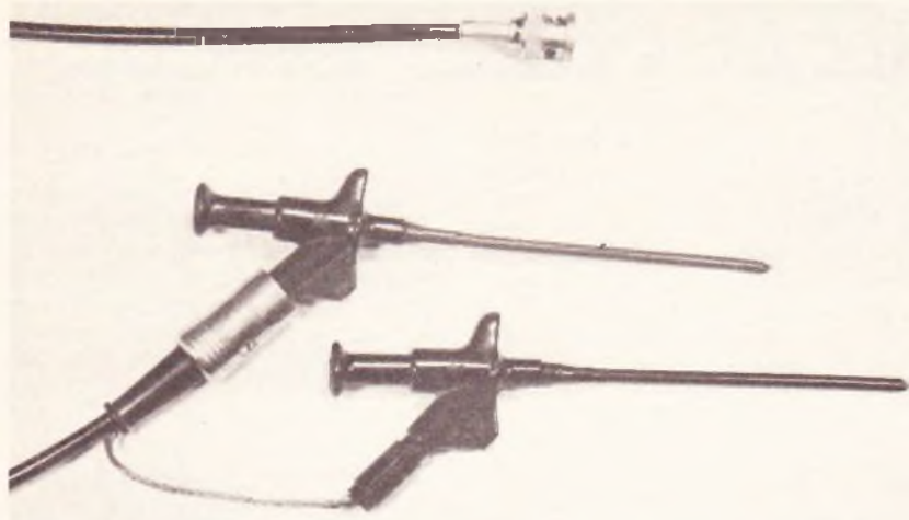
Photo 9. - Les extrémités d'une sonde : fiches BNC sur l'appareil et grip-fils sur le circuit.
