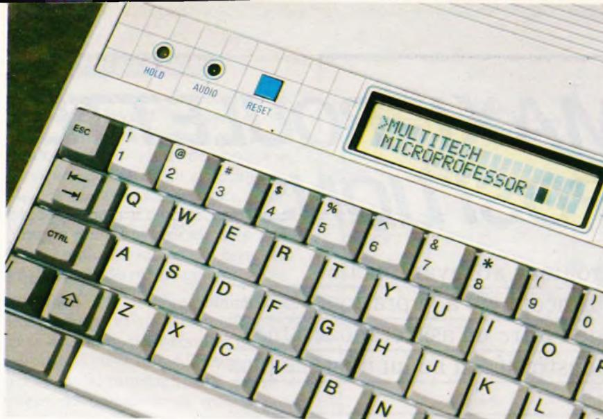
Le clavier Qwerty, les deux diodes de fonction, le bouton de reset et l'afficheur.
