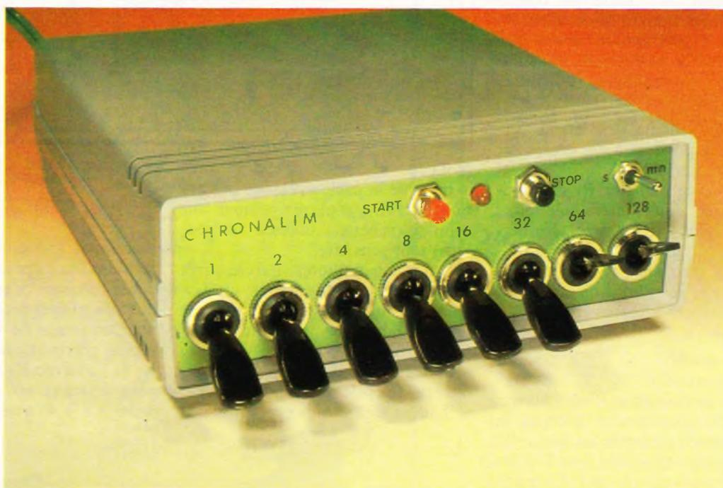
**L**a précision est de l'ordre de 1%. Il sera très utile pour alimenter en 220 V des chargeurs de batterie, pour exposer du film Posireflex, de l'époxy sensibilisé, pour préchauffer ou agiter du perchlore, etc. Nous avons utilisé le CI XR2240, plus très jeune mais toujours pas démodé; donc toujours disponible chez la plupart de nos annonceurs.
