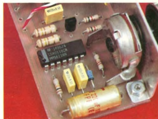
Photo 3. - Vue de l'unique circuit intégré utilisé par l'auteur.
