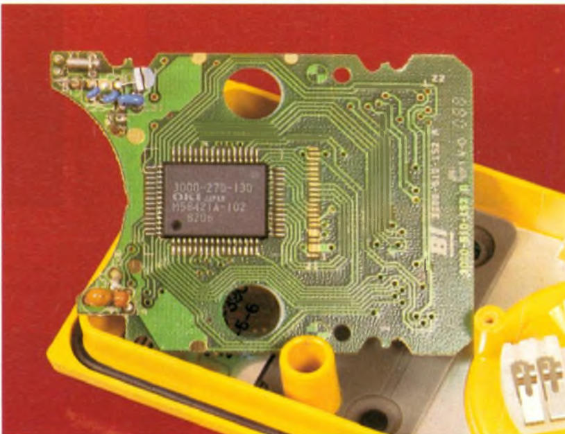
Photo 3. – Vue du circuit intégré pilotant l'appareil.
