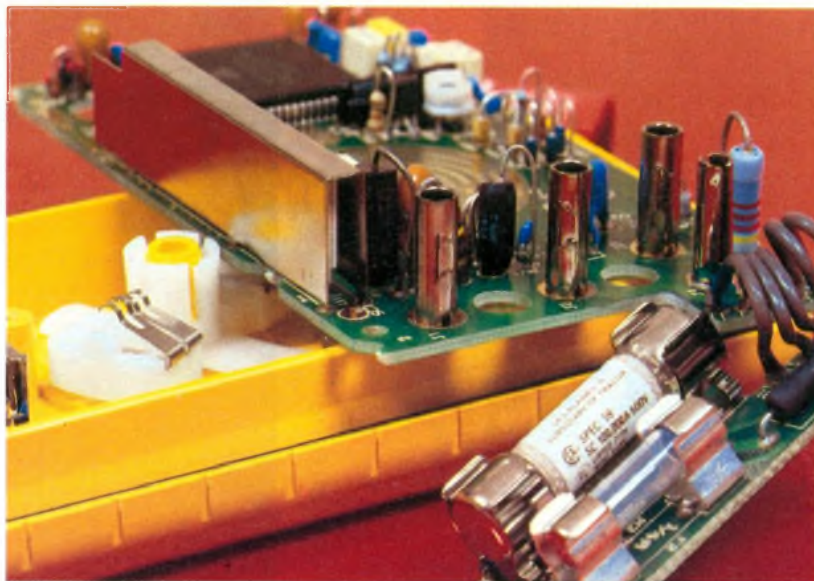
Photo 4. – Le petit circuit imprimé supporte les fusibles de protection.
