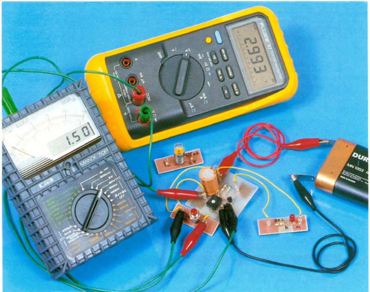
Photo 2 – Réalisation pratique du montage de la figure 1 : les multimètres mesurent les tensions U_1 et U_2 .
