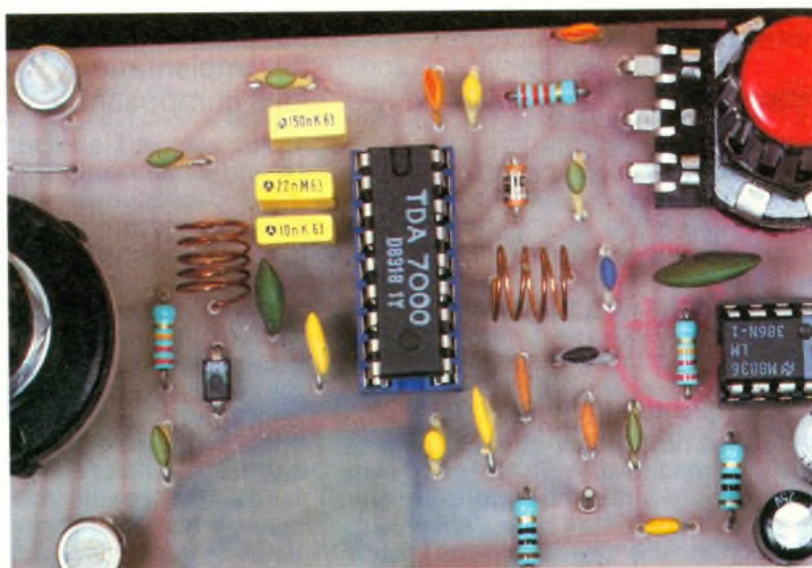
Photo 2 - Le montage utilise uniquement deux bobines à air, très facilement réalisables.
