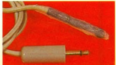
Photo 3 - La sonde, une fois recouverte de gaine thermorétractable, sera enrobée d'un joint silicone.
