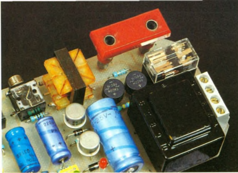
Photo 5. - Le composant rouge est une embase femelle 220 V.
