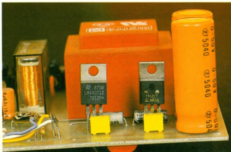
Photo 2. - L'utilisation d'AOP nécessite une alimentation symétrique + 12V/- 12V
