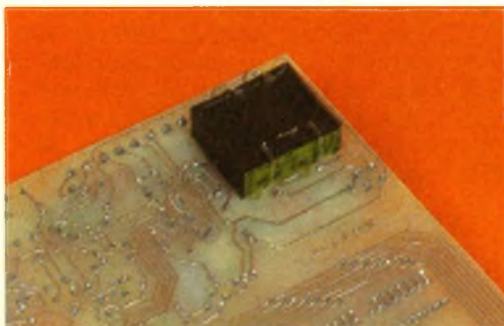
Photo 6 – Branchement du transfo.
