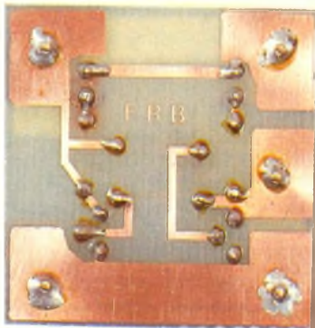
Photo 2. – Tracé de la plaque bistable.
