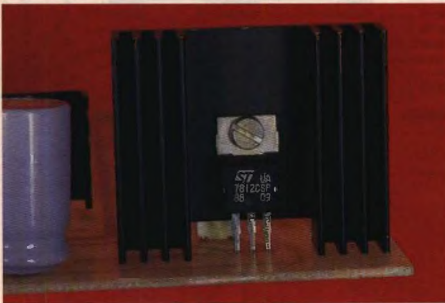
Photo 3. - Le régulateur de tension IC_1 sera monté sur un radiateur à ailettes.
