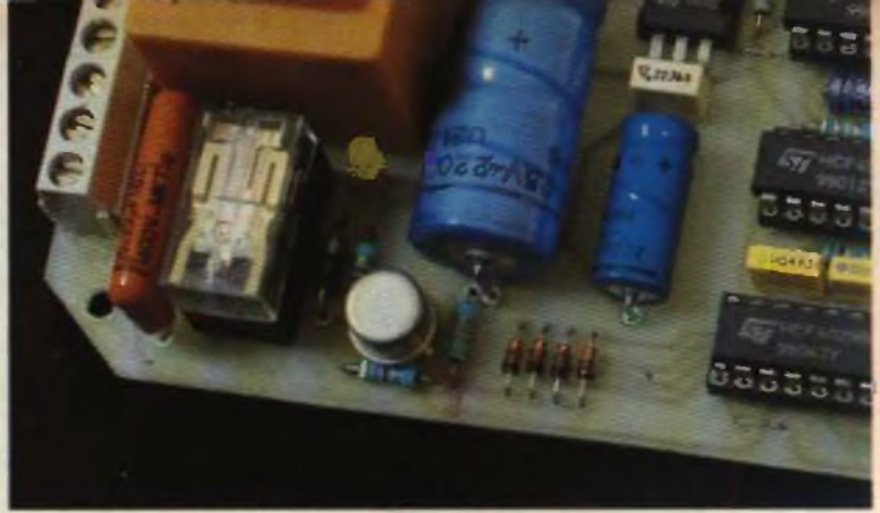
Photo 5. - Utilisation d'un relais 12 V/1 RT.
