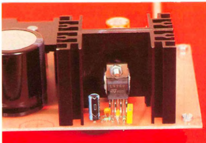
Photo 2. – Le radiateur s'impose pour une utilisation optimale de l'alimentation.
