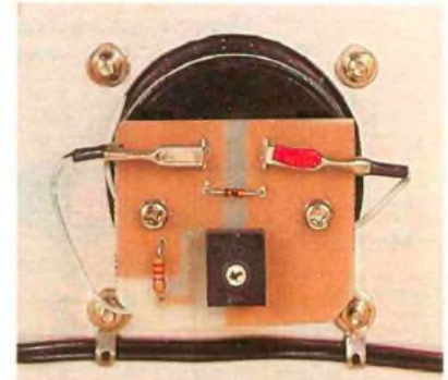
La platine de calibration du galvanomètre.
