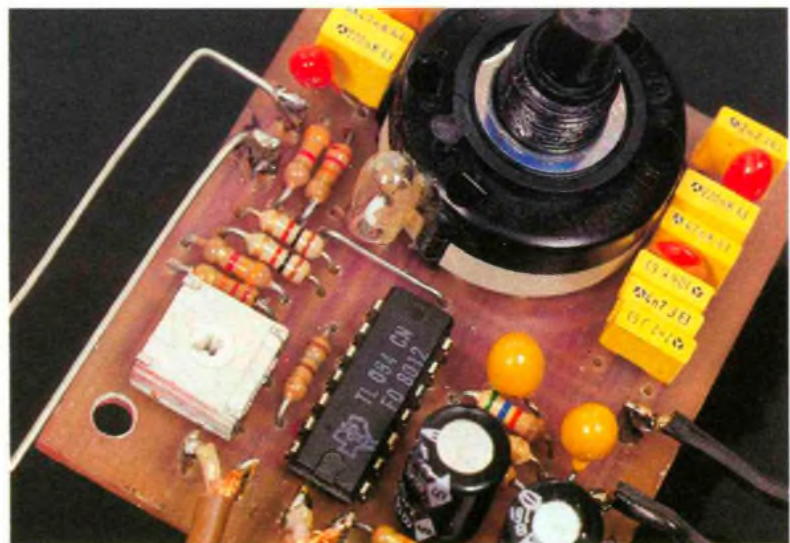
Le générateur de fonction, notez l'ampoule de linéarisation sur l'entrée inverseuse du TL084.
