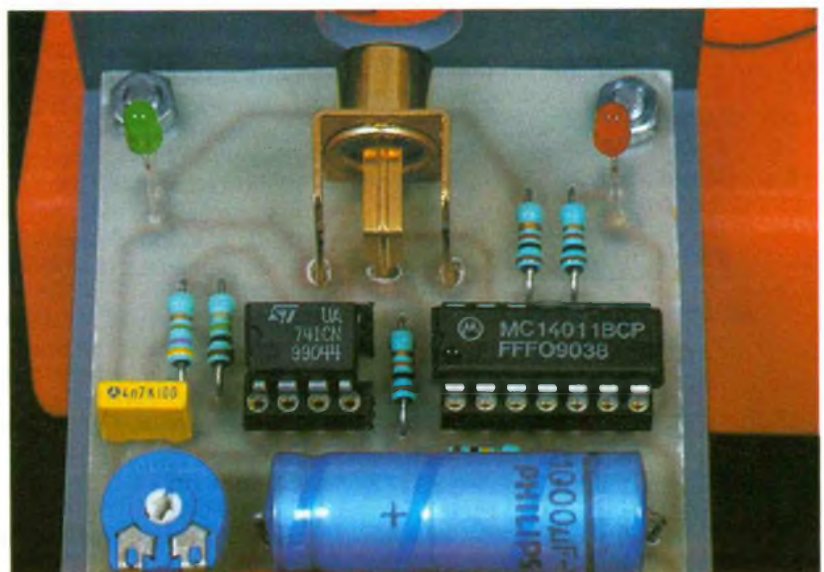
Photo 3. – La fiche CINCH permet le raccordement direct avec la sonde.
