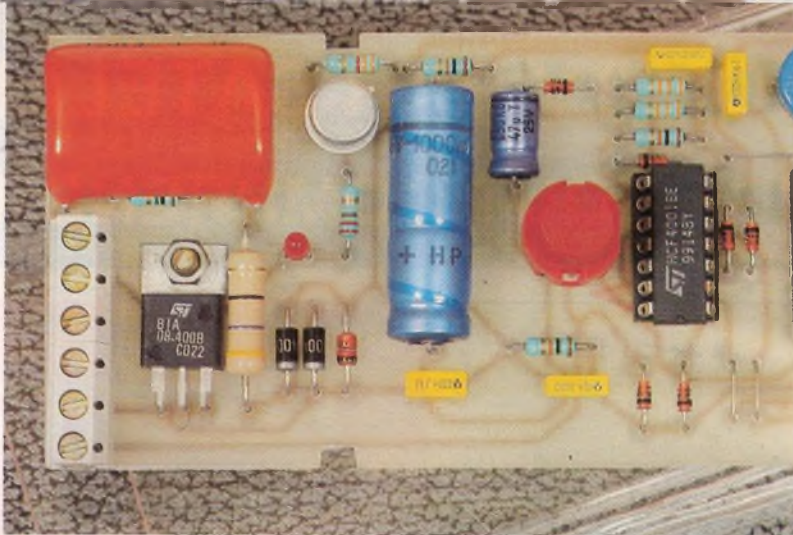
Photo 3. - Le bornier d'entrée/sortie.
