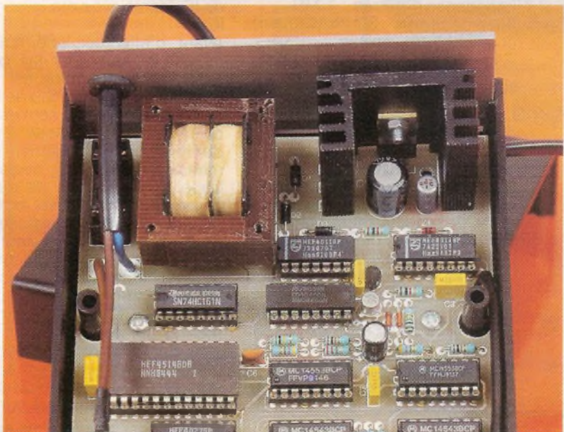
Photo 2. - L'imposant dissipateur thermique est nécessaire car le montage demande une puissance importante au régulateur.
