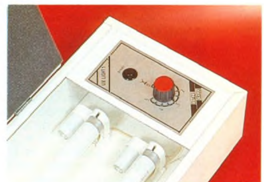
Photo 2 - Machine à insoler UV light 1.
