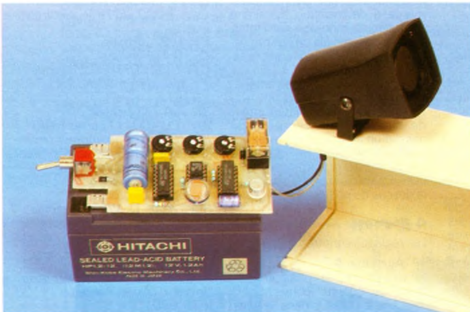
Photo 3. - La batterie au plomb prend place sous la platine.
