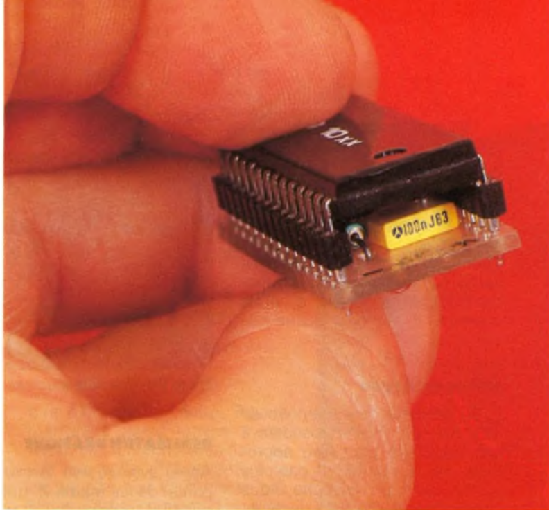
Photo 3. – Les dimensions du module n'excèdent pas celles du circuit intégré, les composants annexes étant placés sous ce dernier.
