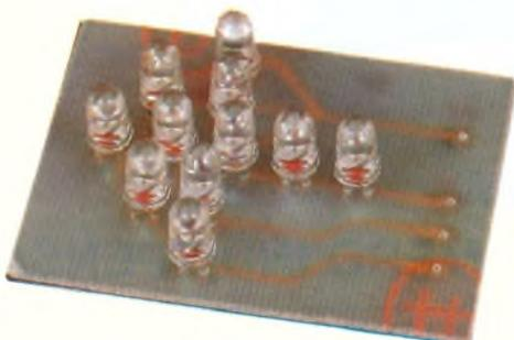
Que le lecteur se rassure, en constatant qu'il n'y a aucune résistance de limitation en série sur les LED, mais cette intensité brutale ne met pas en péril leur durée de vie, et ce n'est qu'à ce prix que l'on obtient un bel éclair bien vif, encore plus spectaculaire si l'on utilise des diodes LED à très haute luminosité. Les diodes  $D_4$ ,  $D_5$  et  $D_6$  protègent les transistors  $T_2$ ,  $T_3$  et  $R_4$  contre les surtensions selfiques à la coupure des bobines des relais.
