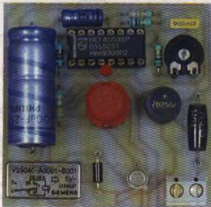
Photo 1. - Ce module dispose d'un relais de sortie.
