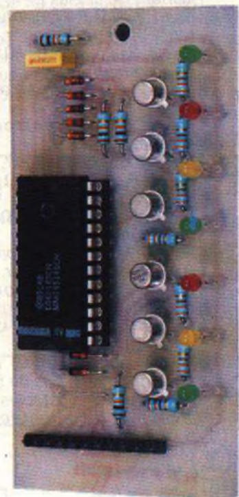
Photo 4. - Détail sur la carte d'affichage à DEL.
