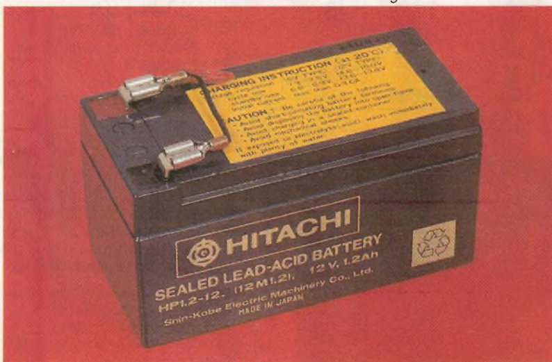
Photo 5. - La batterie étanche rend autonome ce montage.
