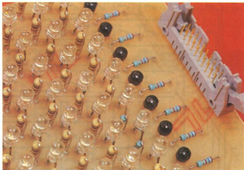
VUE SUR LES TRANSISTORS DE COMMANDE DES DEL.
