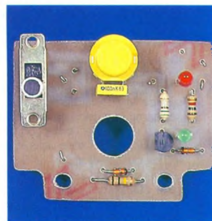
LA CARTE SUPERIEURE REÇOIT L'INTERRUPTEUR ET LE BOUTON POUSSOIR.
