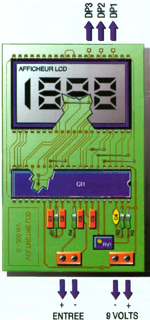
3/4 LE CIRCUIT IMPRIME ET L'IMPLANTATION DES COMPOSANTS.
