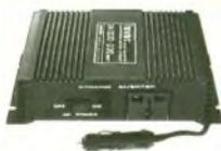
• **PDK 201** convertisseur 200 W 12 Vdc/220 Vac. Nouvelle technologie découpage transistors Mosfet. Forme compacte L 200 x 100 x H 60 mm. Livré avec adaptateur allumecigare. Consommation à vide 200 mA. Accepte fiches secteurs françaises/anglaises/américaines, etc.
