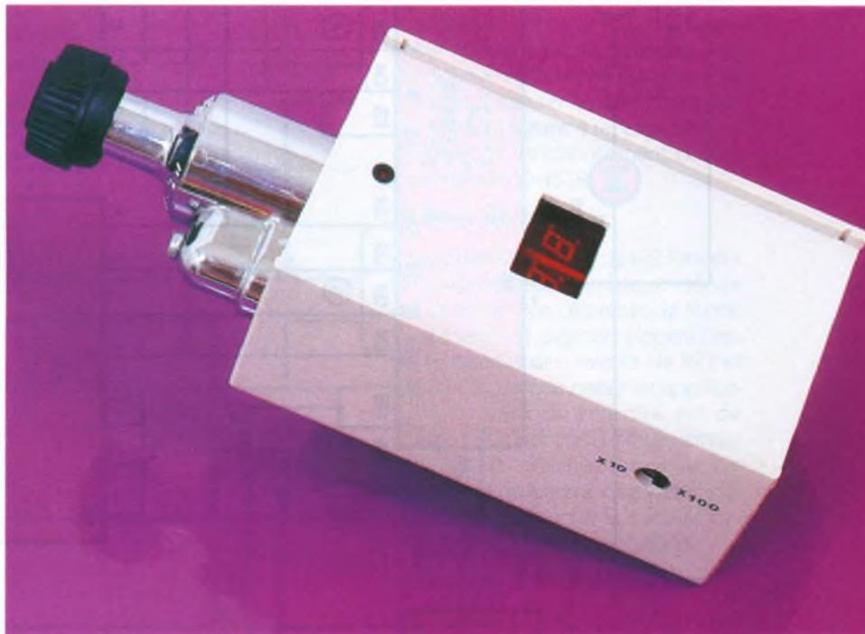
Il en résulte un appareil capable de mesurer des vitesses de rotation de 10 à 10 000 tours/minute avec une précision tout à fait honorable.
