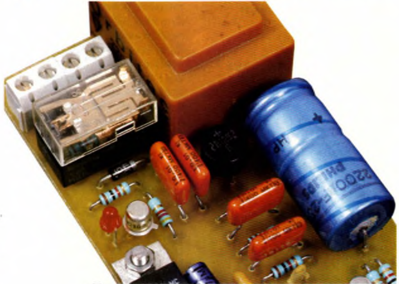
ALIMENTATION PAR TRANSFORMATEUR ET PONT DE DIODES.
