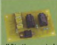
μP 71 : Commande de passage à niveau pour voie banalisée
