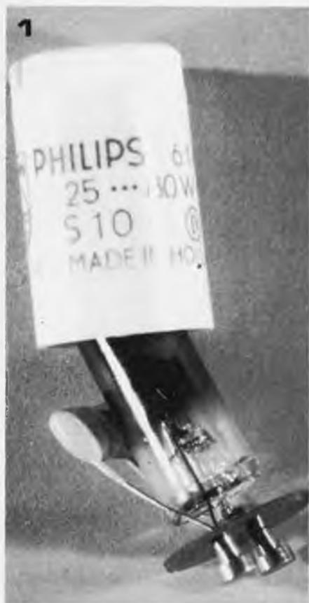
Figure 1. Photo d'un starter pour tube fluorescent partiellement démonté. Notez la présence d'un condensateur antiparasite.
