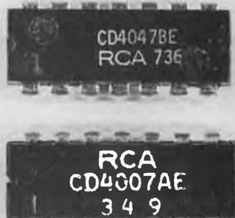
Figure 8. RCA produit diverses gammes CMOS qui sont appelées chez ce fabricant COSMOS. Tous les types commencent par deux lettres 'CD'. Des lettres suivent les quatre chiffres de la série '4000'. La dernière lettre indique le type du boîtier; par exemple, un 'E' correspond à un boîtier plastique et un 'D' à un boîtier céramique. Avant la dernière lettre, on trouve soit un 'A' (sans buffer, tension d'alimentation maximale 15 V), soit 'UB' ou 'B' (avec buffer, 18 V).
