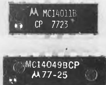
Figure 10. Motorola appelle son programme CMOS MC MOS. Le type de boîtier est indiqué par P (plastique) ou L (céramique). Lorsqu'ils sont destinés à des applications industrielles, les circuits intégrés reçoivent la lettre 'C' (CP ou CL); ils fonctionnent dans la gamme de température habituelle pour les circuits intégrés standard et sont prévus pour des tensions d'alimentation allant jusqu'à 16 V.
