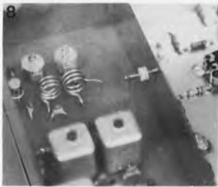
**Photo 8.** Perspective sur les enroulements L4 et L5. Notez bien le sens de rotation identique et le positionnement de la prise intermédiaire! Il est possible de constater la présence d'un "passe-fil" en téflon qui permet de faire passer le signal de part et d'autre du blindage.
