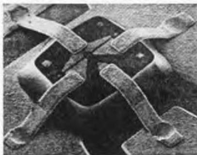
L'utilisation de grilles plus courtes permettrait d'obtenir des gains et des facteurs de bruit utilisables jusqu'à 30 GHz.
