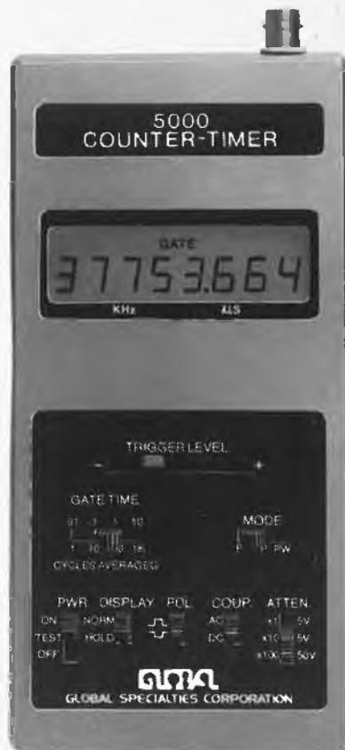
fonctionnement, de polarité, de couplage AC et DC, d'atténuation x1 - x10 - x100, de seuil et de moyennage, ainsi qu'un vernier de réglage du seuil de déclenchement.
