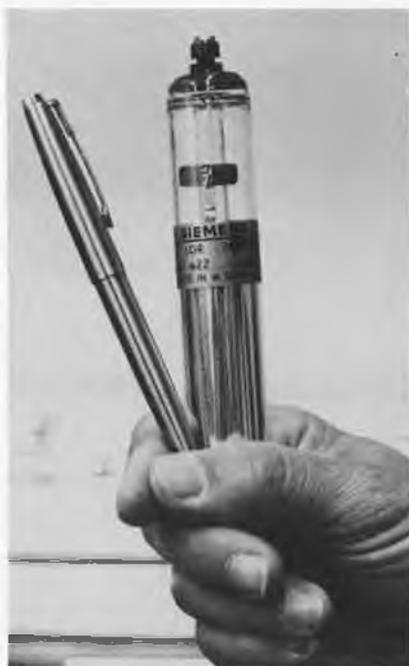
Ce paramètre facilite grandement l'incorporation du tube laser. Son faible poids, 70 grammes, est particulièrement apprécié lors du montage dans les appareils mobiles. Le LGR 7647 convient donc aux scanners portables (entrée d'un code à barres); il est également apprécié comme aide au pointage pour les armes et les flèches lumineuses, comme laser portable dans le bâtiment, comme instrument didactique ou comme laser servant de niveau.
