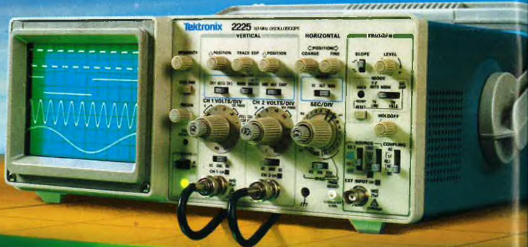
Dominer sa technologie pour Tektronix c'est être capable, à la fois, d'améliorer ses performances et de baisser ses prix. L'oscilloscope portable Tektronix 2225 en est la preuve : bande passante de 50 MHz ; sensibilité de 500  $\mu$ V pour la mesure des signaux faibles ; balayage alterné pour une analyse détaillée ; système de déclenchement complet et automatique ; plus la simplicité d'utilisation et la fiabilité Tektronix, la tout pour **7500 Francs \***
