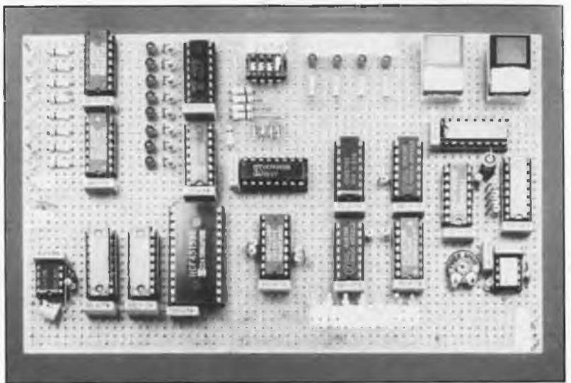
trée CLK, le niveau logique des sorties Q et  $\bar{Q}$  est inversé. A chaque nouvelle pression sur S1, on passe donc du mode d'incrémentaion manuelle au mode d'incrémentaion automatique, ou vice versa. Le mode en vigueur est indiqué par l'une des deux LED D17 et D18. Le réseau RC R1/CI relié à l'entrée S de FF1 met le multiplexeur en mode d'incrémentaion manuelle lors de la mise sous tension.
