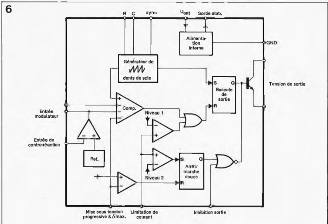
Figure 6. La structure présentée ici est celle de la quasi-totalité des circuits de régulation pour alimentation à découpage.
