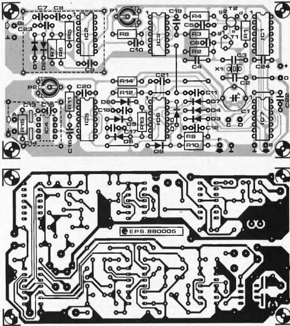
Figure 5. Représentation de la sérigraphie de l'implantation des composants du pré-diviseur. Tous les circuits intégrés, exception faite de IC4, seront montés sur support. Les lignes pointillées indiquent la position des tôles de blindage.
