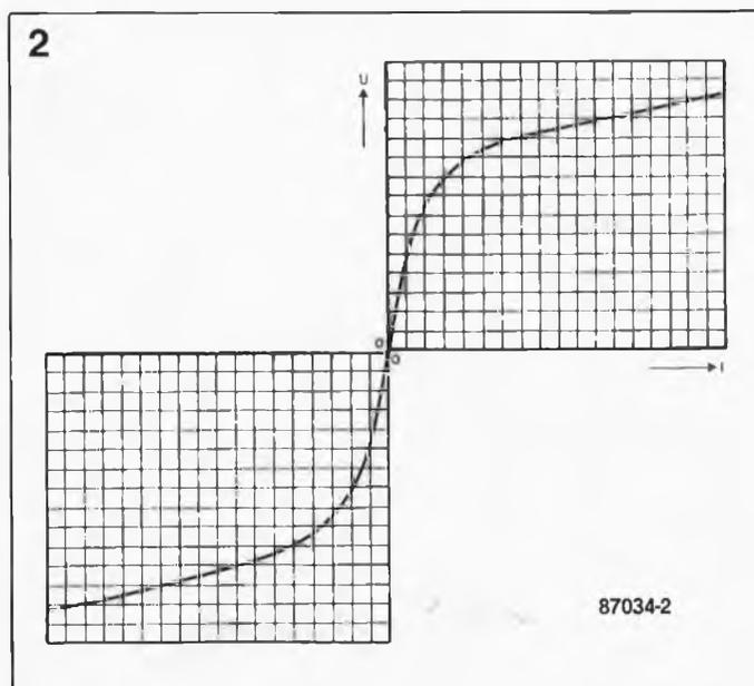
Figure 2. La caractéristique  $U/I$  d'un varistor ou varistance ressemble à celle d'une diode. C'est bien sûr la symétrie qui caractérise le varistor par rapport à la diode.
