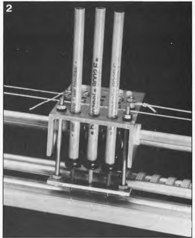
Figure 2. Le chariot des plumes. Pour lever et baisser les plumes d'une manière fiable, on peut les munir d'un passe-fil en caoutchouc.
