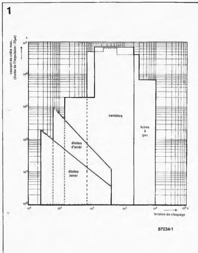
Figure 1. Mise en présence des performances de divers composants utilisés pour la protection contre les surtensions.
