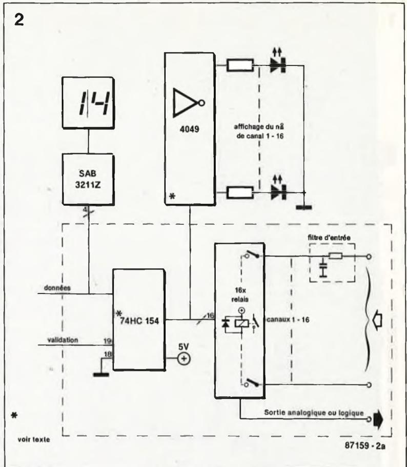
Figure 2. Synoptique du schéma de la figure 1 transformé de telle sorte qu'il puisse commander des relais. Dans un cas comme dans l'autre, l'affichage numérique du numéro de canal est une option facile à supprimer.
