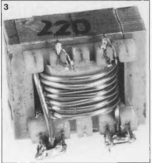
**Figure 3. Photographie du transformateur rebobiné: le nouvel enroulement secondaire devient le primaire et doit supporter le courant consommé par les charges connectées à la ligne électrique interrompue.**
