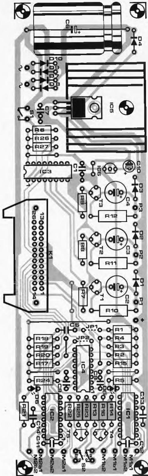
Figure 7. Représentation de la sérigraphie de l'implantation des composants du circuit imprimé conçu à l'intention de la table traçante. Outre celui du régulateur de tension (IC5), il faudra également veiller au refroidissement de IC1 et de IC2.
