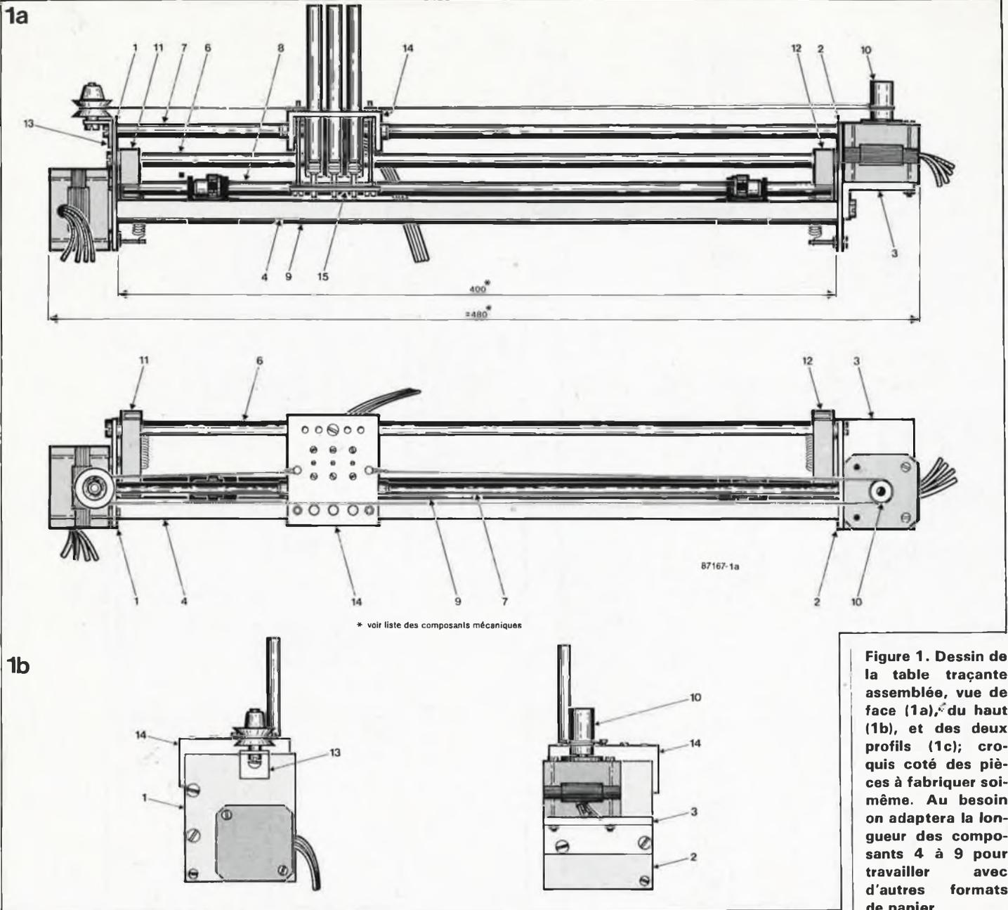
Figure 1. Dessin de la table traçante assemblée, vue de face (1a),<sup>2</sup> du haut (1b), et des deux profils (1c); croquis coté des pièces à fabriquer soi-même. Au besoin on adaptera la longueur des composants 4 à 9 pour travailler avec d'autres formats de papier.
