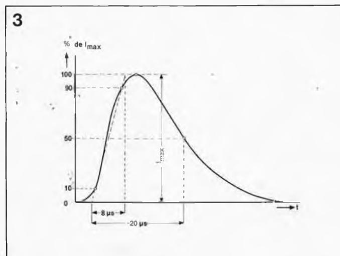
Figure 3. Pour déterminer la valeur maximale des pics de courant admissibles dans un composant de protection, on fait appel à un courant dont la courbe est représentée ici. Le cycle de reproduction de ce choc de courant est de 30 secondes ou 3 minutes, selon la norme en vigueur.
