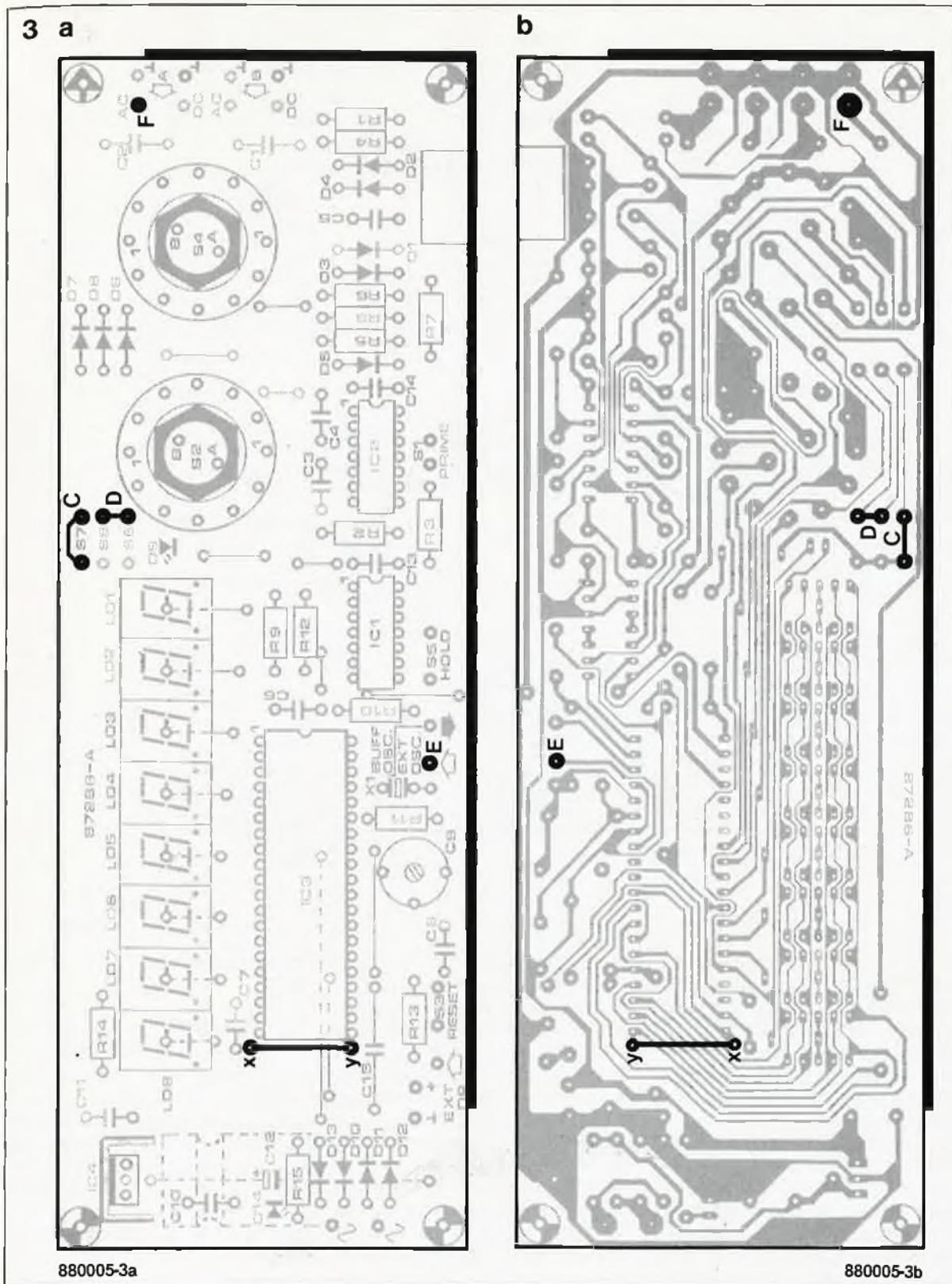
**Figure 3.** Les adaptations sur la platine du fréquences-mètre se limitent à l'implantation de trois ponts (X-Y, C et D) et à la mise en place aux points indiqués de picots sur lesquels seront soudés des morceaux de fil interconnectant les deux platines.
