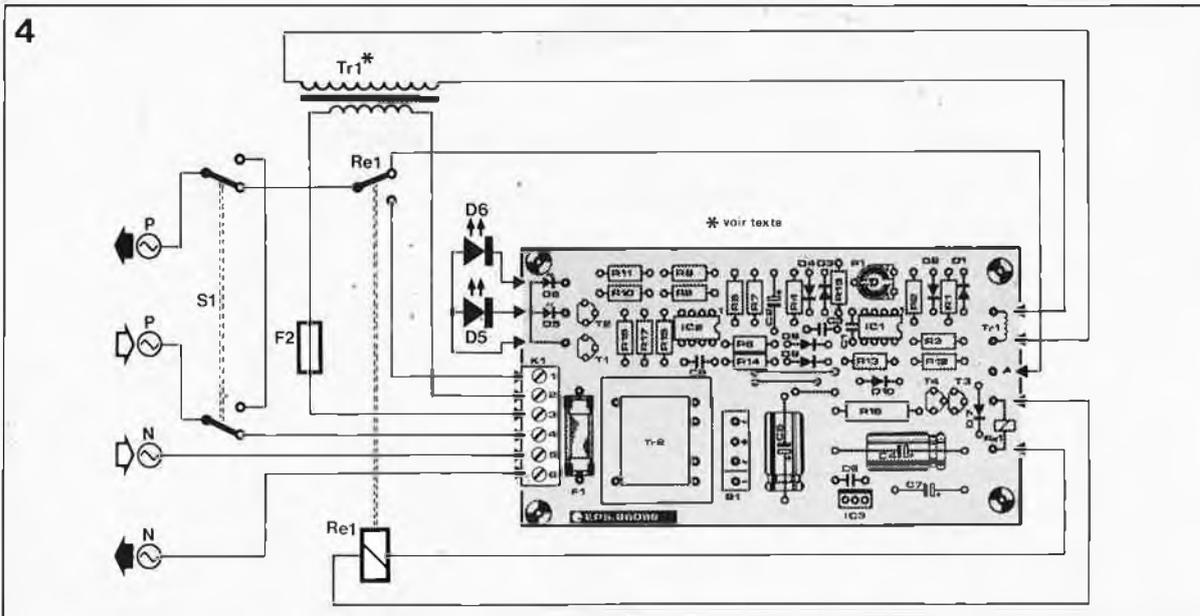
**Figure 4. Plan de câblage de l'interrupteur de ligne dans un réseau électrique alternatif. La connexion de la phase marquée d'une flèche blanche se trouve en aval du disjoncteur ("différentiel").**
