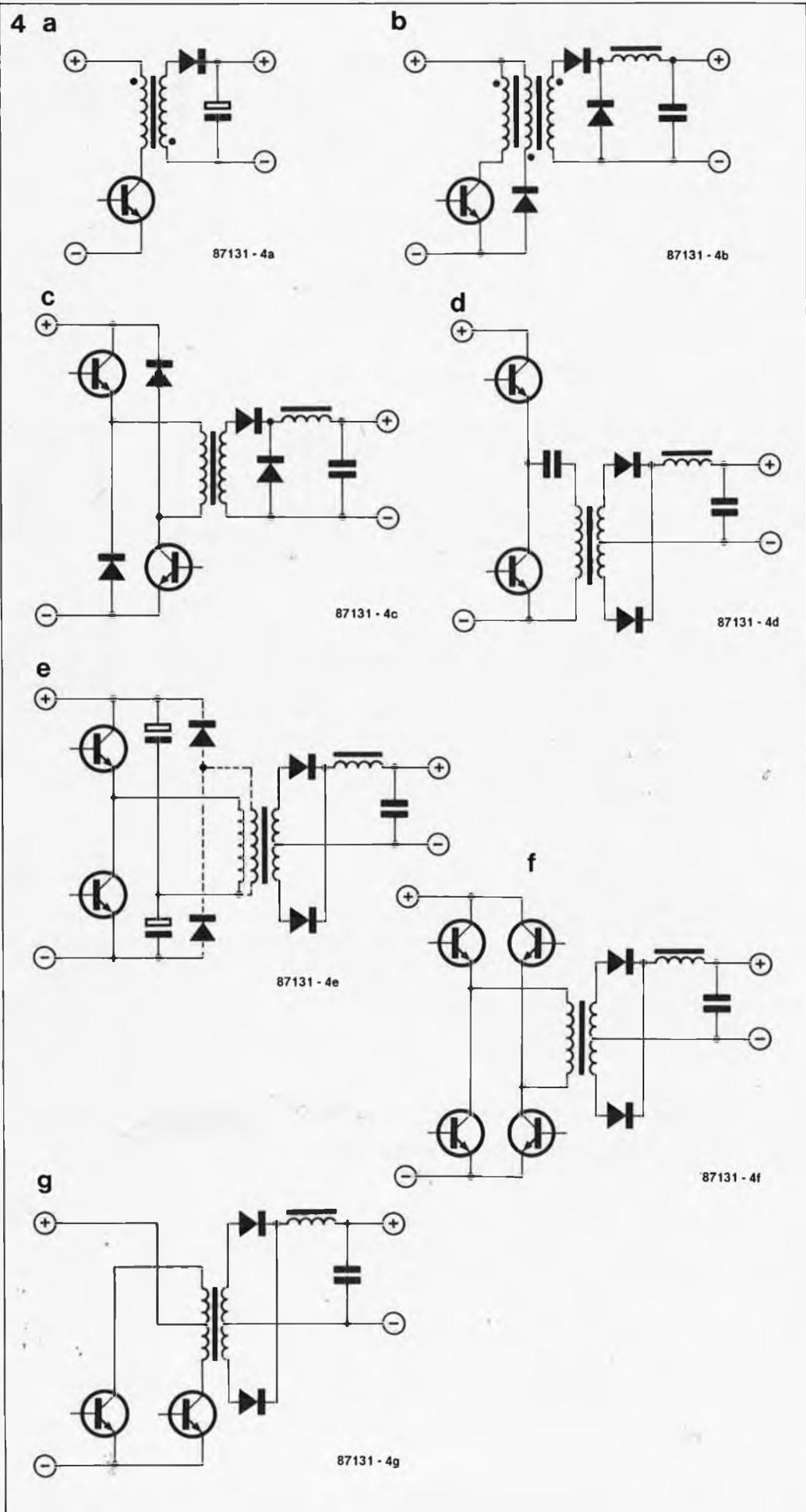
Figure 4. L'étage de puissance peut prendre de nombreux aspects. Seule la première alimentation est du type *fly-back*; le transformateur proprement dit est alors l'inductance de stockage d'énergie. Tous les autres schémas sont du type *forward*.
