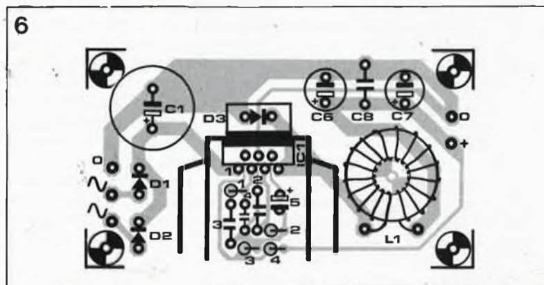
**Figure 6. Représentation de la sérigraphie de l'implantation des composants d'un circuit imprimé conçu pour cette alimentation à découpage.**
