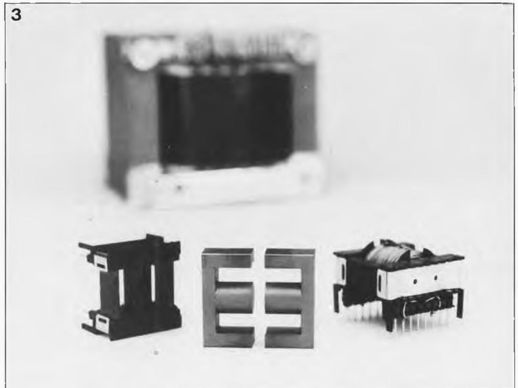
Figure 3. Comparaison entre un transformateur à tôles de fer doux traditionnel (arrière-plan) et un noyau de ferrite de même puissance (à une fréquence plus élevée il est vrai). Il s'agit d'un noyau ETD (*Economic Transformer Design*), un standard que l'on retrouve dans de nombreuses alimentations à découpage.
