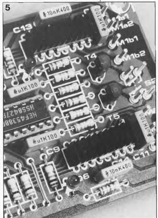
d'utiliser un support et on les implantera directement sur le circuit imprimé pour que par l'intermédiaire des broches le plan de masse pris sous ces circuits intégrés fasse office de radiateur. IC4, un circuit de la série 4000, présente l'inconvénient d'avoir une entrée qui ne soit pas parfaitement compatible TTL. Cependant en pratique il n'y a pas de raison de s'attendre à des problèmes (et cela grâce aux résistances de polarisation R4 et R20). En cas de
