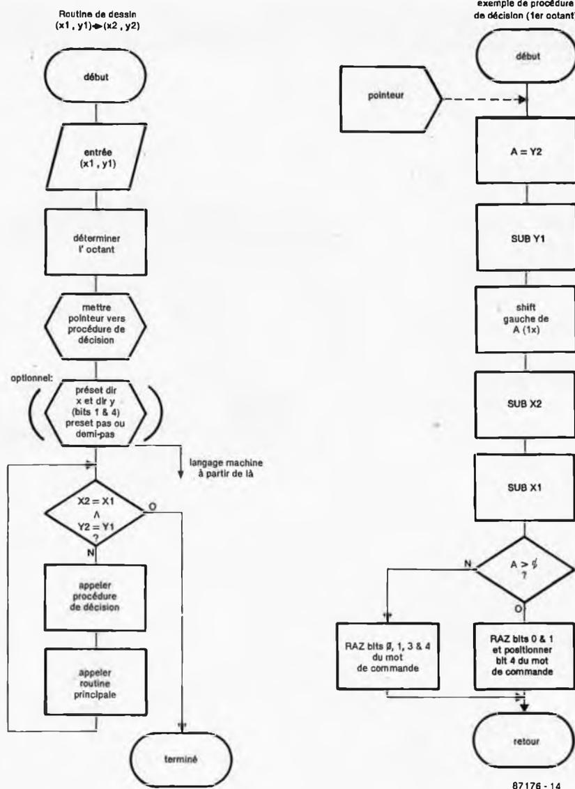
Figure 14. Exemple d'ordinogramme pour tracer des lignes suivant l'algorithme de Bresenham (14a). A côté, une des huit procédures de décision (14b, voir en outre le tableau 2).
