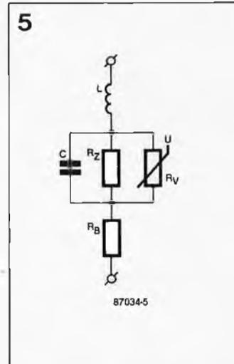
Figure 4. Schématisation de la structure interne d'une varistance.
