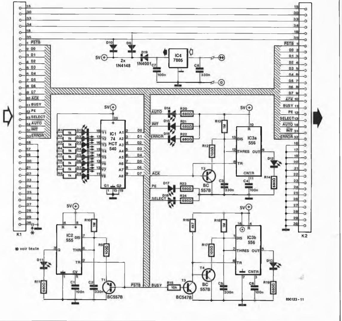
Figure 3. L'électronique du moniteur Centronics.
