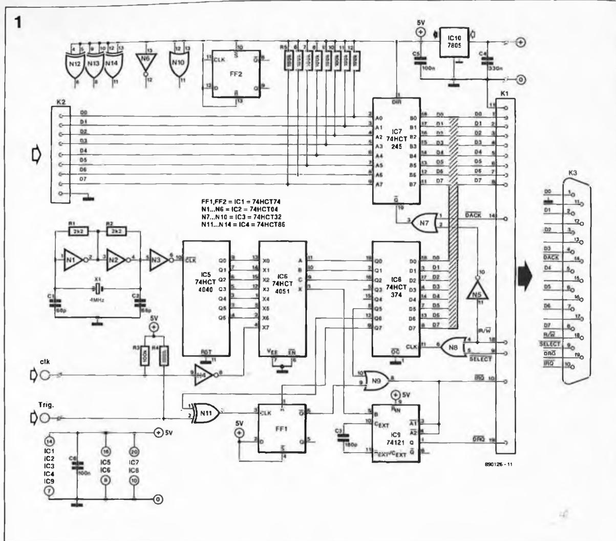
Figure 1. Le schéma de l'analyseur logique. La simplicité de l'électronique est en grande partie due à la puissance du logiciel, l'ordinateur se chargeant de la prise en compte et du traitement des données.
