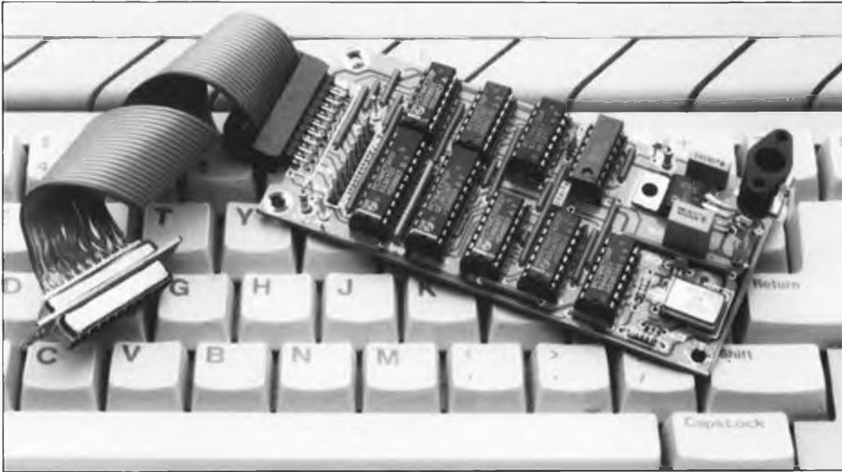
**Exemplaire terminé de l'analyseur logique sur le clavier d'un Atari-ST. Ce montage constituera un auxiliaire de mesure précieux pour de nombreux amateurs d'électronique numérique.**
