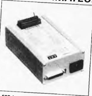
Le EPP-1 est un programmeur intelligent en mesure de traiter, entre autres, les composants archi-connus de la famille des 2716 aux 27612. Il est en outre en mesure de lire et (E)PROM) et 2864 (E)PROM).
