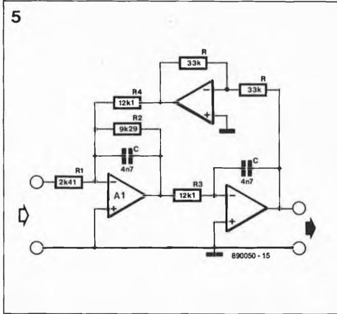
On constate que le terme de fréquence centrale du filtre passe-bande ne fait son apparition dans les calculs qu'au moment de déterminer la valeur des composants ajoutés lors de la transformation.
