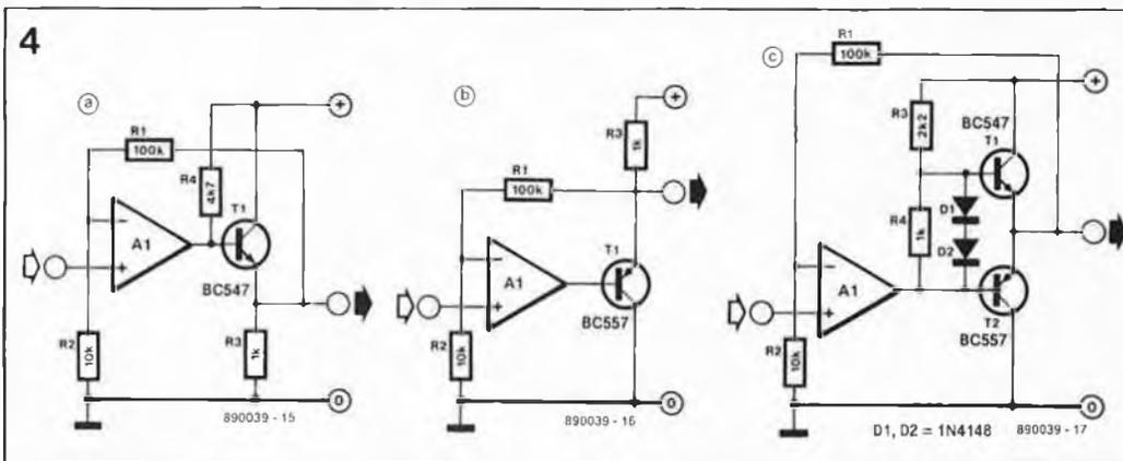
**Figure 4. Circuit auxiliaire utilisable avec des courants de sortie plus importants: drainé par à une charge connectée à la masse (a), au plus (b) ou branchée symétriquement (c).**
