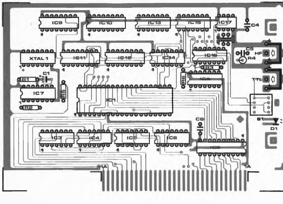
**Figure 3. Représentation de la sérigraphie de l'implantation des composants.** Il s'agit d'une platine à double face à trous métallisés. L'implantation des composants est relativement aérée et ne devrait donc pas poser de problème particulier.
