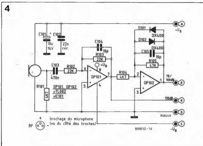
Figure 5. Schéma du circuit principal du sonomètre.
