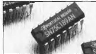
Destinés à être les remplaçants directs, à faible consommation, des standards industriels SN75188 et SN75189/A respectivement, ils permettent de réduire d'environ 2 000 fois la consommation totale.
