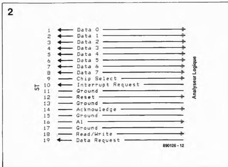
Figure 2. Brochage du connecteur de DMA de l'Atari ST. La présence de l'interface DMA permet un échange des données entre l'ordinateur et tout périphérique auquel lui est connecté par l'intermédiaire de cette interface.
