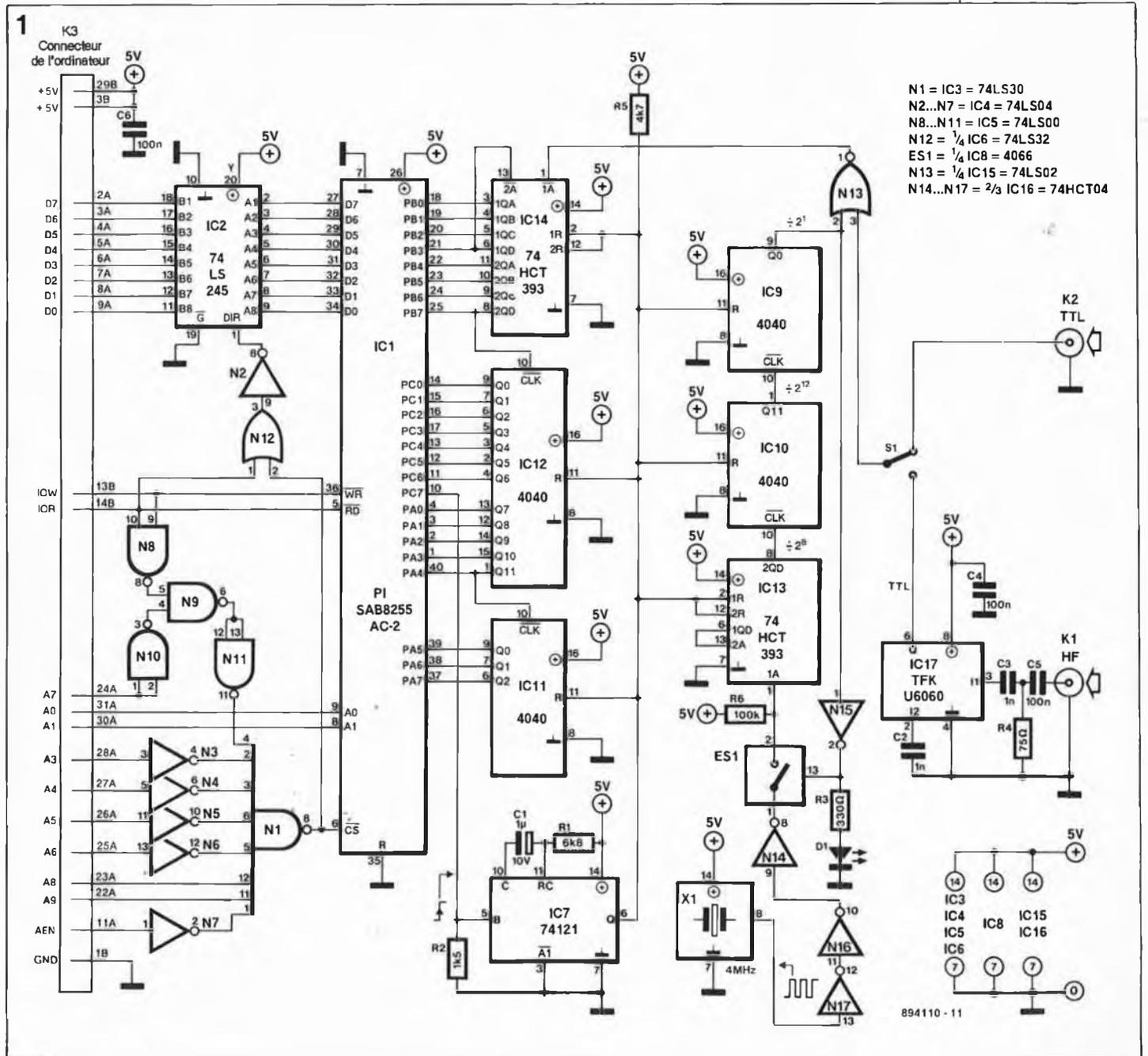
**Figure 2. Comme on peut s'y attendre, le gros du travail est pris en compte par le 8255 qui se charge de la gestion en mode 0 du transfert des données entre l'ordinateur et la chaîne des compteurs.**
