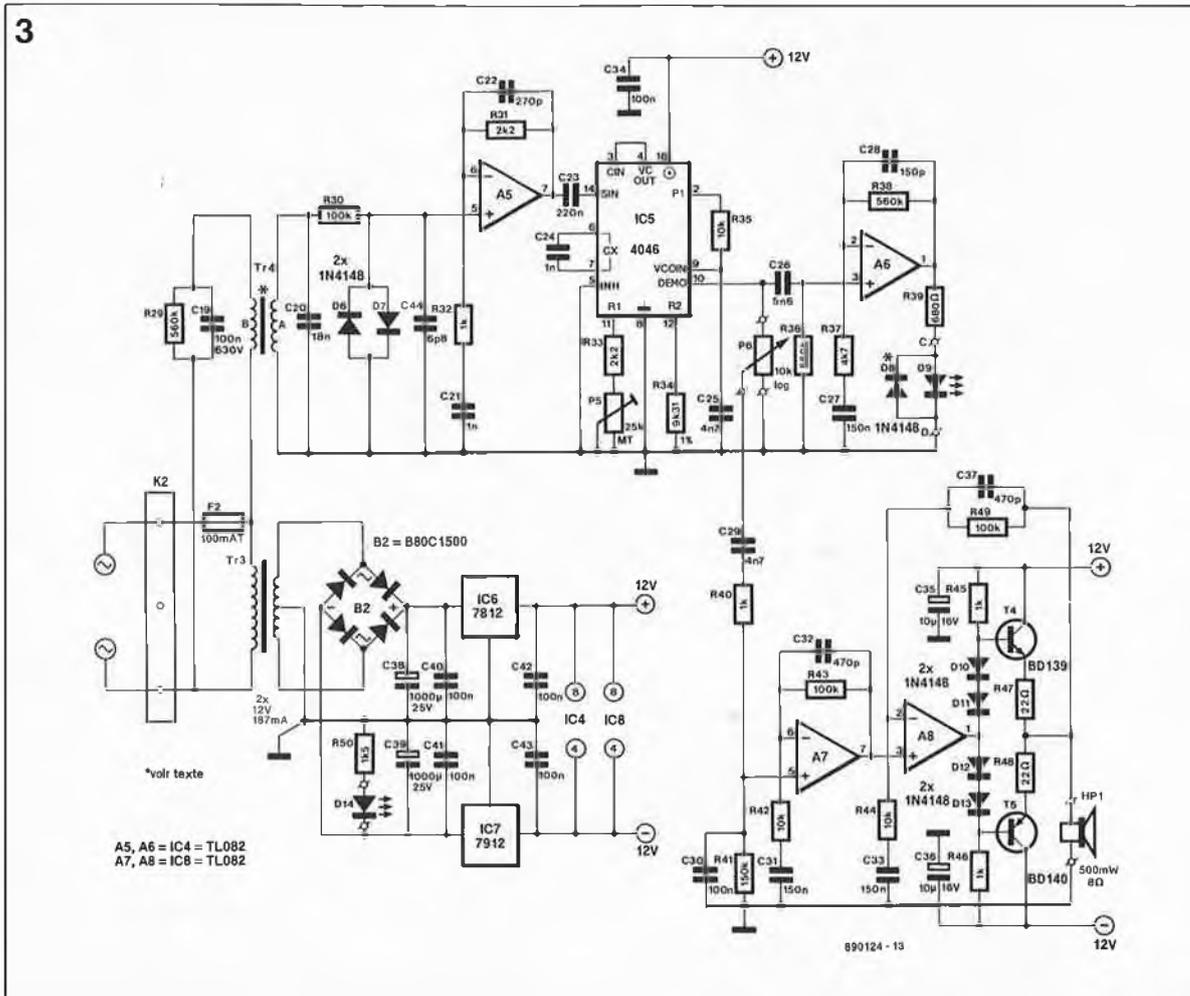
Figure 3. L'électronique complète du récepteur.
