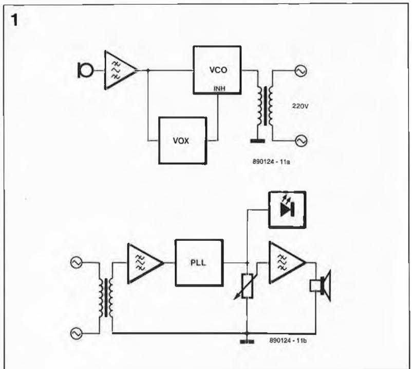
Figure 1. Synoptiques de l'émetteur (a) et du récepteur (b).
