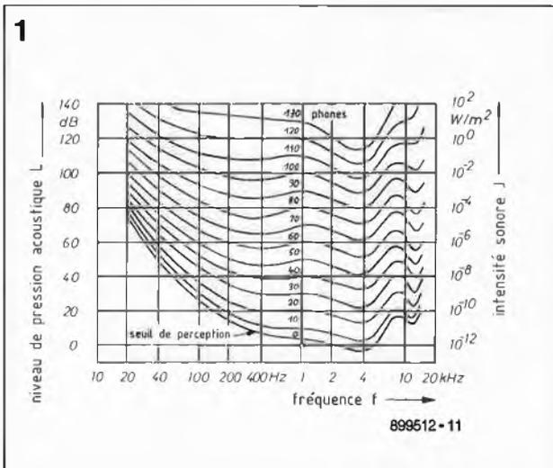
Figure 1. Evolution de la réponse en fréquence d'une oreille normale à différents niveaux acoustiques (courbes d'équivalence enregistrées avec signaux sinusoïdaux).
