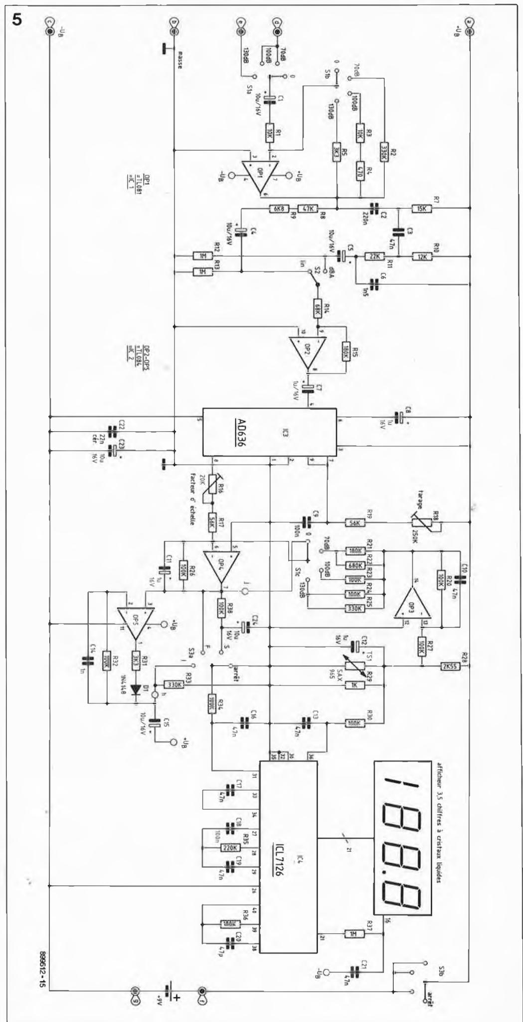
provenance du préamplificateur à l'entrée de l'amplificateur opérationnel de commutation, OP 1 et les composants annexes. Le second circuit du commutateur rotatif S1, S1b, permet la sélection du gain de cet amplificateur opérationnel puisque c'est le rapport entre la valeur de la résistance mise dans la ligne de contre-réaction et celle de la résistance R1 qui détermine le facteur d'amplification (gain). Le condensateur C1 assure le découplage en tension continue.
