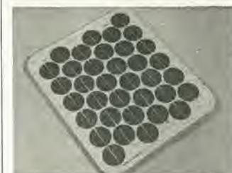
premorienza dei dispositivi. Un rivestimento in fibra rinforzata da poliesteri protegge i moduli da un ambiente rude, compresi gli estremi immaginabili, così come dalla corrosione operata dalla sabbia e dai raggi ultravioletti. Un ulteriore pregio del progetto è la facilità con la quale è possibile cambiare le dimensioni dei moduli. Se è necessario, ulteriori pile solari possono esservi inserite per soddisfare le specifiche dei clienti.
