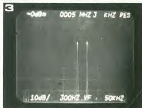
Foto 3. Segnali in ingresso identici a quelli relativi alla foto 1, ma P1 è in questo caso regolato per il guadagno minimo. La distorsione di intermodulazione è migliorata di 10 dB.
