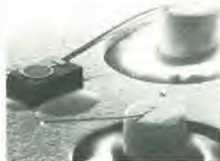
trasmettitore. Con un tempo di risposta di 10 ns in emissione e di 2 ns in ricezione, possono essere ottenute velocità di trasmissione delle informazioni superiori a 10 Mbit/s
