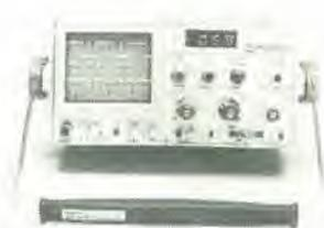
L'autonomia è di 5 ore con solo l'oscilloscopio in funzione e di 3 ore e mezza quando entrambi gli strumenti sono accesi.
