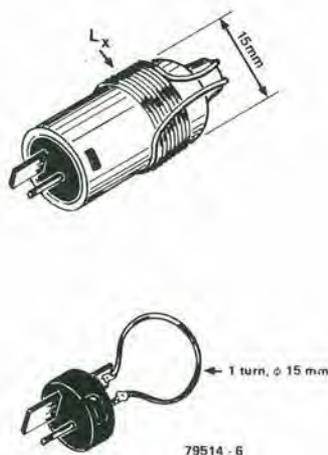
Figura 6. Questa figura mostra come si possano avvolgere le bobine su di uno spinotto per altoparlante. Le spire devono essere allontanate per quanto possibile dai reofori metallici della spina, per evitare perdite di energia.
