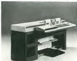
peculiarità del modello P312. La capacità di memoria è pari a 16 o 32 Kbytes, la lunghezza delle parole è variabile e il sistema di programmazione è il PHOCAL.
