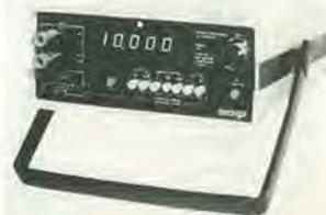
Esso è particolarmente utile per le misure di resistenze capacitive e induttive di alternatori, trasformatori, bobine di relè ... Può anche essere usato come misuratore di quozienti con un resistore standard e un'alimentazione esterna, in 2 gamme di misura da 0 al 20% o da 0 a 20 volte il resistore standard.
