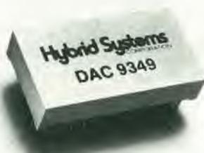
ingressi binari, offset binari o BCD. Il funzionamento può avvenire o con un riferimento interno di precisione o con una sorgente esterna a -10V. Il settling time nel peggiore dei casi è 15 $\mu$ s, e la linearità entro  $\pm 0,0125\%$  viene conservata in tutto il range di temperatura da 0 a +70°C. Il DAC 9349 richiede  $\pm 15$ V come alimentazione e ha un consumo massimo di 300 mW.
