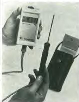
temperatura di funzionamento da 0 a 50°C e una capacità di conteggio di ±2000 punti per il voltmetro digitale.
