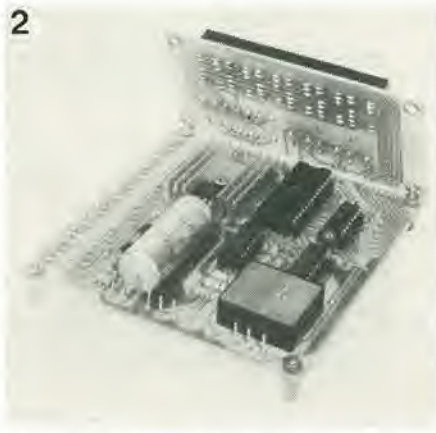
Foto 2. Un suggerimento per il montaggio delle basette stampate si vede in questa fotografia.
