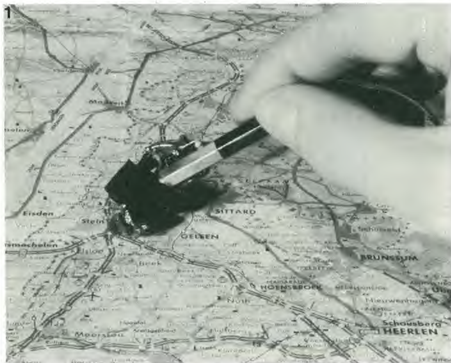
Foto 1. Una soluzione alternativa per costruire il sensore. Questo non funziona secondo il principio dell'interruzione della luce, ma impiega la luce riflessa da quadratini bianchi e neri. Questo è il motivo per cui tale tipo di sensore deve essere accuratamente schermato dalla luce esterna.
