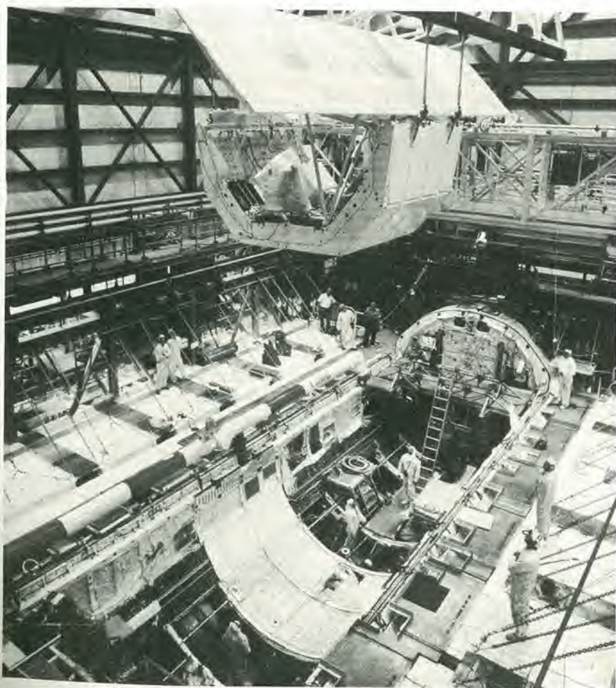
Figura 1. Inserimento del portastrumenti nella stiva dell'Orbiter (STS-2)
