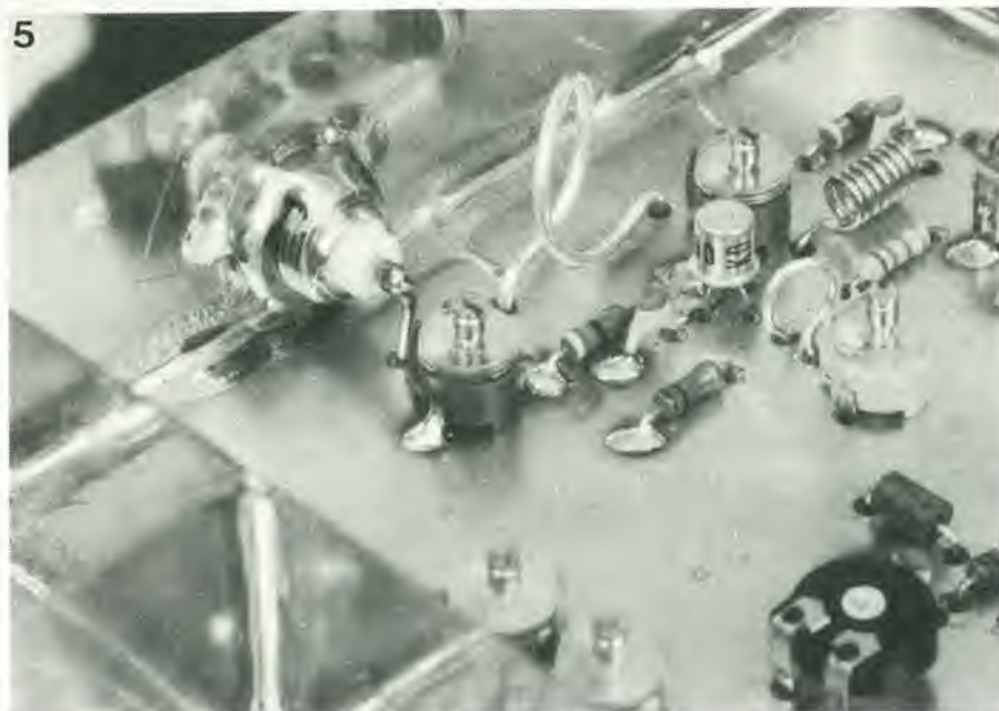
Foto 5. Lo stadio d'uscita del transverter. Si possono usare diversi tipi di transistori, come per esempio il BFY 90 impiegato in questo caso.
