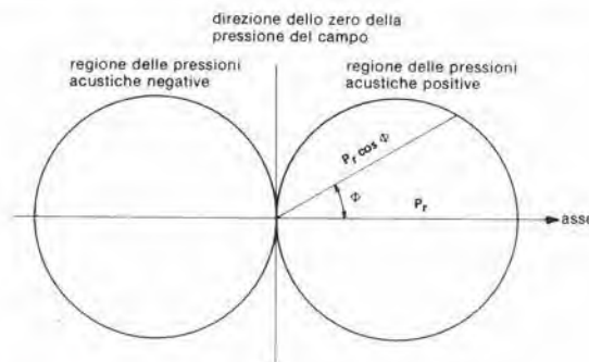
Figura 9. La cosiddetta sagoma di irradiazione di un dipolo.
