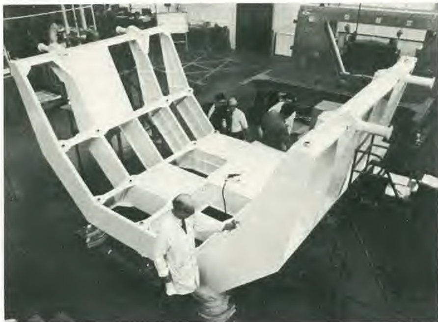
Figura 2. Struttura del portastrumenti dello Spacelab.
