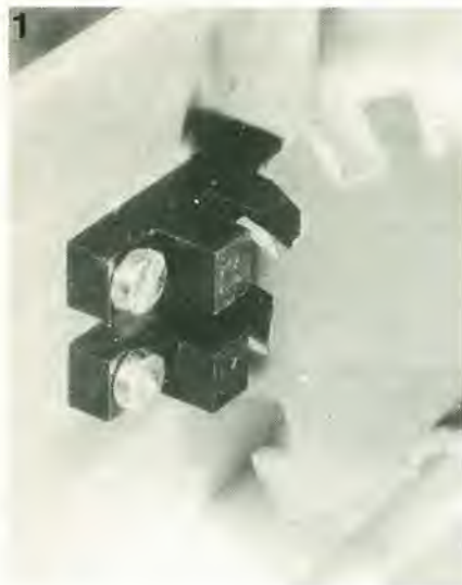
Foto 1. Gli optorivelatori vanno posizionati in modo che il raggio di luce che va dal LED al fototransistor sia interrotto dalle palette del disco rotante.
