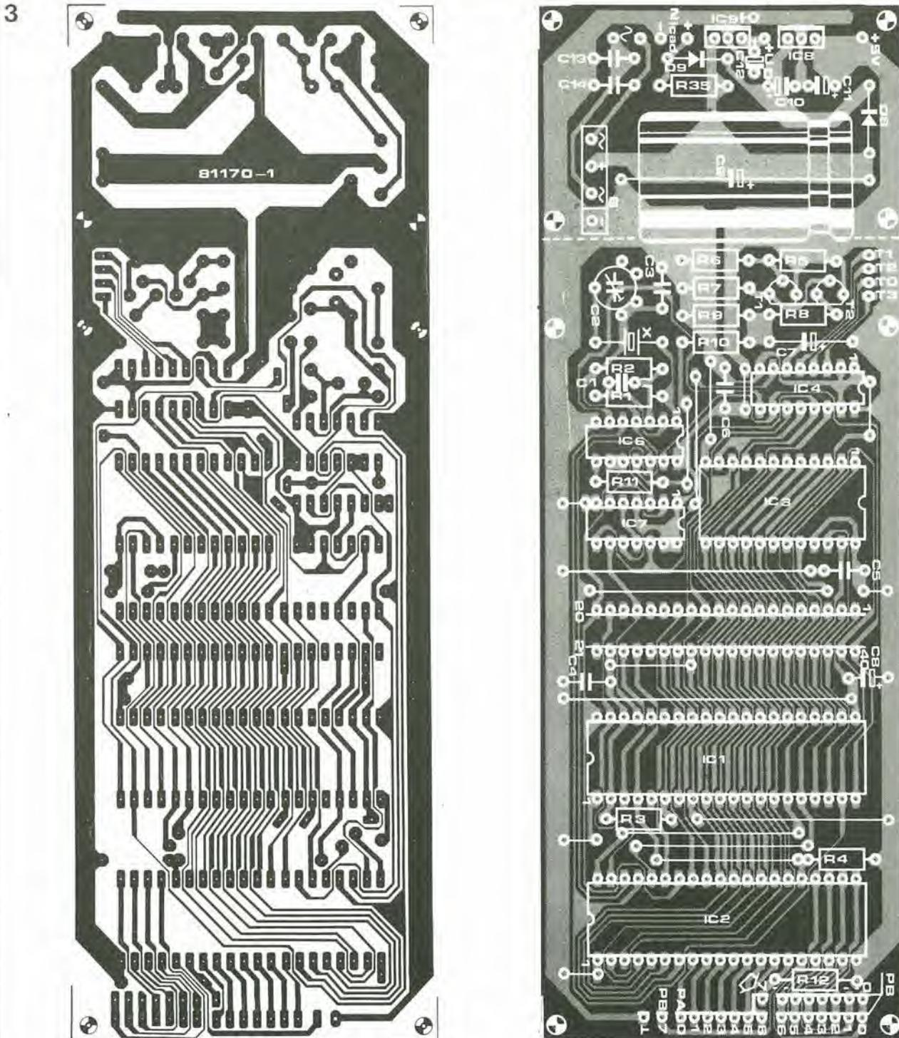
Figura 3. Piste di rame e disposizione dei componenti sul circuito stampato del microprocessore. Il circuito stampato è l'EPS 81170-1 appartenente alla "casalinga 6502" dell'articolo apparso sul numero di novembre 1982. Le resistenze R12, R35 ed il diodo D9 non saranno necessari.
