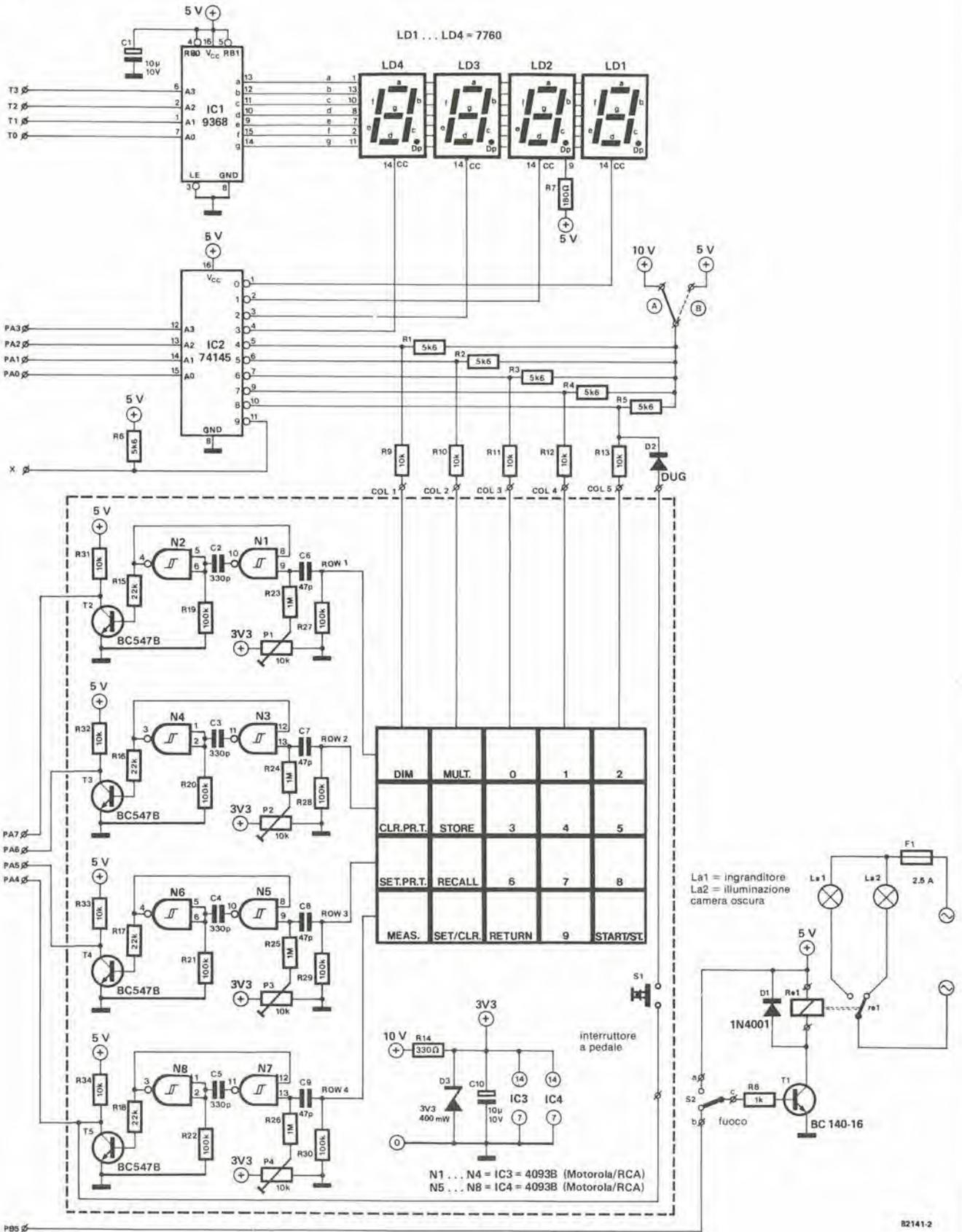
Figura 2. Schema elettrico della tastiera e del display. La tastiera è del tipo capacitivo e necessita soltanto di un leggero tocco per funzionare.
