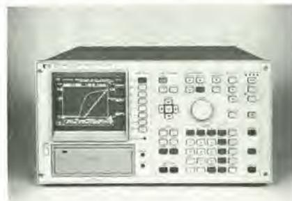
La tastiera del computer dell'HP 4145A è dotata di 11 operatori algebrici, della costante di Boltzman (k), della costante dielettrica del vuoto (e) e della carica dell'elettrone (q), permettendo così all'operatore di elaborare i dati di prova e calcolare i parametri da visualizzare.
