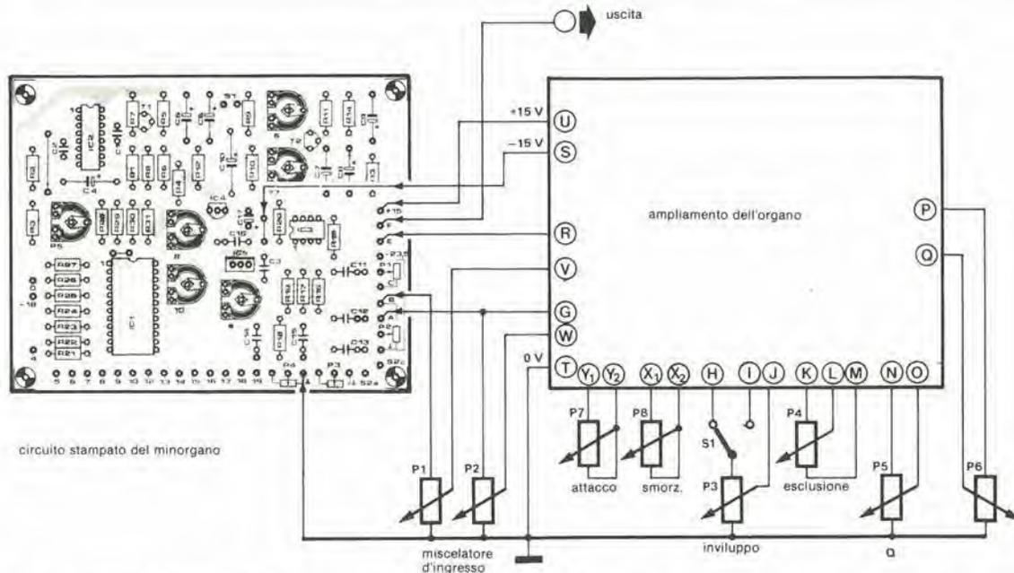
Figura 2. Cablaggio del circuito di ampliamento. I collegamenti al circuito stampato dell'organo ed i terminali per i comandi (potenziometri e commutatori) sono disegnati dalle stesse lettere che appaiono sullo schema elettrico.
