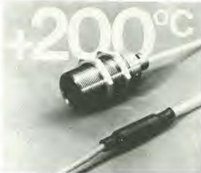
zionamento fino ad una temperatura ambiente di +200°C. L'amplificatore è invece montato in una custodia in materiale sintetico cilindrico praticamente integrato nel cavo di collegamento, potendo così operare fino ad una temperatura ambiente di +100°C.
