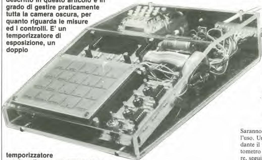
temporizzatore per lo sviluppo, un termometro, un fotometro ed un misuratore di contrasto. Il computer per camera oscura è basato sul ben noto microprocessore 6502 e su una tastiera capacitiva appositamente progettata per questa applicazione. La costruzione è relativamente facile, mentre il costo totale è molto inferiore rispetto ai sistemi commerciali equivalenti.
