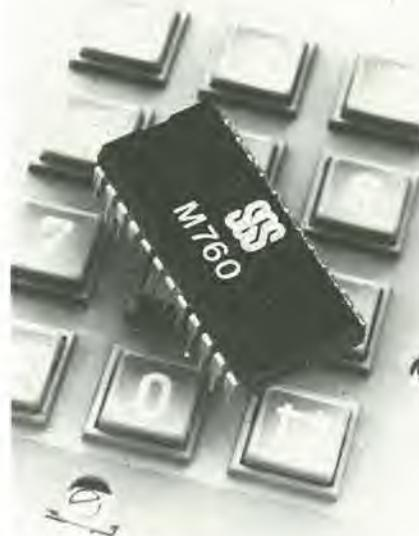
L'M760 è alimentato dalla linea e si collega direttamente con una semplice tastiera ad un solo contatto, generando serie lente di impulsi per sviluppare i dischi combinatori meccanici.
