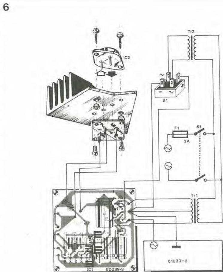
Figura 6. Schizzo costruttivo di una parte dell'alimentatore modificato.
