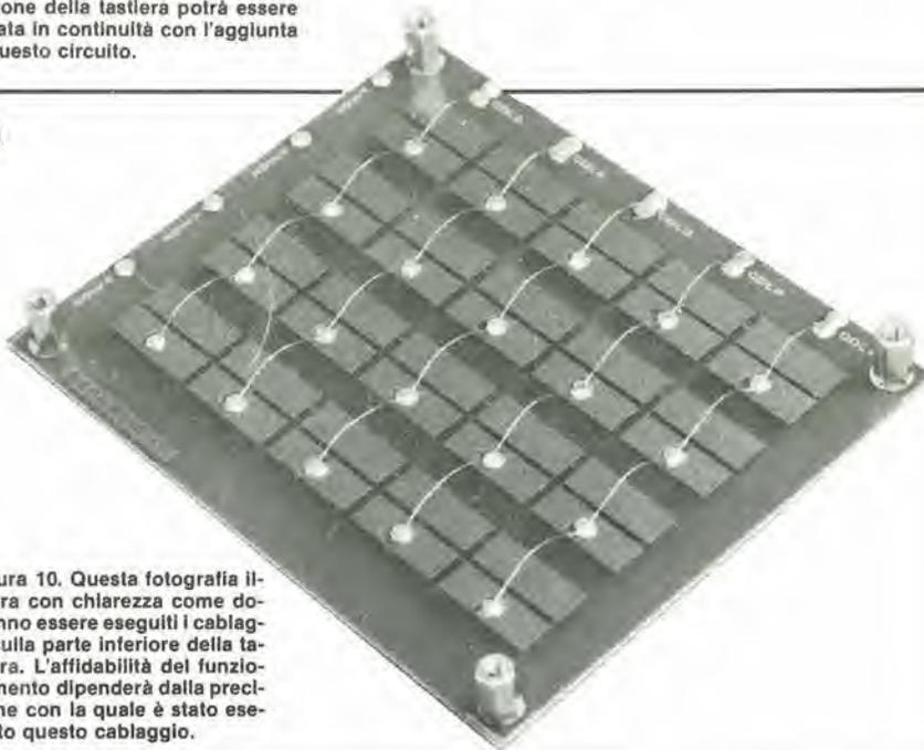
Figura 10. Questa fotografia illustra con chiarezza come dovranno essere eseguiti i cablaggi sulla parte inferiore della tastiera. L'affidabilità del funzionamento dipenderà dalla precisione con la quale è stato eseguito questo cablaggio.
