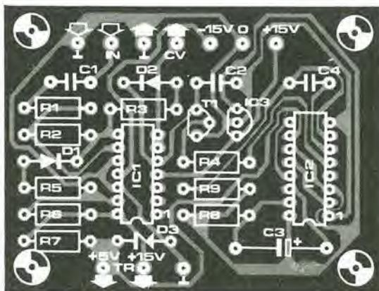
Figura 4. Suggestimento per la serigrafia del circuito stampato.
