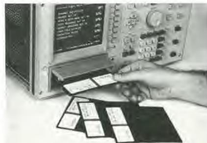
Inoltre l'HP 4145A è in grado di elaborare i dati di misura e di visualizzare parametri come hfe in funzione di IC e gm in funzione di VGS, permettendo così un'analisi veloce e completa delle caratteristiche cc di dispositivi a semiconduttori.
