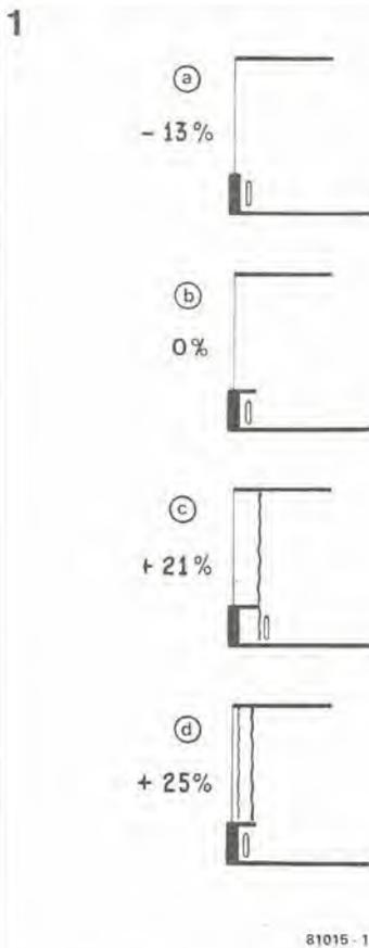
Figura 1. Come risparmiare calore usando tende davanti alle finestre. La figura 1b illustra la situazione normale, con la quale non si ha risparmio di calore.
