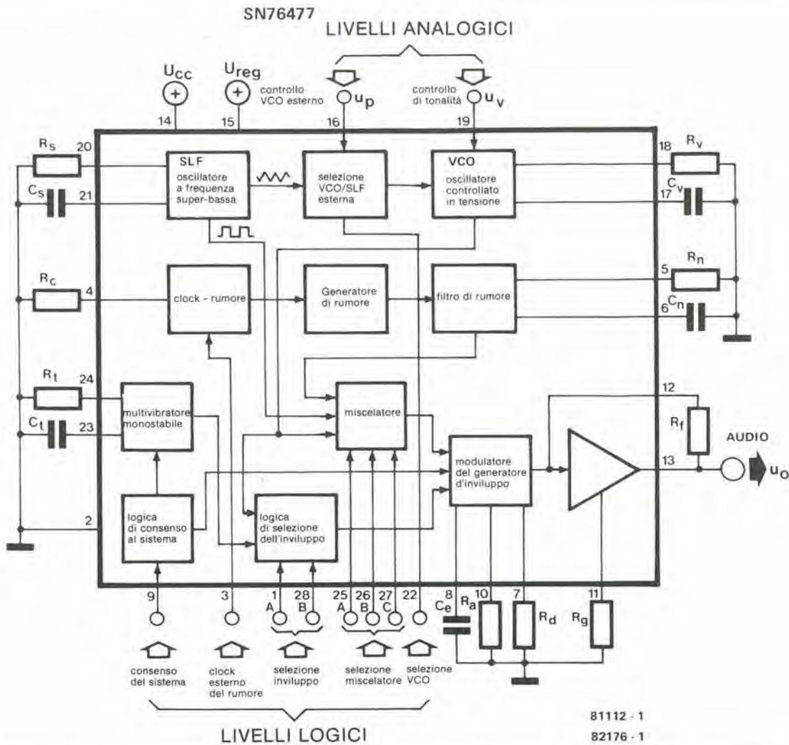
Figura 1. Schema a blocchi dei componenti interni del complicato circuito integrato del generatore di effetti sonori. I componenti fondamentali sono un oscillatore SLF, un VCO ed un generatore di rumore bianco casuale.
