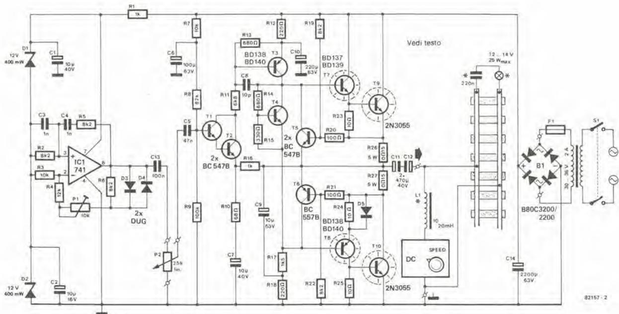
Figura 2. Lo schema del generatore di potenza ad onda sinusoidale consiste in un oscillatore a ponte di Wien basato su IC1. La brillantezza dell'illuminazione dell'interno dei vagoni sarà variabile con continuità mediante P2. Il condensatore di uscita deve essere del tipo bipolare, perché la tensione di binario potrà essere positiva o negativa (rispetto alla massa), a seconda della direzione di marcia del convoglio.
