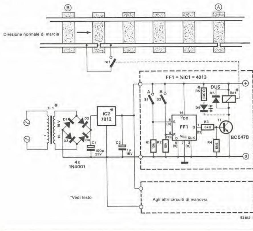
trollata del binario. Appena esso raggiunge il contatto B il flip flop è resettato e viene ripristinato lo stato originale. Un treno che viaggia nella direzione normale raggiunge per primo il contatto B provocando il "reset" del flip flop e garantendo il corretto funzionamento del segnale di stop.
