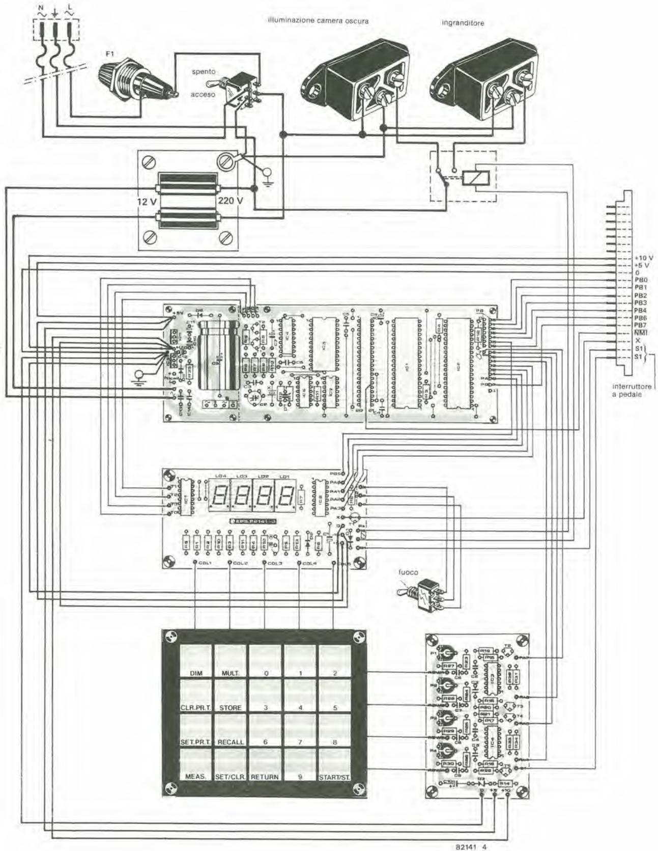
Figura 8. Le interconnessioni tra i diversi circuiti stampati sono visibili in questa figura. Occorre mantenere la reciproca disposizione tra l'interfaccia della tastiera, la scheda del display e la tastiera stessa, in modo da mantenere i cablaggi tra queste schede più corti possibile.
