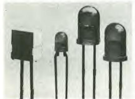
(Serie MV54XXX) con dimensioni 6,35 x 3,81 mm. I diodi rettangolari possono venire raggruppati sia in senso verticale che orizzontale con una distanza tra i terminali di 2,54 mm.
