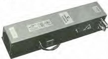
Il 3591 ha un guadagno di 50 dB a piena potenza, con una tensione del fascio di soli 10,5 KV.
