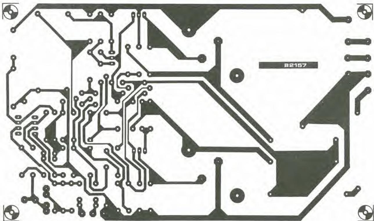
Figura 3. Circuito stampato del generatore di potenza. Tutti i componenti sono montati sulla basetta, tranne il trasformatore di rete, il fusibile e l'interruttore generale. Dato che i transistori di uscita sono montati sul circuito stampato e sono provvisti di dissipatori termici (vedi testo), il coperchio del mobiletto dovrà permettere un'adeguata ventilazione.
