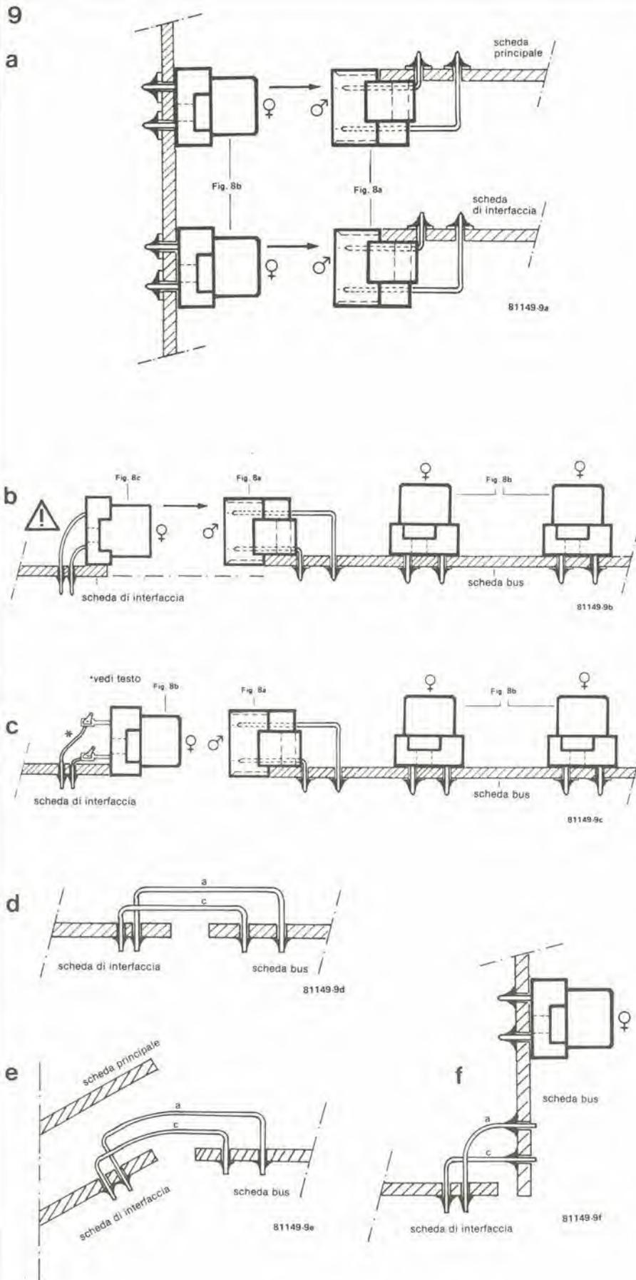
Figura 9. Schizzi dettagliati dei collegamenti elettrici tra la scheda principale e la scheda di interfaccia (9a) e tra la scheda di interfaccia e la scheda bus (9b, 9c e 9d).
