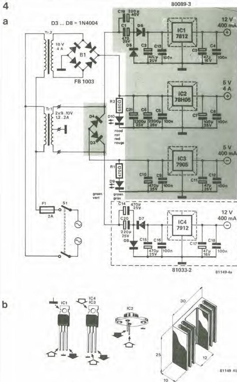
Figura 4. L'alimentatore "revisionato" (4a) ed alcuni suggerimenti per il montaggio pratico (4b).
