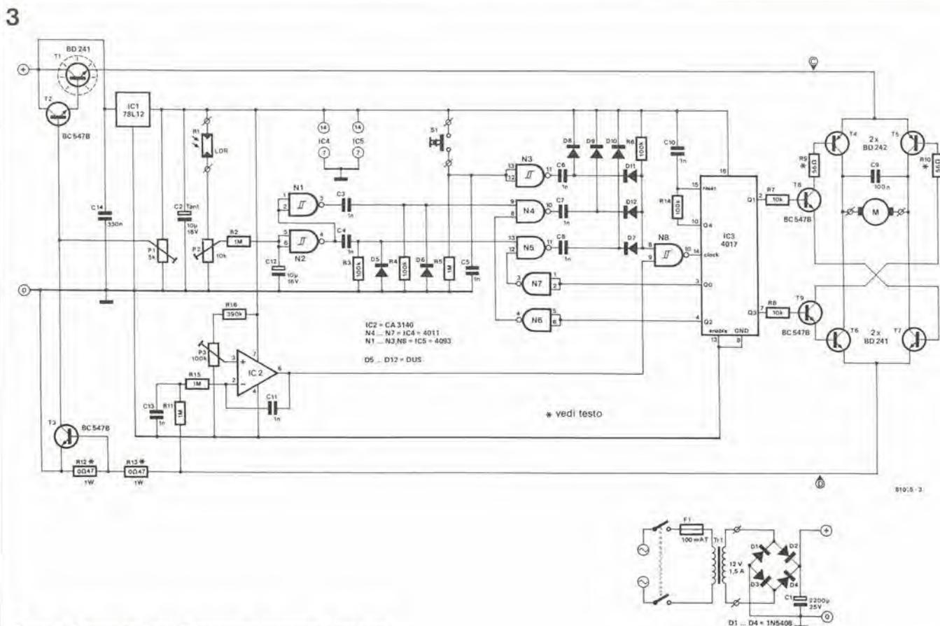
Figura 3. Schema elettrico del comando automatico per tende
