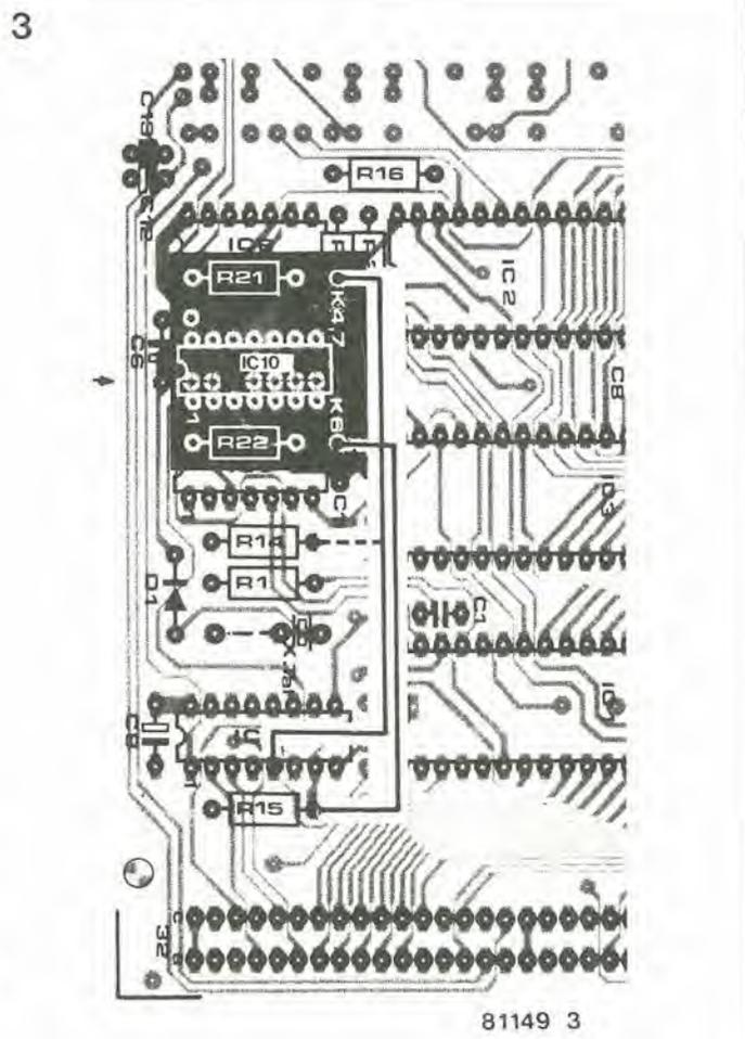
Figura 2. Il Junior Computer: prima (2a) e dopo (2b): Componenti elettronici da montare in qualche caso sulla scheda principale come alternativa alla possibilità di azionamento passo-passo.
