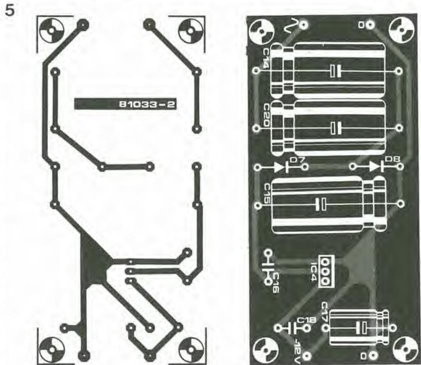
Figura 5. Circuito stampato dell'alimentatore a -12 V
