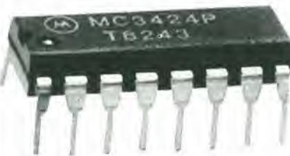
Ingressi digitali CMOS/TTL compatibili forniscono l'attivazione a distanza delle uscite di ciascun canale.
