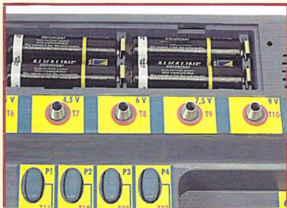
Dispõe-se de conexão de alimentação de até 9V em saltos de 1,5 volts.
