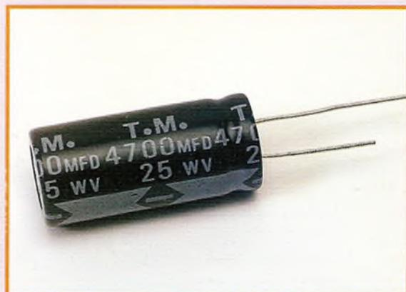
Deverá se assegurar que o capacitor não será conectado entre dois pontos do circuito, cuja tensão supere a máxima que o capacitor pode suportar.
